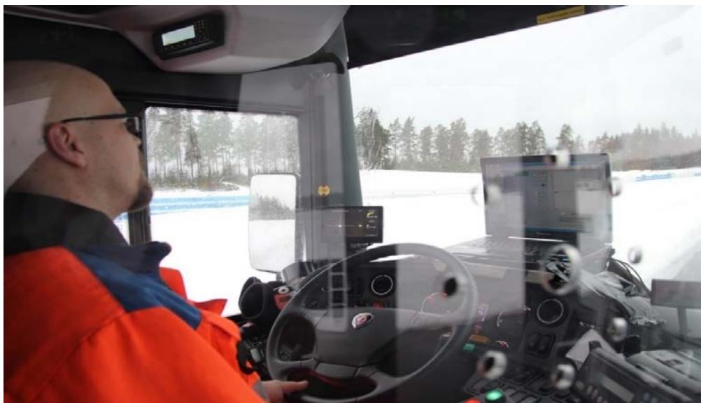
Figur 7. Illustrasjon av kjøring av dieselbuss på lukket bane der fører får informasjon om valg av kjøremønster og hastighet via PC.
