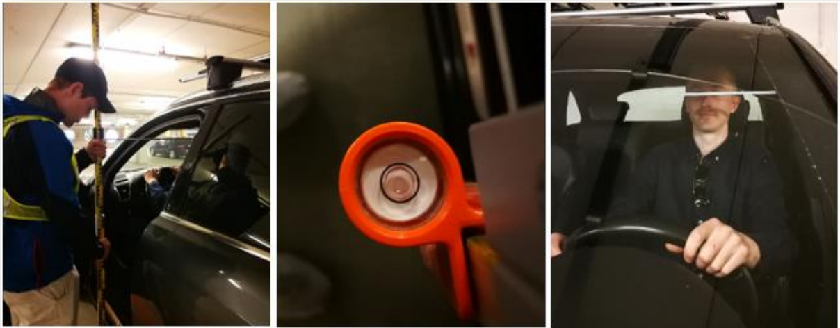
Figur 30: Viser faktisk målsituasjon med målestang helt opp til øyet med libellen i sentrum.
