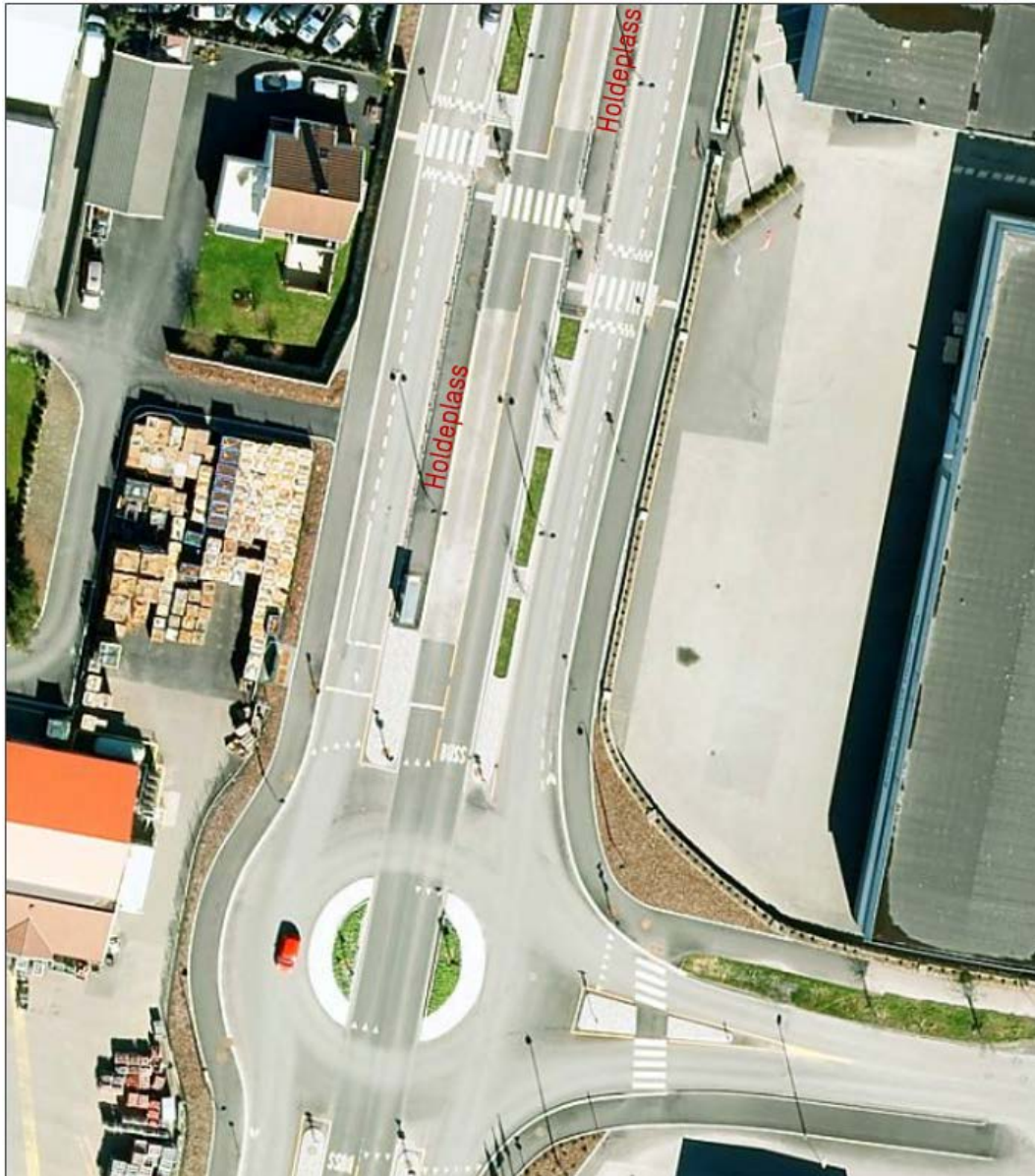
Figur 5 Eksempel på holdeplass på Forus i Stavanger. Det er holdeplasser på samme side av rundkjøringen. Gangfeltet er plassert mellom stoppestedene, dvs. kryssing skjer bak bussen.
