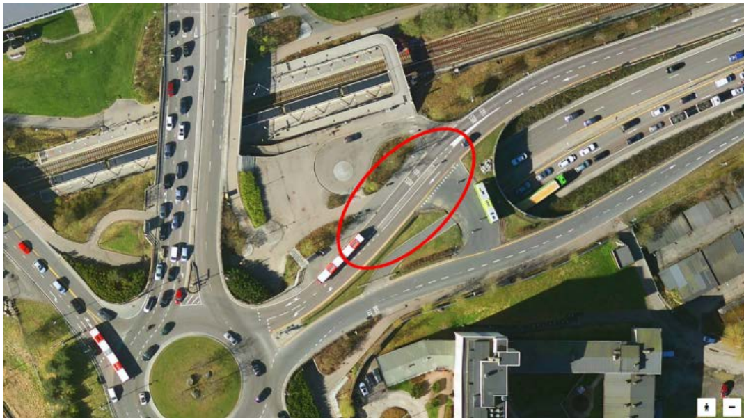
Bilde 3 Eksempel på kollektivfelt som avsluttes med refuge. Ryen i Oslo. Kartkilde: www.gulesider.no
