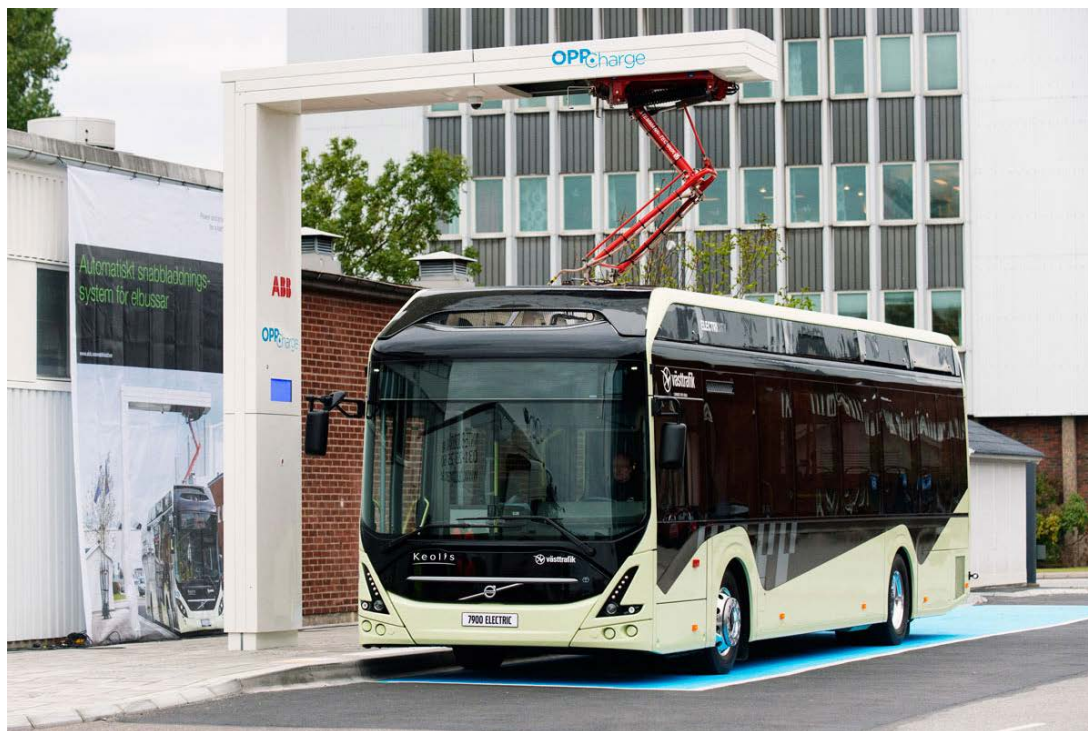
Figur 2. Lading av buss via invertert pantograf. (Foto: oppcharge.org)
