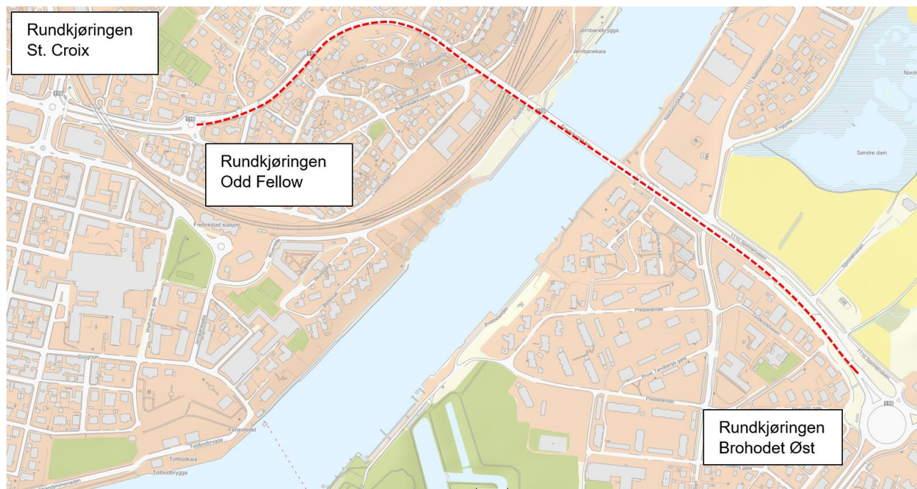
Figur 4-12: Strekning med tungtrafikkfelt rv. 110 i Fredrikstad (rød linje). Tungtrafikkfeltet omfatter høyre felt i østgående retning, mellom rundkjøringen Odd Fellow i vest og rundkjøringen Brohodet Øst i øst. Total lengde ca. 1300 m. I vestgående retning er det kun et ordinært kjørefelt uten restriksjoner. Kartgrunnlag: Norgeskart.
