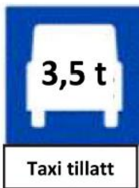
Figur 8-2: Skilt benyttet på rv. 110 i Fredrikstad. Skiltet angir at feltet kan benyttes av kjøretøy med tillatt totalvekt over 3,5 tonn og av taxi.
