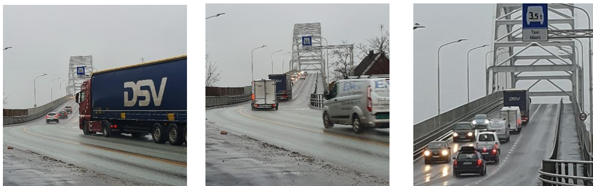
Figur 5-5: Tungt kjøretøy ligger i tungtrafikkfeltet i den krappe svingen før kjøretøyet skifter til ordinært kjørefelt over Fredrikstadbrua.
