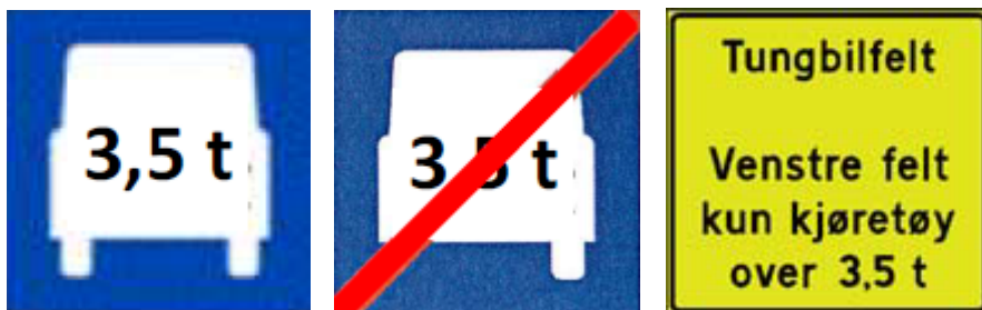
Figur 4-6: Skilt 506 (tungtrafikkfelt), skilt 507 (slutt på tungtrafikkfelt) og skilt 560 (opplysningsstavle).
