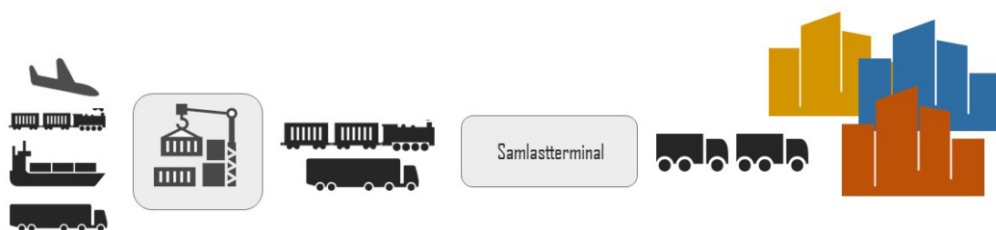
Figur 1.1. Prinsipp for varekjede for varedistribusjon, med samlasting for distribusjon i by. En samlastterminal kan være sentrallager, regionallager, godsterminal eller engroslager. (Kilde: Statens vegvesen).
