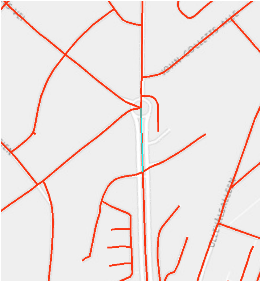
Figur 3.3 Eksempel på NVDB-nettverket ved John-Collets plass. Vi observerer at selve rundkjøringen, samt trikkesløyfen mangler. Den markerte lenken (i lyseblått) har to kjørefelt og 2 markerte sykkelfelt (1#2#3S#4S).
