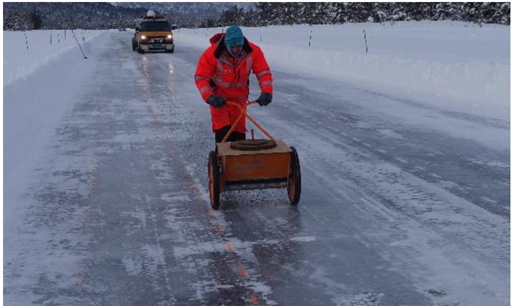
Figur 4: Feltutlegging med «trillebårspreader» fra Epoke i forbindelse med testen.
