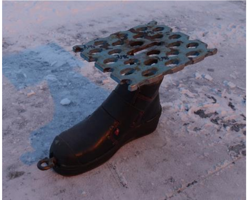
Figur 16: Forberedelse av sko til måling av gåfriksjon. Vekter ble lagt på «plattformen» (perforert stålet) ifbm felttestingen.
