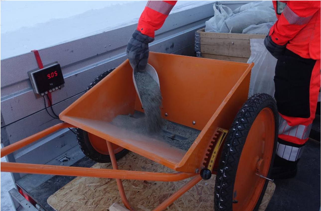
Figur 18: Ifylling av materiale med tilhørende veiing før feltutlegging. Strammespak (fjærbunn) med skala sees mellom hjul og materialkammer i nedre del av bildet.
