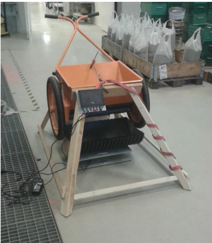
Figur 13: «Kalibrering» av strøvogn (utlagt mengde) for de ulike massetyper og fraksjoner på lab forut for feltforsøket.
