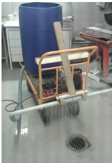
Figur 14: Vanningsutstyr (200 l fat og hullbom med veing(!)) for tilvirkning (simulering) av alternative føreforhold (våt is).
