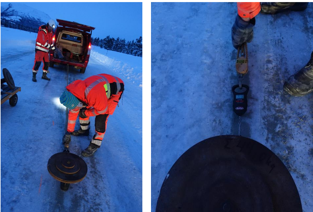
Figur 21: Sko påmontert vekt – forsøk på måling av «gåfriksjon» ved hjelp av digital fiskevekt og talje.
