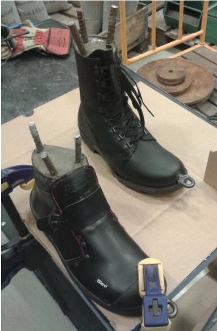
Figur 16: Forberedelse av sko til måling av gåfriksjon. Vekter ble lagt på «plattformen» (perforert stålet) ifbm felttestingen.
