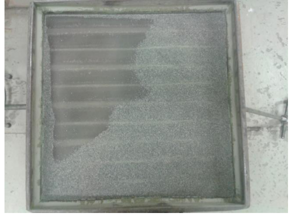
Figur 11: 0,50/1,0 mm på sikt etter sikting av 10 kg.
