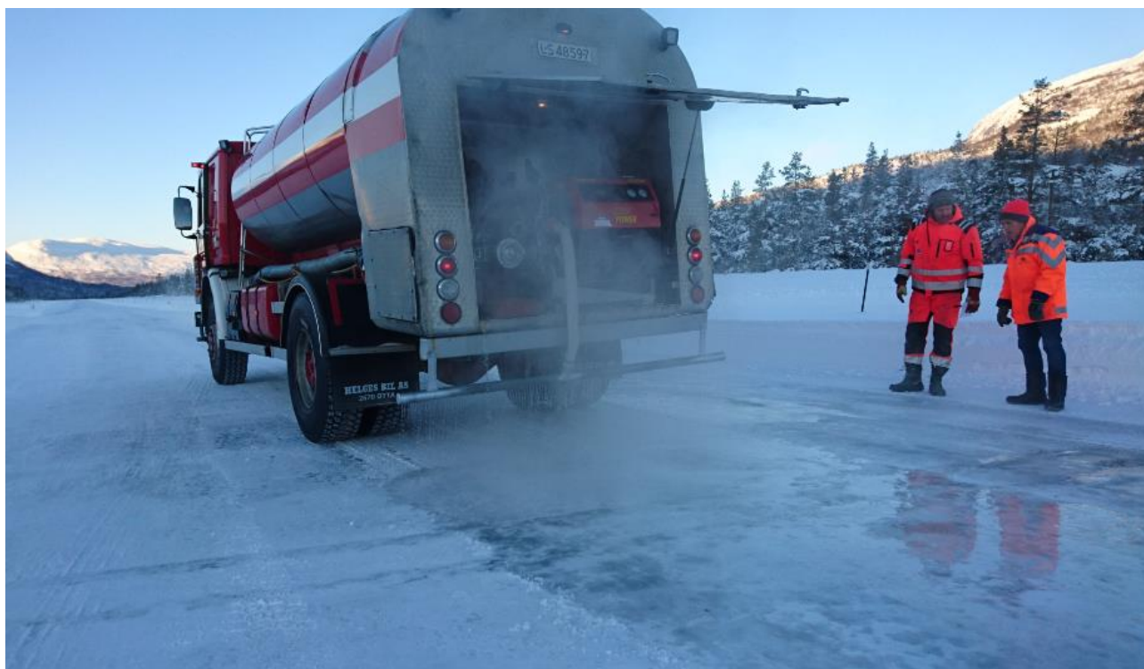
Figur 15: Vanningsutstyr (brannbil med hullbom) for preparering av bane og tilvirkning av alternative føreforhold.
