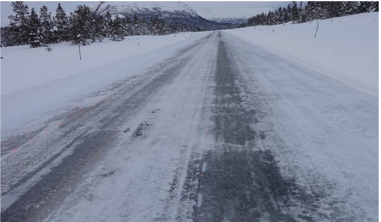
Figur 46: Få korn vs. mange å generere ett samlet friksjonstilskudd fra – felt 5 (0/4 mm Veblungsnes) til venstre og felt 15 (0,50/1,0 mm av 0/4 mm Vassfjell (fraksjonert)) til høyre.
