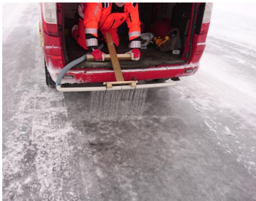
Figur 14: Vanningsutstyr (200 l fat og hullbom med veing(!)) for tilvirkning (simulering) av alternative føreforhold (våt is).
