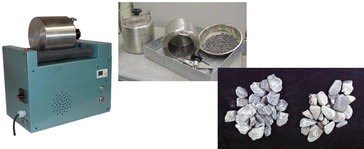
Figur 5.15 Micro-Deval sylinder med tilhørende stålkuler for testing av tilslagets motstand mot slitasje. Til høyre et eksempel på materiale før og etter testing.
