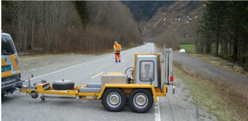
Figur 4.12 Fallodd – her måles bæreevnen over vegens tverrprofil (Foto: Statens vegvesen)
