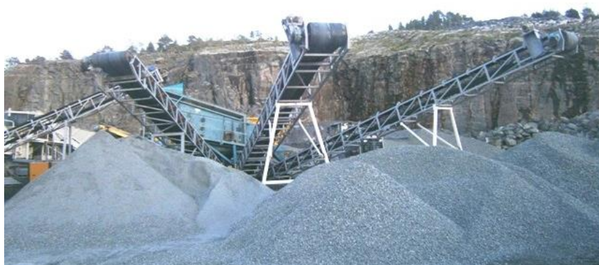
Figur 5.5 Full produksjonslinje med knusere og sorteringsverk
