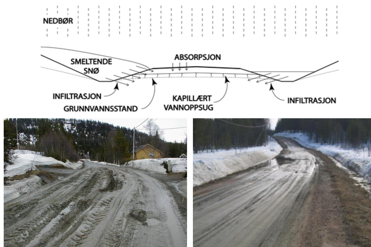
Figur 10.1 Vann på og i vegen kommer fra flere kilder (Ill.: Marit Fladvad, foto: Statens vegvesen/Roadex.org)
