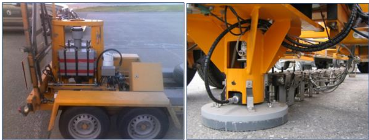
Figur 8.10 Falloddsutstyr; t.v. oversiktsbilde, t.h. belastningsplate og geofoner (Foto: Dagfin Gryteselv)
