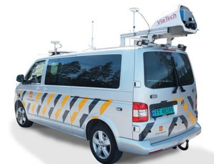
Figur 8.1 ViaPPS målebil for spor, tverrfall, jevnhet og vegbilder (Foto: ViaTech)
