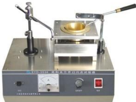
Figur 6.11 Utstyr for bestemmelse av flammepunkt (til venstre Cleveland open cup, til høyre Pensky Martens closed cup)
