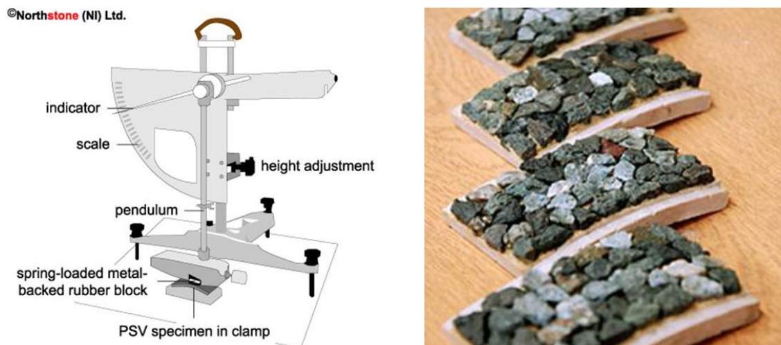
Figur 6.24 Utstyr for bestemmelse av PSV-verdi (Polished stone value tester), til høyre preparerte prøvestykker (Foto: Northstone)
