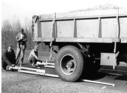
Figur 8.8 Benkelmansbjelke. Foto fra utprøving i USA i 1962 (t.v.) og måleprinsipp (t.h.)
