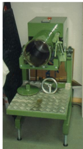
Figur 5.16 Kulemølle-maskin for testing av tilslagets motstand mot piggdekkslitasje
