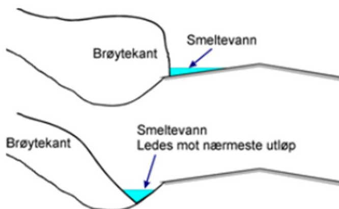
Figur 10.9 Brøytekanter fjernes for å gi avløp for smeltevannet (Ill.: Geir Berntsen)
