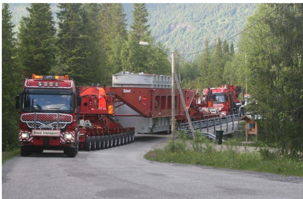
Figur 4.36 Eksempel på spesialtransport – en transformator på 407 tonn
