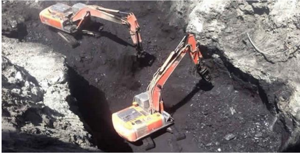
Figur 6.27 Uttak av naturasfalt (Foto: ATDM, Iran)
