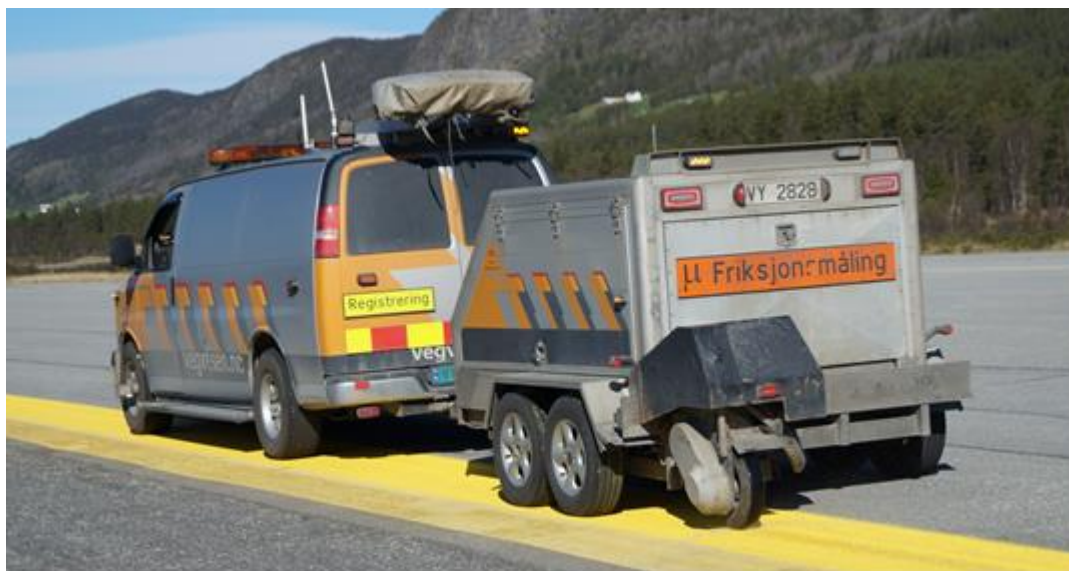
Figur 8.21 Friksjonsmåling med ROAR5 (Foto: Bård Nonstad)
