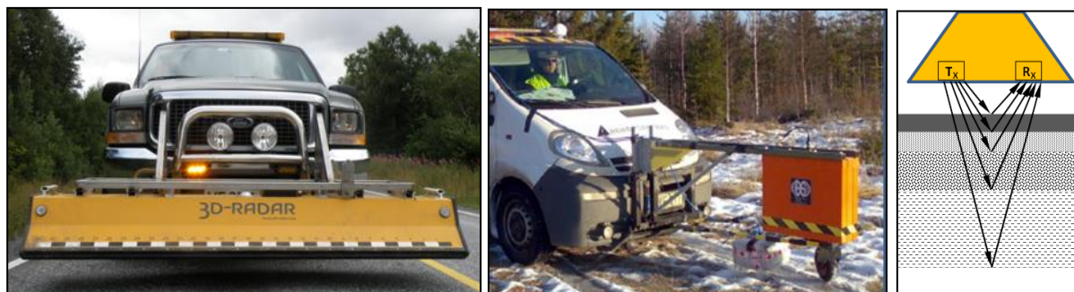
Figur 8.18 Georadar; ulike antenner og antenneplasseringer (Foto: SINTEF t.v., Statens vegvesen t.h.)
