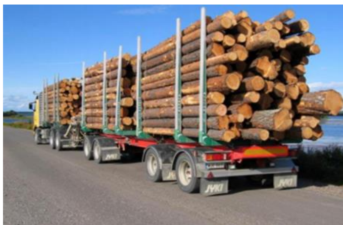
Figur 11.2 Med 7-akslede vogntog kan tunge biler tilpasse seg trafikk på 8 t veger, selv med 50 t totalvekt /8/
