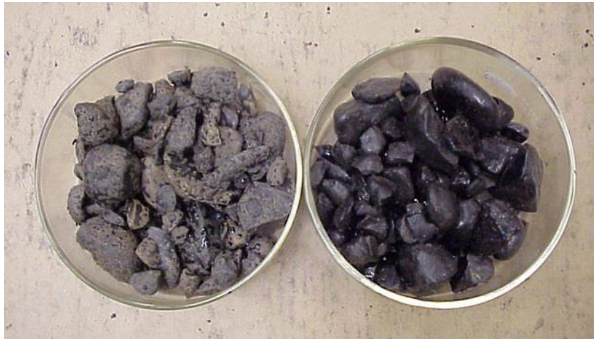
Figur 6.26 Effekt av vedheftsmiddel. Samme blanding mellom steintilslag og bindemiddel, men henholdsvis uten amin (venstre), og med amin (høyre) (Foto: Pavement interactive)
