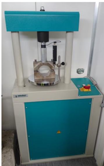
Figur 6.32 Marshall-presse; prinsippskisse (t.v.) og foto av utstyr (Foto: Veidekke Industri)
