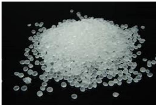
Figur 6.25 SBS-polymer for asfalt; pellets og prinsipp/virkemåte (Foto: Kraton)
