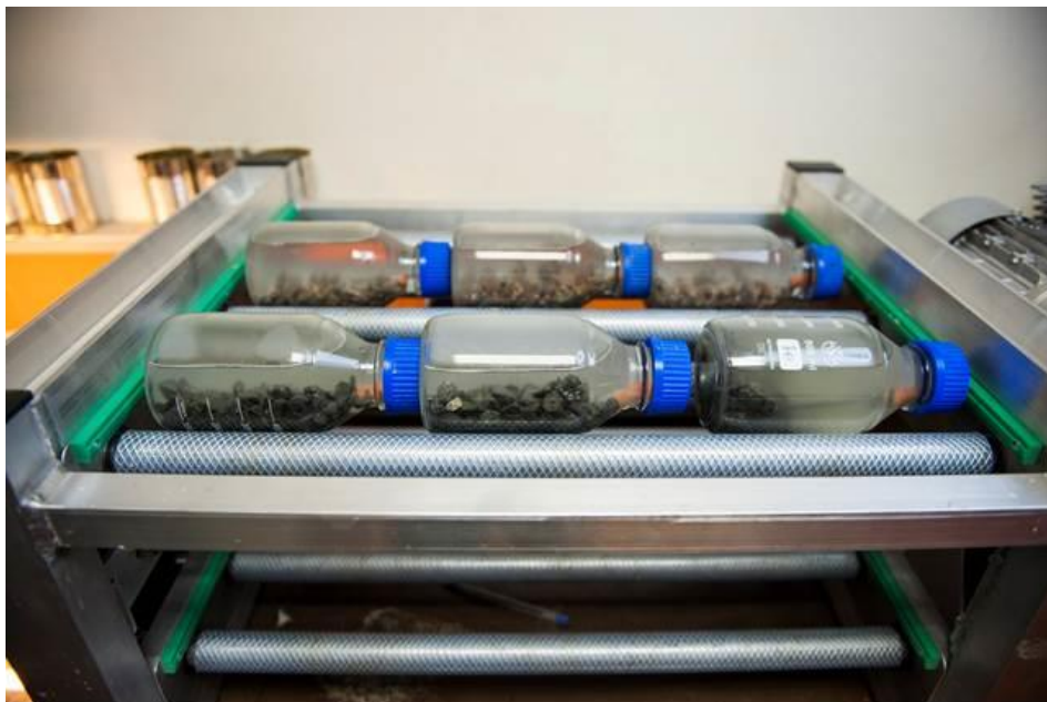
Figur 6.16 Rullebord med pågående rulleflaskeforsøk (Foto: Tomas Moss, icu.no)
