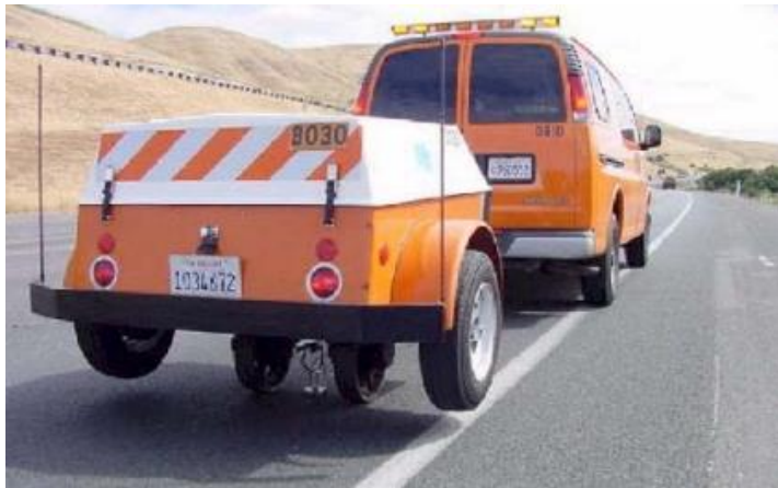
Figur 8.9 Dynaflect under måling på vegen (Foto: Statens vegvesen)
