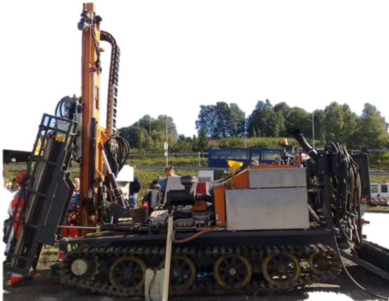
Figur 3.3 Grunnboringsrigg (Foto: Gunnar Winter, NTNU)
