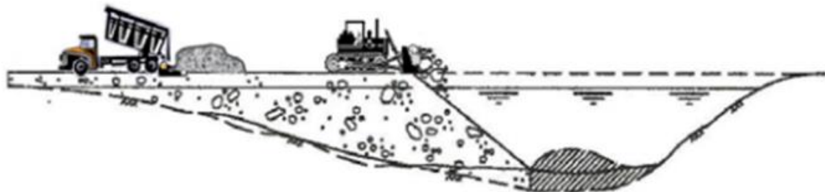
Figur 3.31 Utlegging av steinfylling med fortrenge av bløte masser /4/
