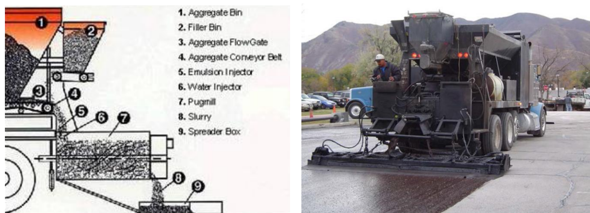
Figur 6.104 Utlegging av slamasfalt; prinsippskisse (t.v.) og bilde av utlegger (Foto: Missouri Petroleum)
