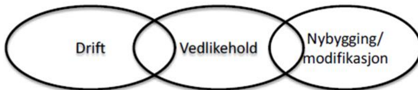
Figur 12.2 Grenseflater mellom drift, vedlikehold og oppgradering/modifikasjon/nybygging
