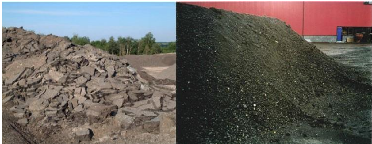
Figur 6.71 Oppsamling av gammel asfalt, enten i form av oppbrutt «flakmasse» (t.v.) eller fresemasse (t.h.) skal bare foregå på godkjente mellomlagre (Foto: Statens vegvesen)
