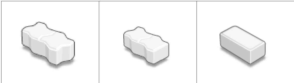
Figur 7.21 Låsestein (t.v.), delvis låsestein (midten), ikke låsestein (t.h.) /13/
