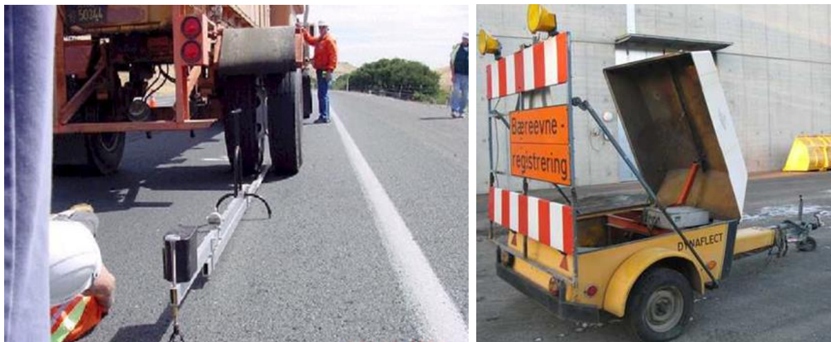
Figur 1.11 Benkelmansbjelke (t.v.) og Dynaflect (t.h.). Utstyret ble benyttet for å måle bæreevnen på vegene som en del av Norsk Vegplan på 1970- og 1980-tallet;
