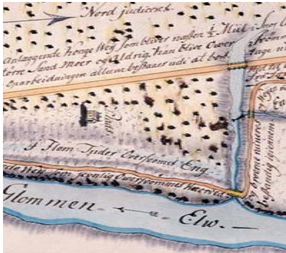
Figur 1.6 Det franske prinsipp – rette veglinjer. Til høyre et parti fra den Trondhjemske Kongeveg mellom Christiania og Minnesund, som ble anlagt 1770-1800 /4/
