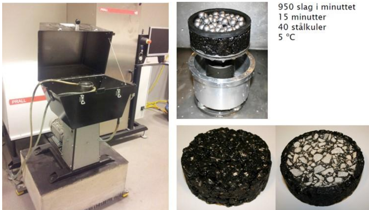
Figur 6.39 Prall-apparat for slitasjetesting av asfalt. Nederst prøveklosser før og etter forsøk (Foto: Statens vegvesen)
