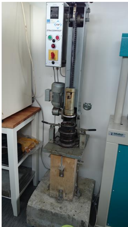
Figur 6.31 Apparat for komprimering av Marshall-prøver. Ferdig tillagede Marshall-klosser har typisk dimensjon d = 10 cm, h = 6 cm (Foto: Veidekke Industri)
