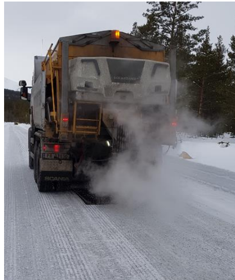
Figur 9: Bil med Polarmatic-/Falköpingspreder (varmsand – steinmateriale varmes vha. avgassen fra forbrenning av diesel).
