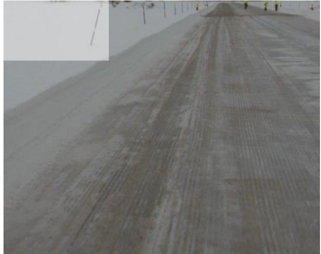
Figur 24: Varmsand Polarmatic flystripe (med 0/4 mm Evje). Bilde tatt ifbm friksjonsmåling på morgenen dagen etter feltutlegging.
