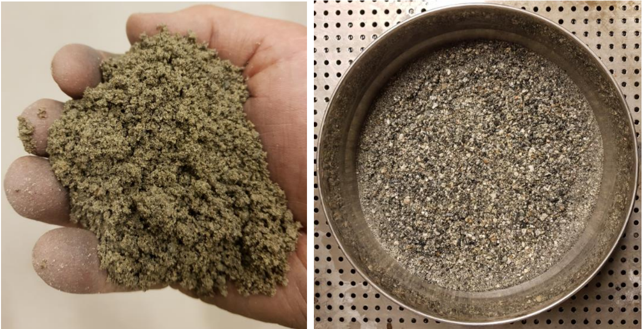
Figur 18: Fastsandmateriale – «Lora» 0/4 mm knust natur. Prøve etter vasking (før sikting) på bildet til høyre.
