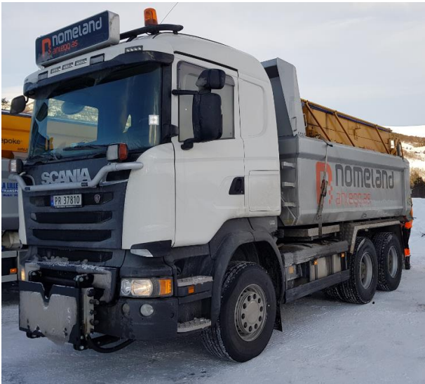
Figur 9: Bil med Polarmatic-/Falköpingspreder (varmsand – steinmateriale varmes vha. avgassen fra forbrenning av diesel).
