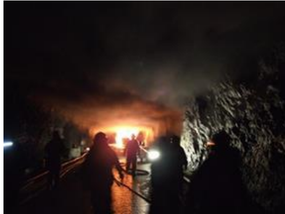
Figur 5: Brannforsøk i Runehamartunnel
