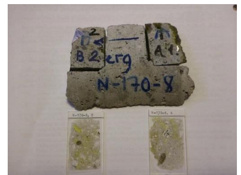
Betongprøve og tynnslip fra Nesttunnelen, Foto Arnhild Fjose, Statens vegvesen
