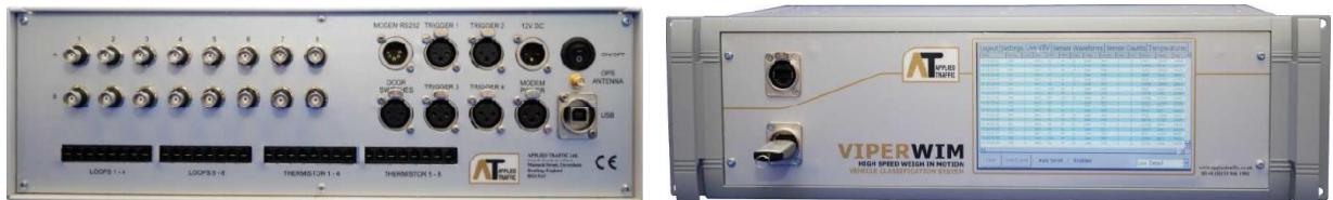
Figur 3 ViperWIM datalogger, forside og bakside
