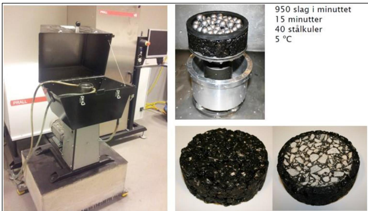
Figur 19 Prall-apparat for slitasjetesting av asfalt. Neders prøveklusser før og etter forsøk (foto Statens vegvesen)
