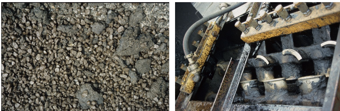
Bilde a) agglomer i massen ved produksjon i Lucksta-verk, b) utforming av mikselabber i IDECON-blanderen
