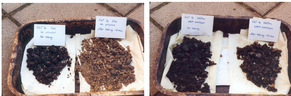
Bilde a) masse med dårlig vedheft og b) masse med normal vedheft ved koketest
