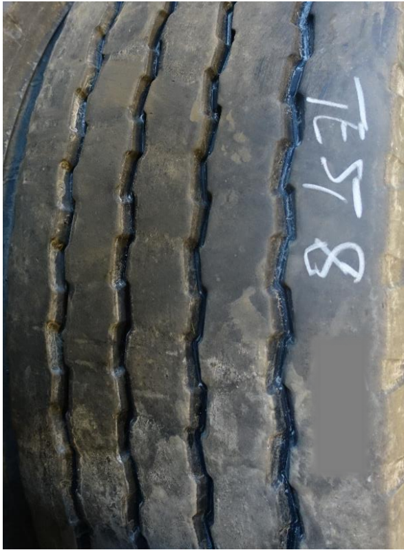
Dag 1 – kombinasjon nr. 10. Rullemønster styr, knast-/rullemønster (grovlamellert) driv. «Halvslitte» u/seip.
