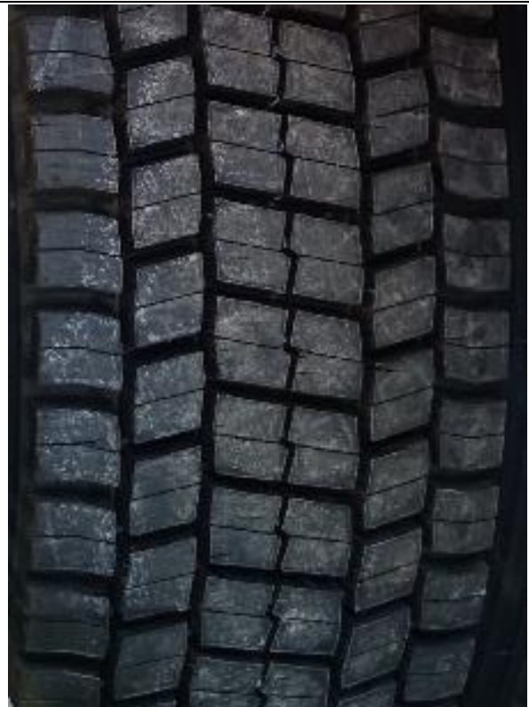
Dag 2 – kombinasjon nr. 3. Rullemønster styr, knastmønster (grovlamellert) driv. Halvslitte styr, nye/ubrukte m/seip driv.
