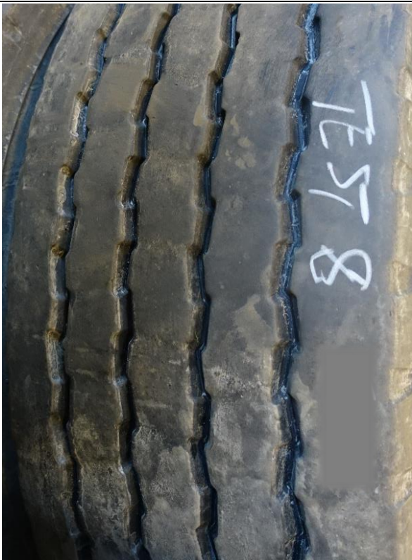
Dag 2 – kombinasjon nr. 3. Rullemønster styr, knastmønster (grovlamellert) driv. Halvslitte styr, nye/ubrukte m/seip driv.
