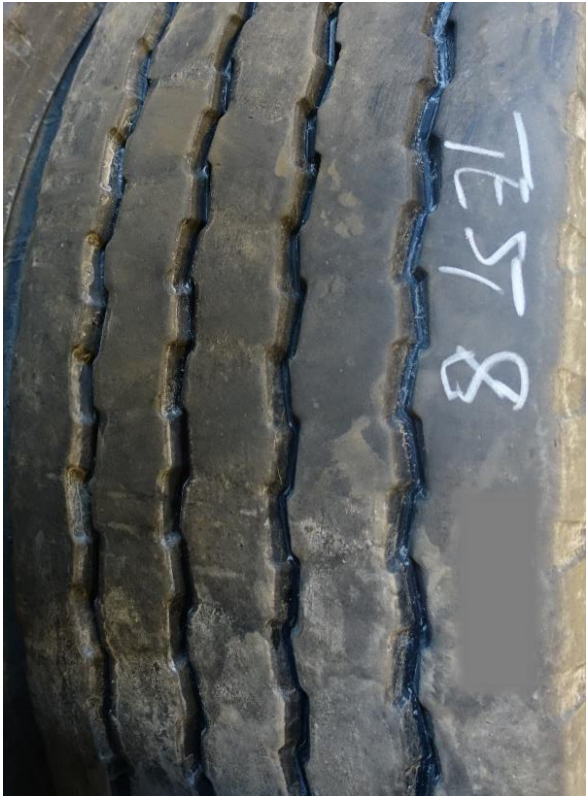
Dag 2 – kombinasjon nr. 2. Rullemønster styr, knastmønster (grovlamellert) driv. Halvslitte styr, nye/ubrukte u/seip driv.
