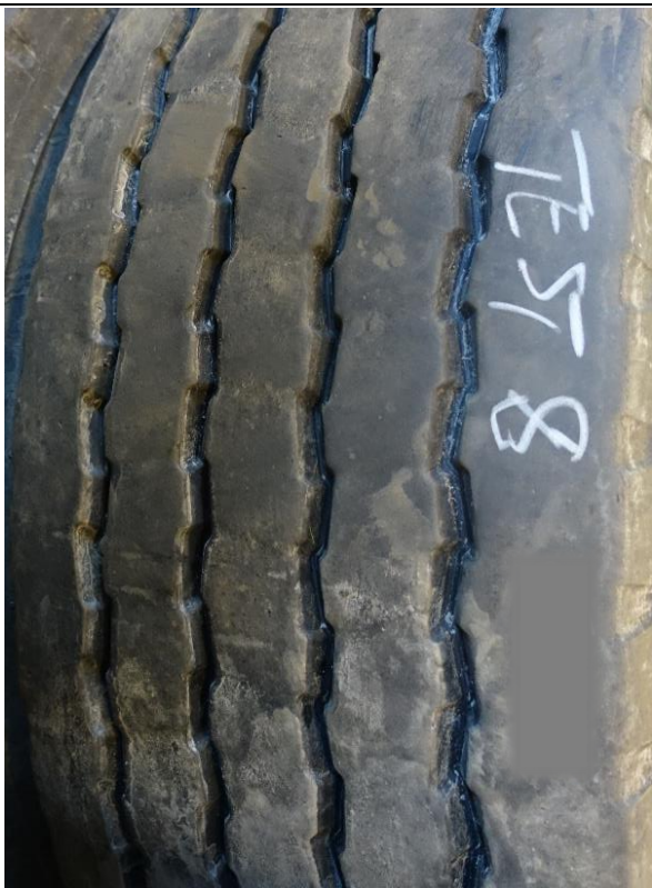
Dag 2 – kombinasjon nr. 1. Rullemønster styr, nordisk vintermønster driv. Halvslitte styr, nye/ubrukte m/seip* driv.
