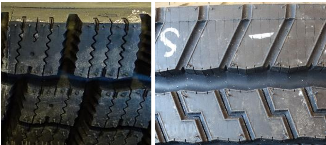
Figur 2: «Fabrikkseip» (t.v.) vs. «leverandørseip» (utført av dekkforhandler - «after market seip»).
