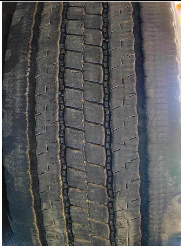
Dag 1 – kombinasjon nr. 7. Knast-/rullemønster styr, knastmønster (grovlamellert) driv. «Halvslitte» m/seip styr og driv.
