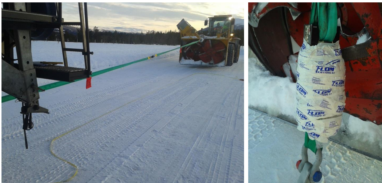
Figur 13: Hjullaster tilkoblet bil i forbindelse med fremkommelighetstestingen. Kraftcelle med loggerenhet til høyre.
