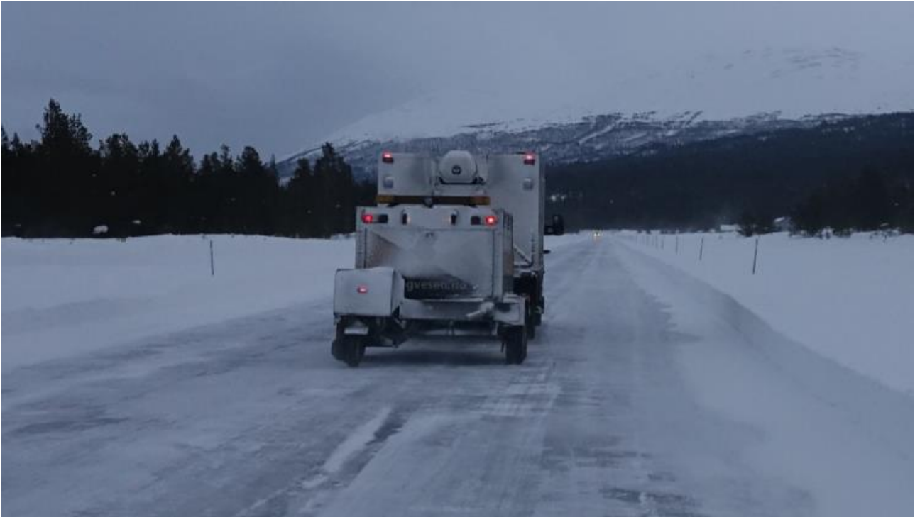
Figur 16: Friksjonsmåling på Bjorli Flyplass med RoAR Mark 5. Måleren på bildet tilhører Region vest og er tatt ved en annen anledning (Foto: Bård Nonstad).
