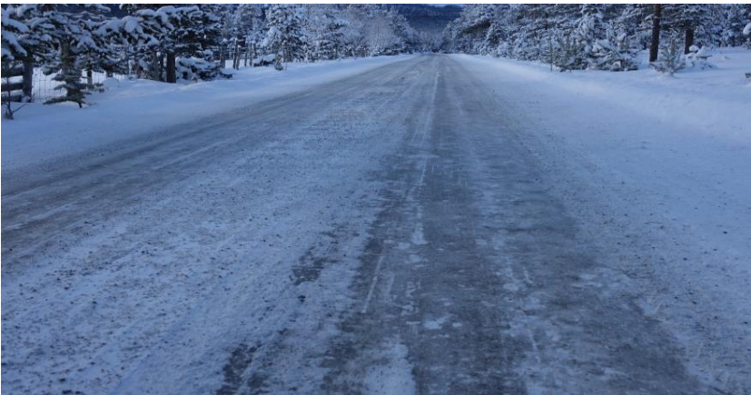
Figur 53: Strekning 6, dag 2. Ingen sand igjen i hjulsporene.
