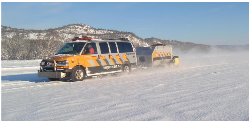
Figur 9: Friksjonsmåler Roar Mark 5 i aksjon.
