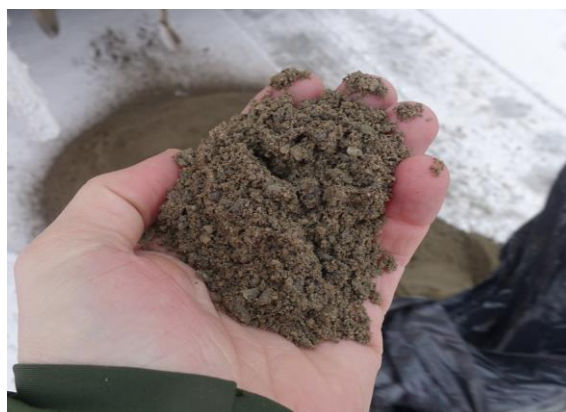
Figur 34: Bingsa, knust natur 0/4 mm.
