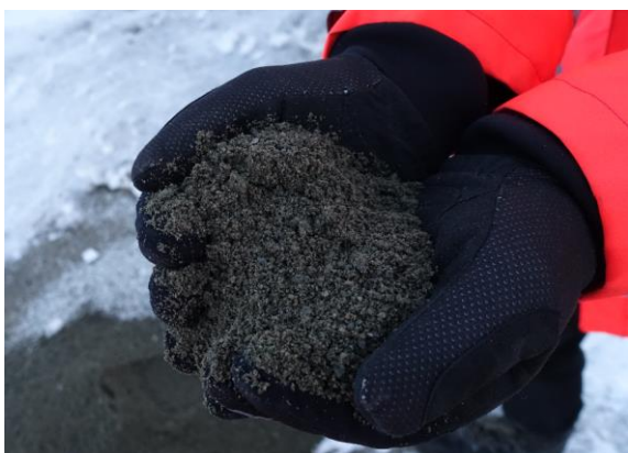
Figur 33: Kårbøseter, Knust natur 0/4 mm.
