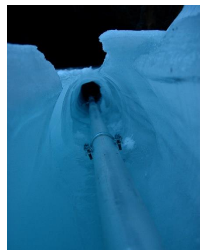
Figur 15. Her har IGS-røret tint isen nærmest røret, siden har smeltevannet gjort åpningen større. Foto HeatWork
