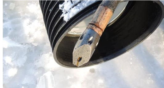
Figur 17. Eksempel på dyse for isskjæring. Foto KM Reitan
