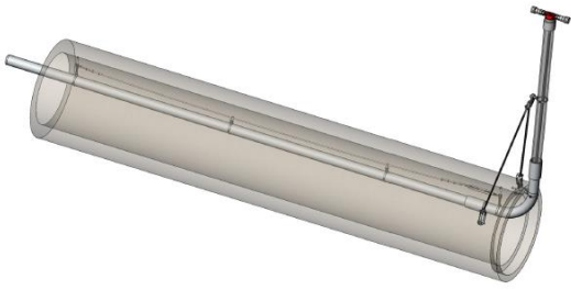
Figur 6. Prinsippskisse av IGS monterert i stikkrenne. Foto HeatWork
