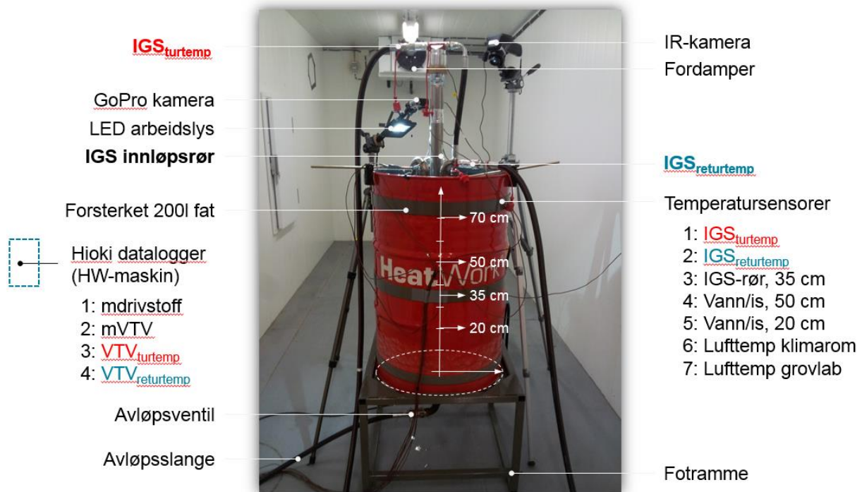
Figur 2.4.1 Måleoppstilling i klimarom II med målekar (rødt 200 l fat) med et innløpsrør montert loddrett i midten av karet. De tre nederste dybdeanvisningene på fatet angir plasseringen av temperatursensorene i is/vann og på røret, mens den øverste angir vannstanden i forkant av innfrysning.
