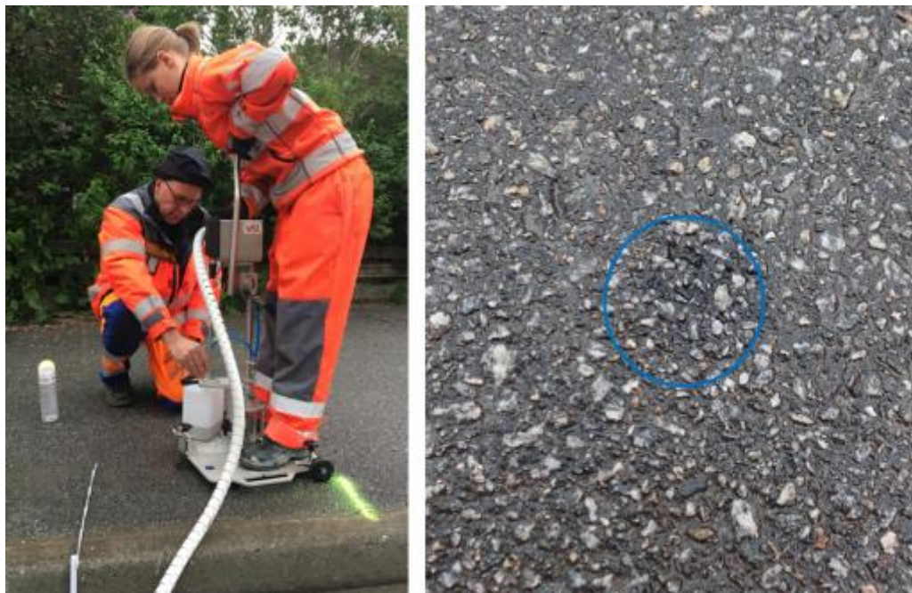
Figur 21: WDS måling på fortau i ca. 40 cm avstand fra kantsteinen (Foto: Brynhild Snilsberg og Dagfin Gryteselv)
