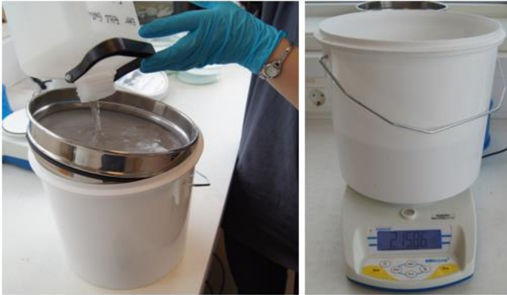
Figur 29: Sikting på 180 µm og veiing (Foto: Ida Ulvik Rønningen og Inga-Loise Sætermo Veivåg)
