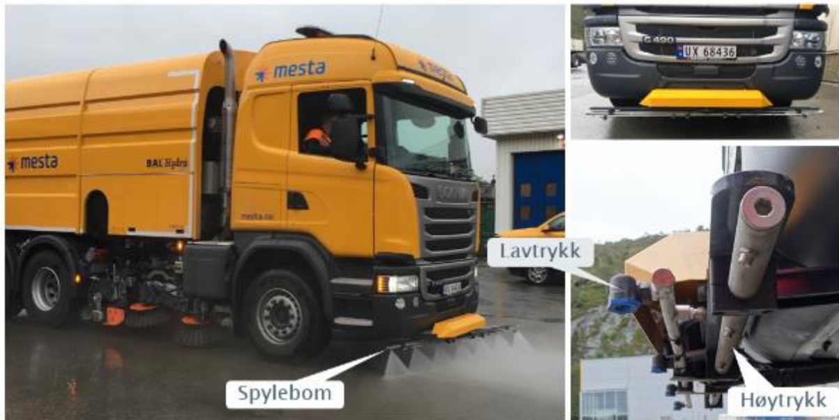
Figur 6: Spylebom foran på bilen (Foto: Brynhild Snilsberg og Dagfin Gryteselv)
