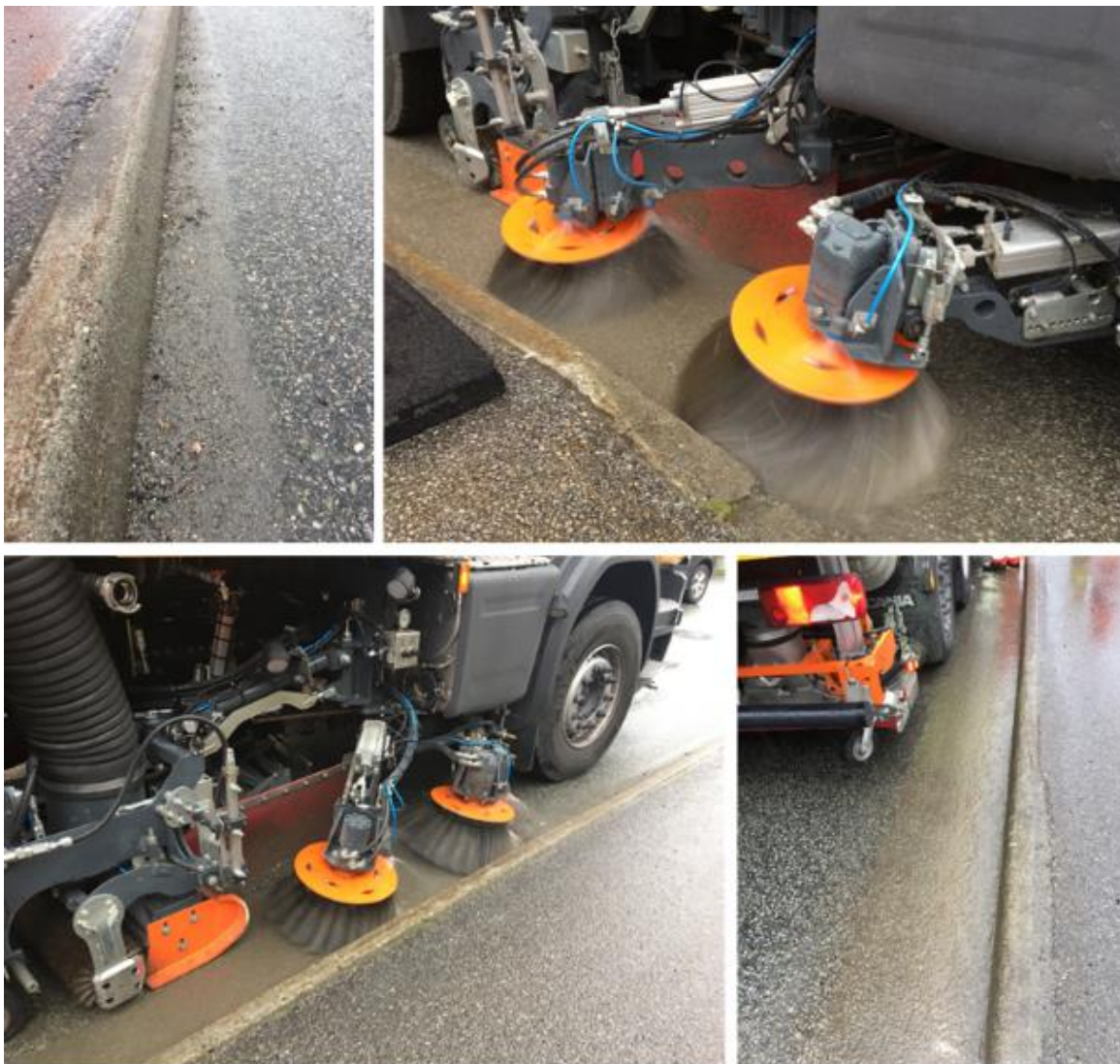
Figur 13: Pga. mye vegstøv langs kantsteinen før rengjøring ble det i alle felt kjørt et drag med koster og oppsug før forsøkene startet i gate (Foto: Brynhild Snilsberg)
