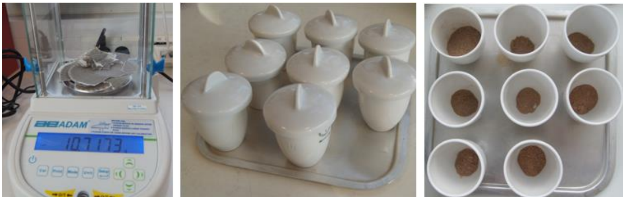
Figur 31: Veiging og gløding av filterpapir (Foto: Inga-Loise Sætermo Veivåg)
