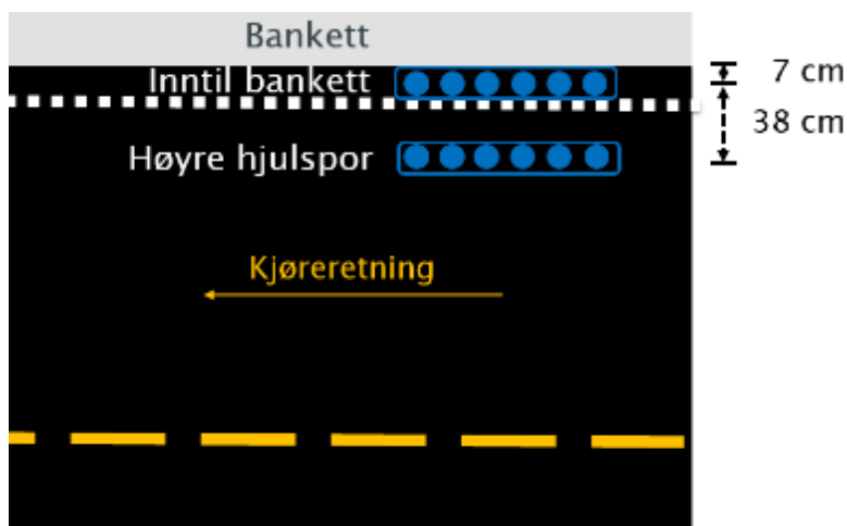
Figur 24: WDS måling i Freifjordtunnelen. En prøveflaske besto av 6 «skudd» (blå sirkler).
