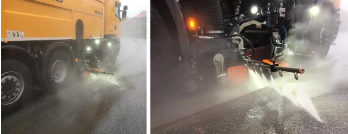
Figur 14: Drag 1, felt 2: Spylebom, koster og oppsug i gate (Foto: Brynhild Snilsberg)
