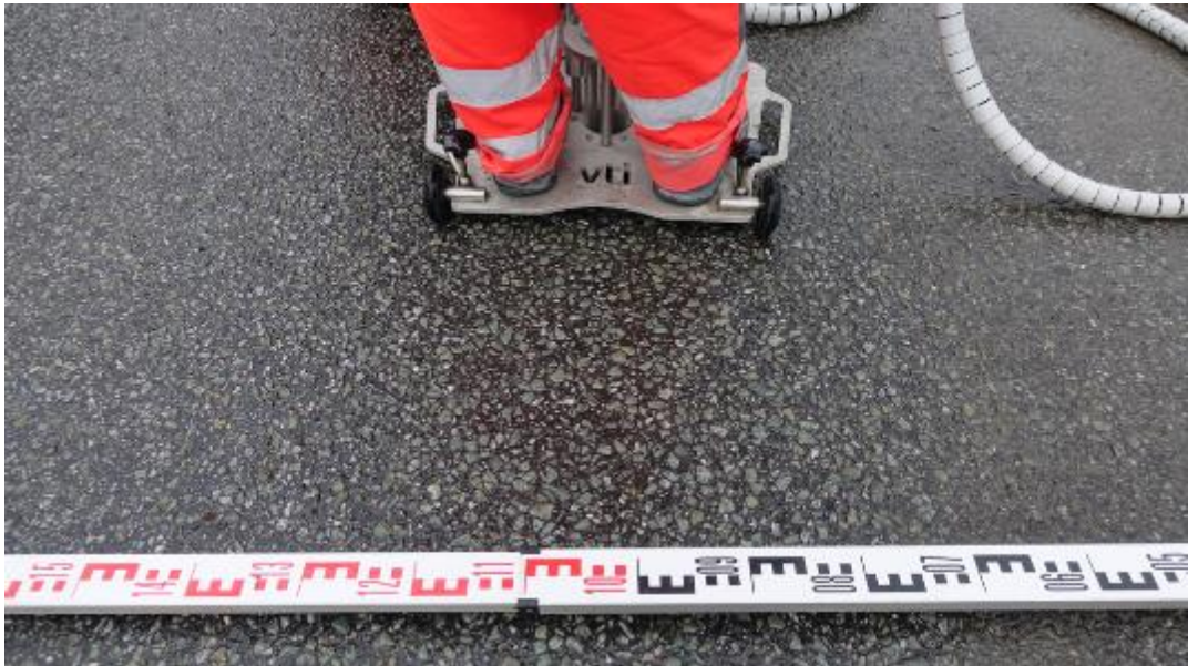
Figur 23: WDS måling høyre hjulspor i ca. 100 cm avstand fra kantsteinen (Foto: Dagfin Gryteselv)
