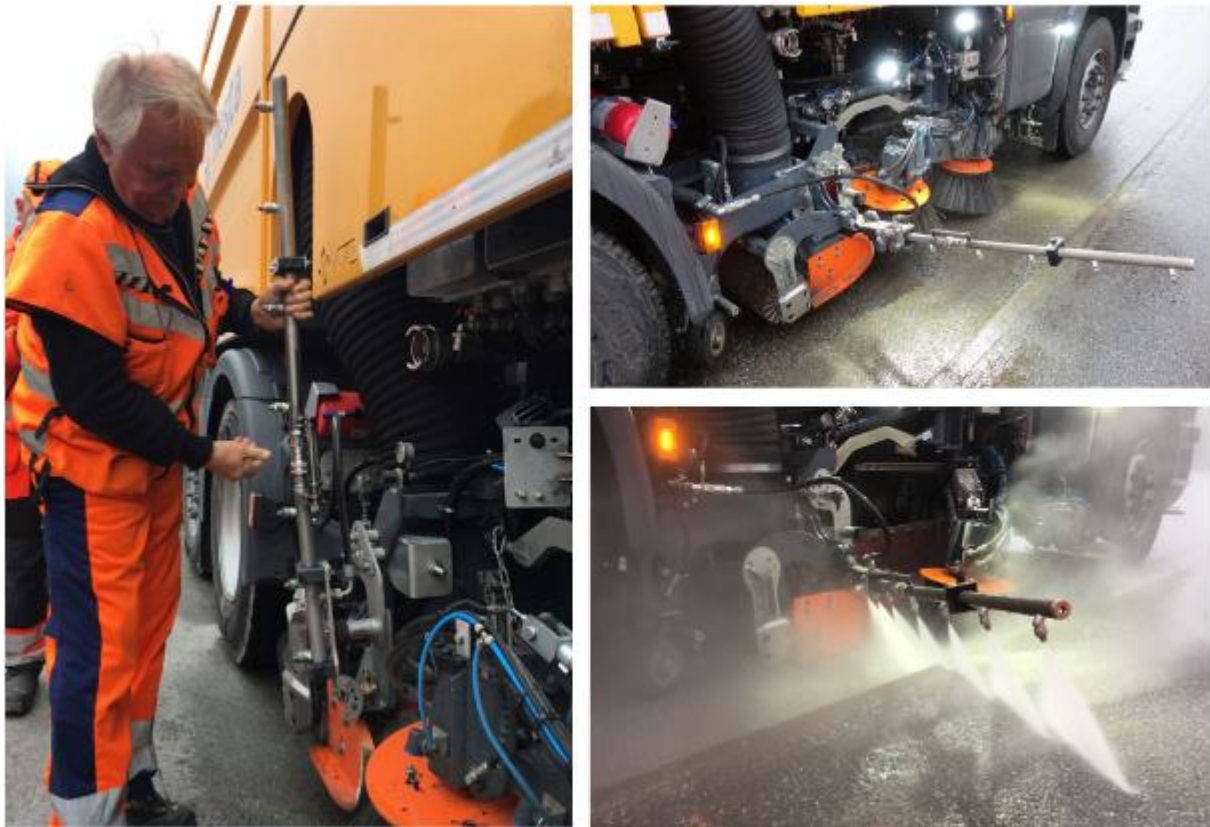
Figur 10: Spylebom med 7 høytrykksdyser (3 faste og 4 ekstra på en forlenger) på høyre side av feiebilen (Foto: Brynhild Snilsberg og Dagfin Gryteselv)
