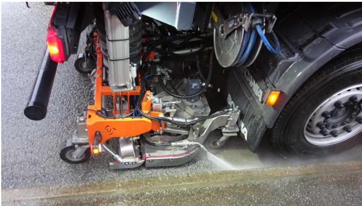
Figur 15: Drag 2, felt 1 og 2: Rotorclean og spyledyse mot kantstein i gate (Foto: Dagfin Gryteselv)
