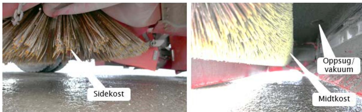
Figur 73: Innkapslet sidekost (venstre bilde) og midtkost med oppsug (høyre bilde) (Foto: Brynhild Snilsberg)
