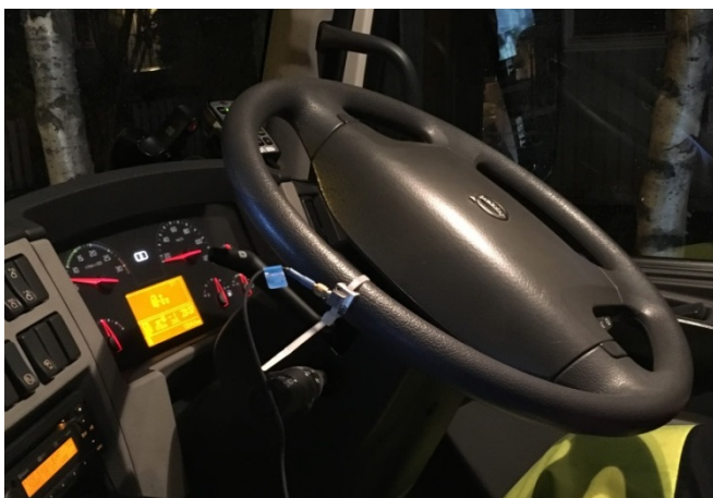
Figur 20: Montering av akselerometer på ratt (Foto: Åse Dalseth Austigard)
