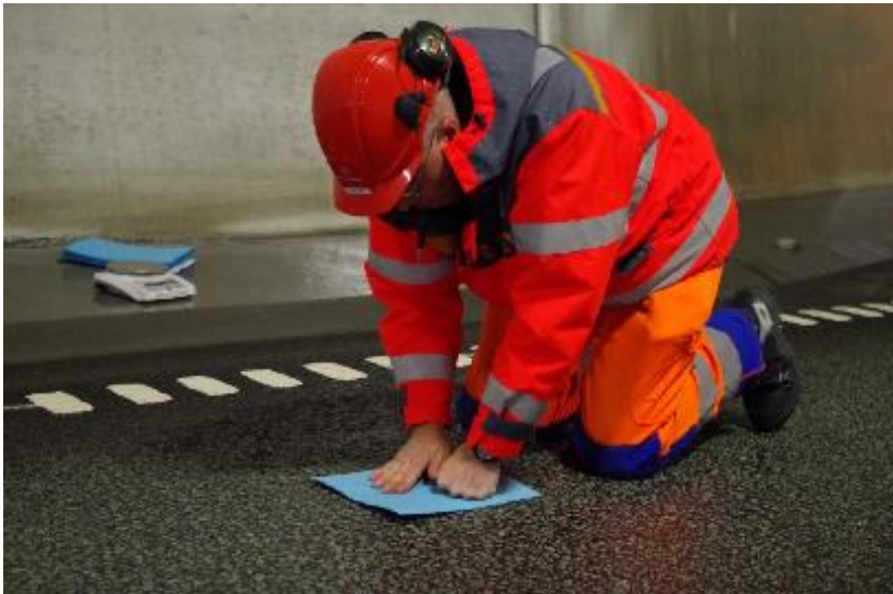
Figur 22: Måling av restfukt på vegbanen (Foto: Brynhild Snilsberg)
