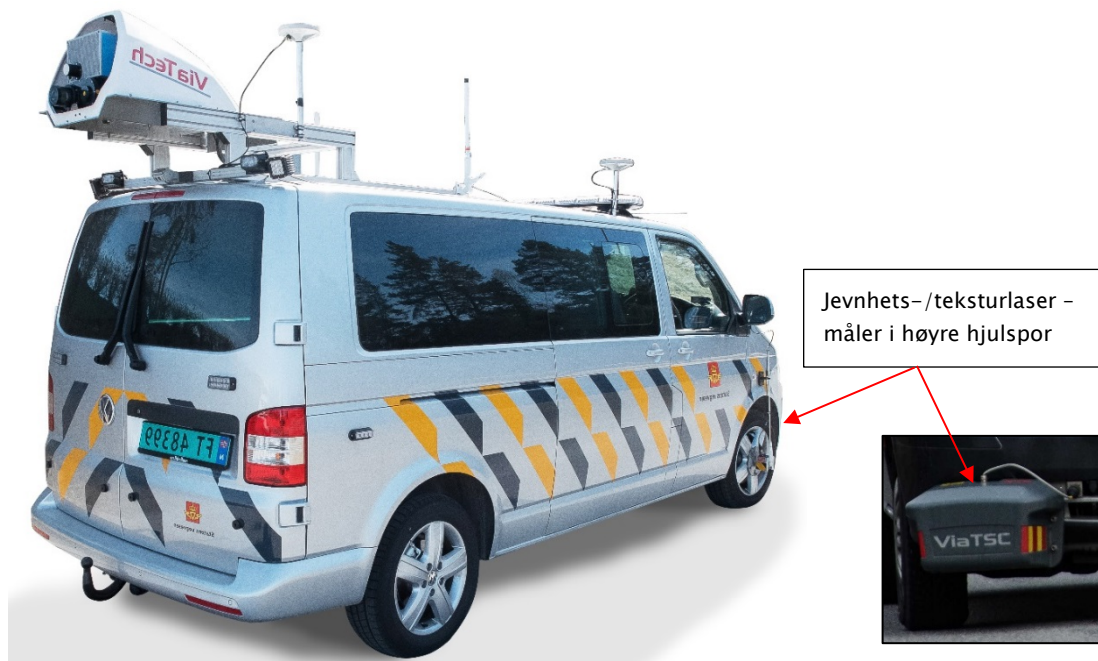
Figur 23: ViaPPS målebil for spor, jevnhet, tverrfall og vegbilder. Jevnhets-/teksturlaser innfelt (Foto: Kjetil Pedersen Mo/Sigurd Skjelmo)
