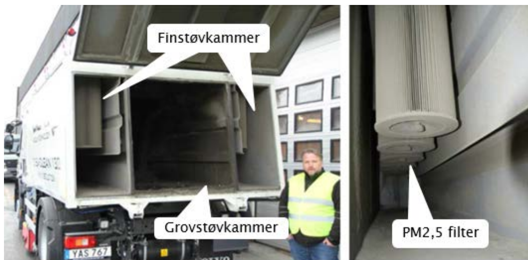
Figur 74: Tank for oppsamling av grovt og fint støv (Foto: Brynhild Snilsberg)
