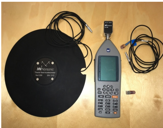
Figur 19: Vibrasjonsmåleren med sensorer som ble benyttet. Den svarte disken plasseres i setet slik at pilen for "x" peker rett frem (Foto: Åse Dalseth Austigard)
