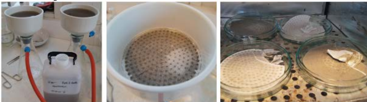
Figur 62: Filtrering og tørking av filterpapir (Foto: Inga-Loise Sætermo Veivåg)
