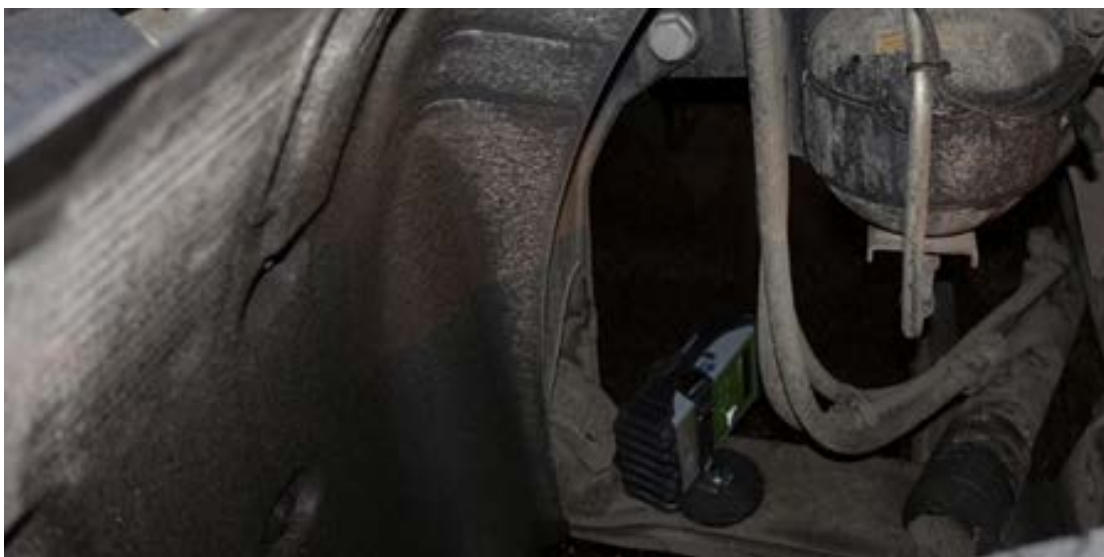
Figur 17: Maskin 6 ValAir, støvmåler montert under bilen siden utluftkanalen er midt under bilen (Foto: Thomas Hauan Lamo)
