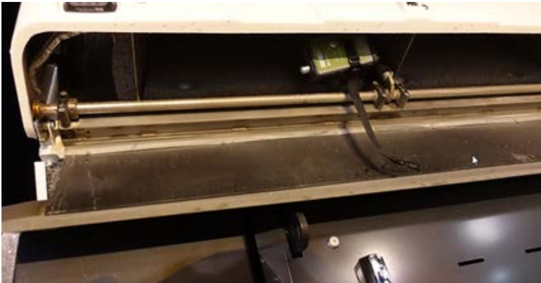
Figur 15: Maskin 2 Johnston C401, støvmåler montert i maskinens utluft (Foto: Thomas Hauan Lamo)
