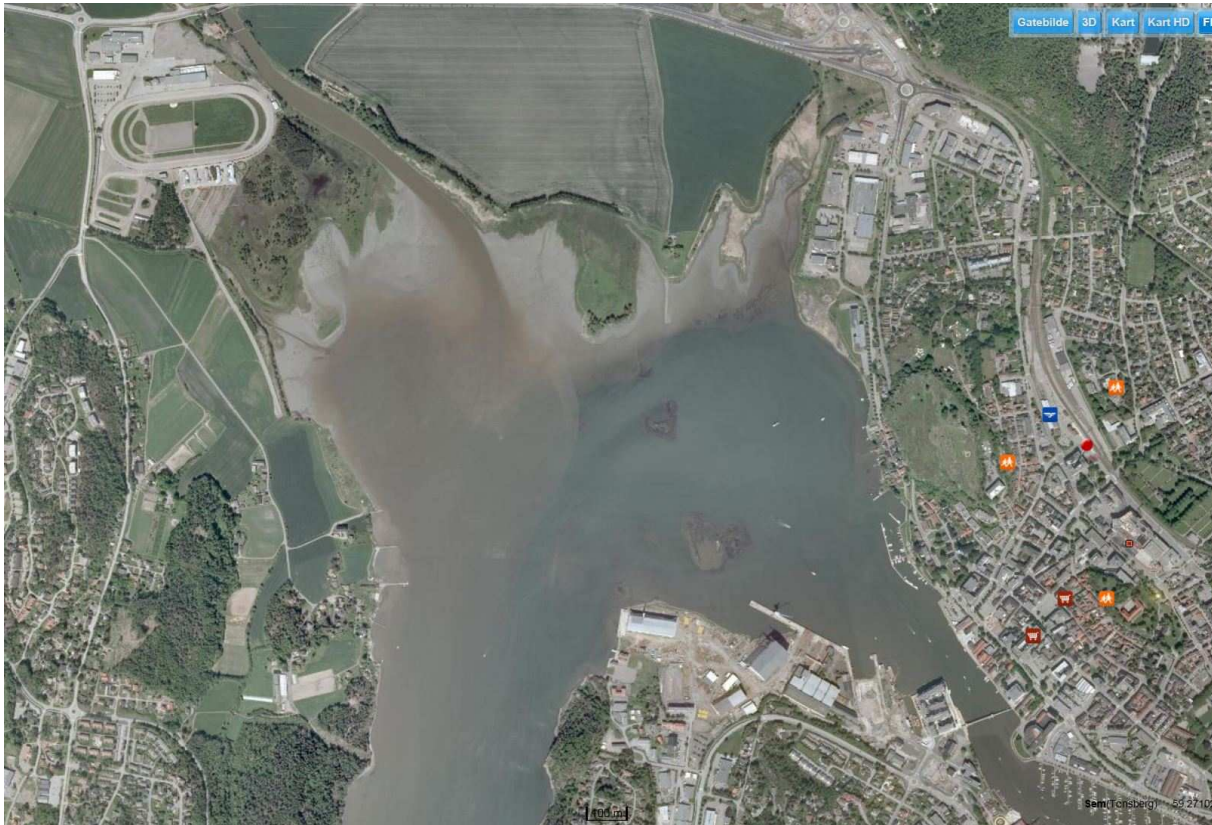
Figur 3: Flyfoto av utløpet av Aulielva og Byfjorden over mot Nøtterøy og Tønsberg. Bildet som er fra 2007 viser sedimenttransport fra elva langs vestsiden av fjorden sørover forbi Smørberg (lys brun farge). Foto hentet fra: http://kart.finn.no
