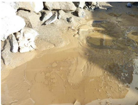
Figur 4-11 Spyling av jord ned i steinlag på betongplata ble testet i DEG. Resultatet sees på bildene: Silt- og leir fraksjonen skilte seg ut og fløt utover.
