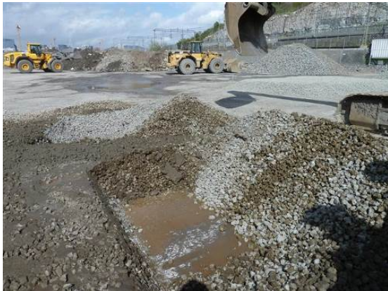
Figur 4-13 Det ble utført en utprøving med spyling av jord ned i skumglass. Skumglass flyter og det var ikke en god metode.
