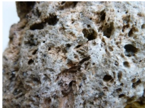
Figur 4-15 Pimpstein som ble brukt i nederste del av plantekassene i KH5. Hulrommene holder på vann og gir rom for mikrobiologisk aktivitet i jorda. Erfaringer må vi høste i årene framover.
