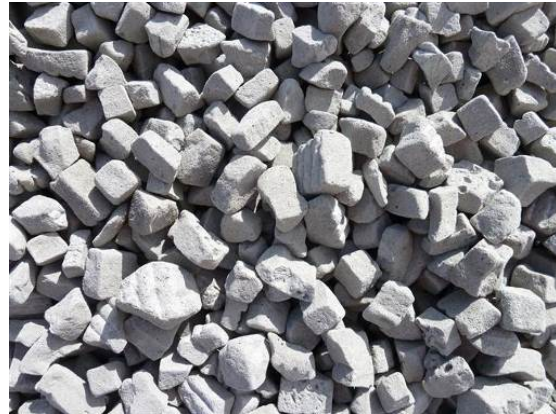
Figur 4-13 Det ble utført en utprøving med spyling av jord ned i skumglass. Skumglass flyter og det var ikke en god metode.
