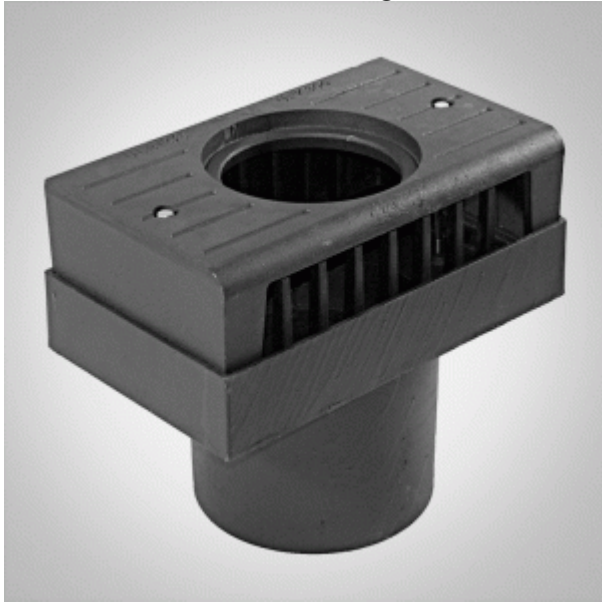
Figur 11-1 Kantsteinsluk med kvistfanger. Vannet må renne horisontalt inn i sluket, og det er ingen god løsning i en driftssituasjon.
