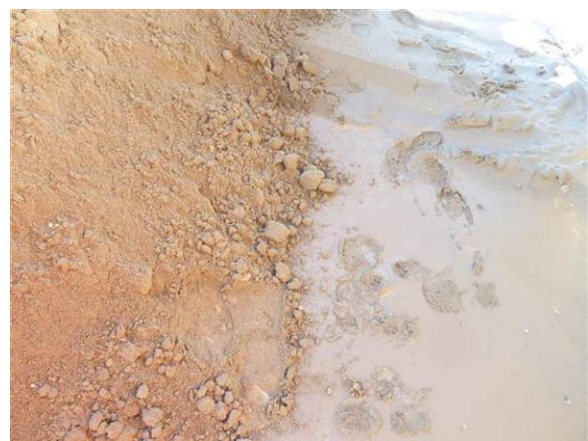
Figur 4-11 Spyling av jord ned i steinlag på betongplata ble testet i DEG. Resultatet sees på bildene: Silt- og leir fraksjonen skilte seg ut og fløt utover.
