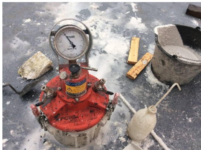
Figur 6-2 Ustabile luftprøver: Her måles et luftinnhold på 9 % som er utenfor kravet på 3,5 \% \pm 1,5 %
