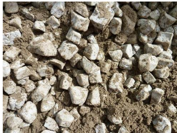
Figur 4-14 Harving av jord i skumglass. Det fungerte bra for blanding, men nedknusing av skumglasset ble et problem i praksis. Skumglass og jord ble blandet på forhånd før utlegging i gaten (KH5).
