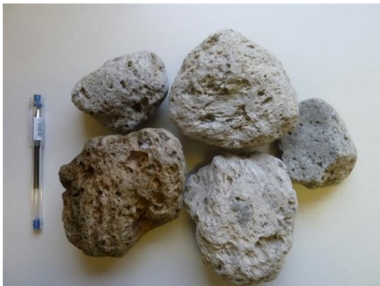
Figur 4-15 Pimpstein som ble brukt i nederste del av plantekassene i KH5. Hulrommene holder på vann og gir rom for mikrobiologisk aktivitet i jorda. Erfaringer må vi høste i årene framover.
