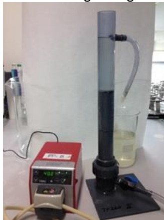
Figur 21. Kolonneforsøk med Olivin Blueguard.
