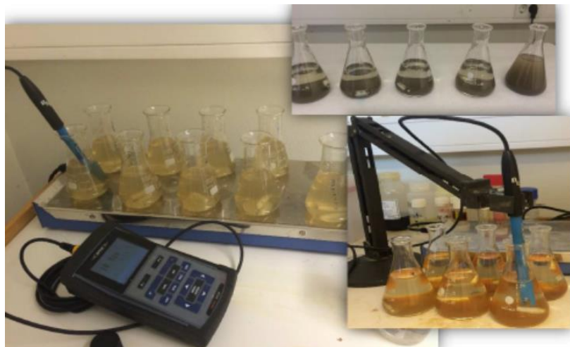
Figur 26. Screeningtest med 100ml vann i Erlenmeyerflasker.
