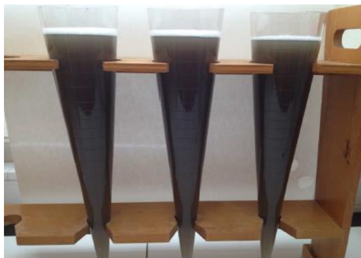
Figur 17. Sedimenteringstester med 1 liters Imhoff-glass satt til sedimentering ved 4 og 20 °C.
