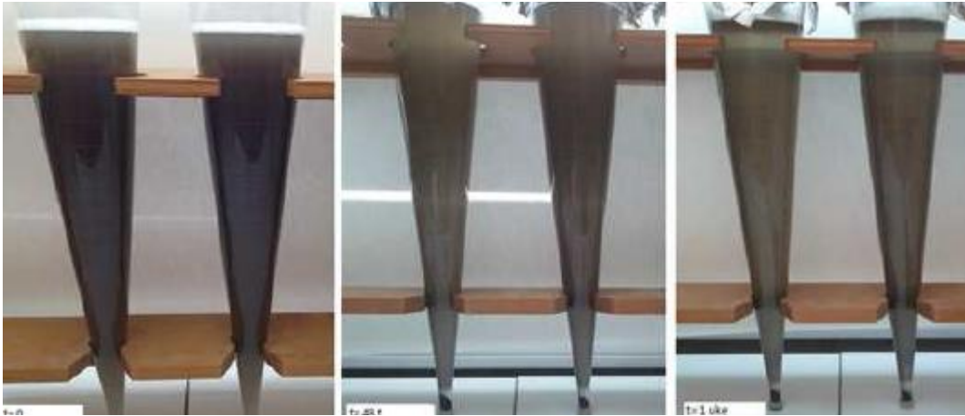
Figur 34. Sedimentasjonsforsøk i koniske 1 liters glass (Imhoff). Bildeserien øverst viser parallelle prøver ved romtemperatur ved startpunkt, etter 48 timer og en uke.
