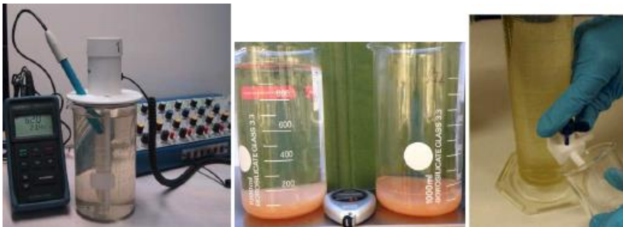
Figur 24. Jar-test etterfulgt av sedimentering eller flotasjon.
