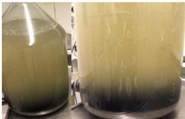
Figur 61 Anaerob nedbrytning ved 15 grader i 3 uker.
