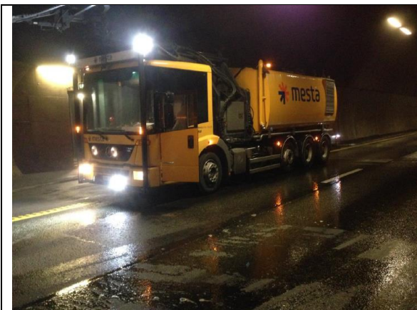
a) Mestas bil som ble benyttet til vasking av tunnelen
