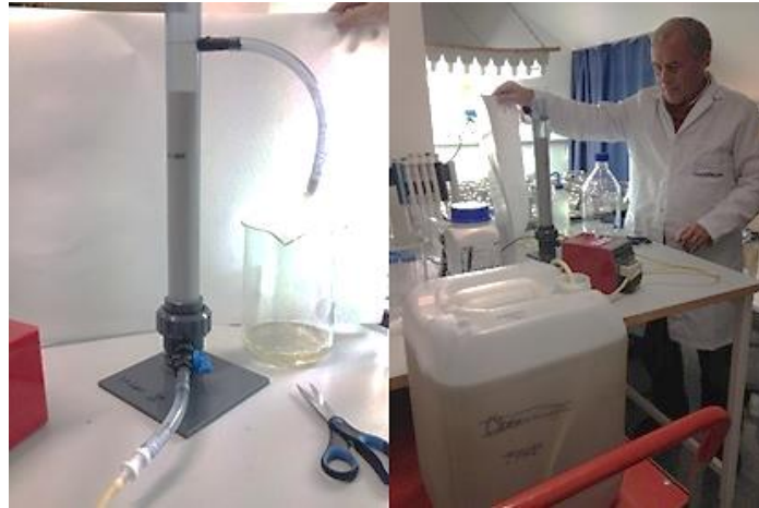
Figur 22. Kolonneforsøk med Lewatit ionebyttmasse.
