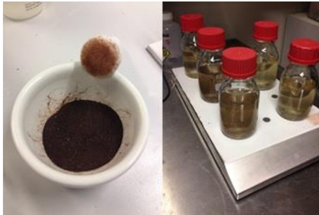
Figur 20. Jerngranulat og flasketester med fem ulike konsentrasjoner av granulatet.
