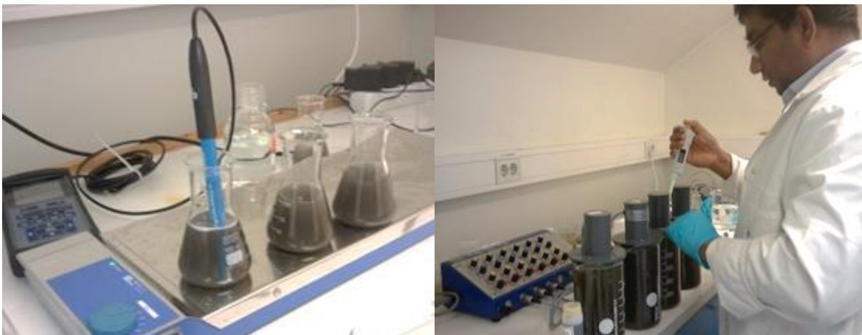
Figur 18. Screening tester med 100 ml erlenmeyerkolber og Jar-test med 1 L prøve.
