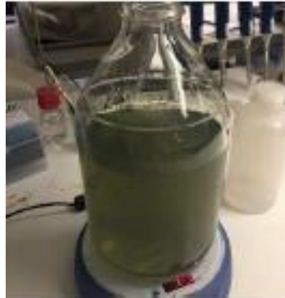
Figur 67. Homogenisering og utfelling av partikler etter pH-justering
