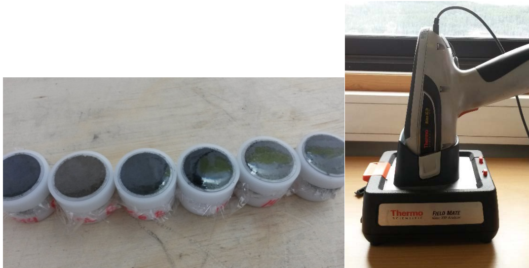
Figur 4. Ein oppnår meir nøyaktige analyseresultat når ein nyttar finknust bergartspulver i prøvekoppar dekte med ein tynn spesialtilpassa plastfilm frå fabrikanten, og med instrumentet stabilt plassert i eigen holdar. Kalibreringskorreksjonar må utførast på denne måten (eksempel frå skiferanalyse Rv 4 Gran). Foto: Halldis Fjermestad.
