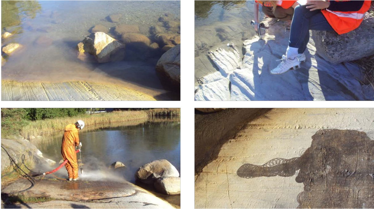
Figur 20 Kvite utfellingar ved Kaldvellfjorden blei analyserte med XRF før og etter fjerning ved trykkspyling (Foto: Per Hagelia).
