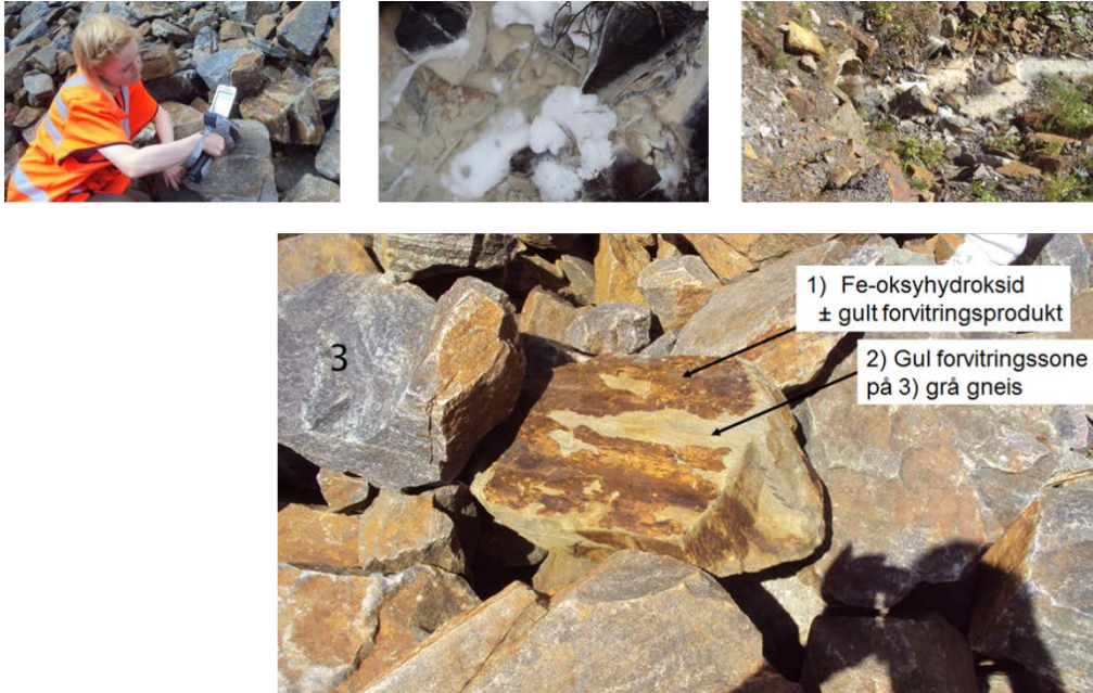
Figur 15: Foto frå deponi M20, august 2014; Hovudfotoet viser analysestrategien i NORWAT, med separate analysar av ulike skorpemateriale (1 og 2) og uforvittra gneis (3). Topplaget av deponert rusta sulfidførande gneis var lokalt 100 % eksponert (foto oppe, venstre). Bekken mellom deponiet og nøytraliseringsbassenget hadde utfellingar av aluminiumsrikt materiale i form av belegg på stein/berg og flytande skum (foto oppe, midt & høgre). Foto: Per Hagelia.
