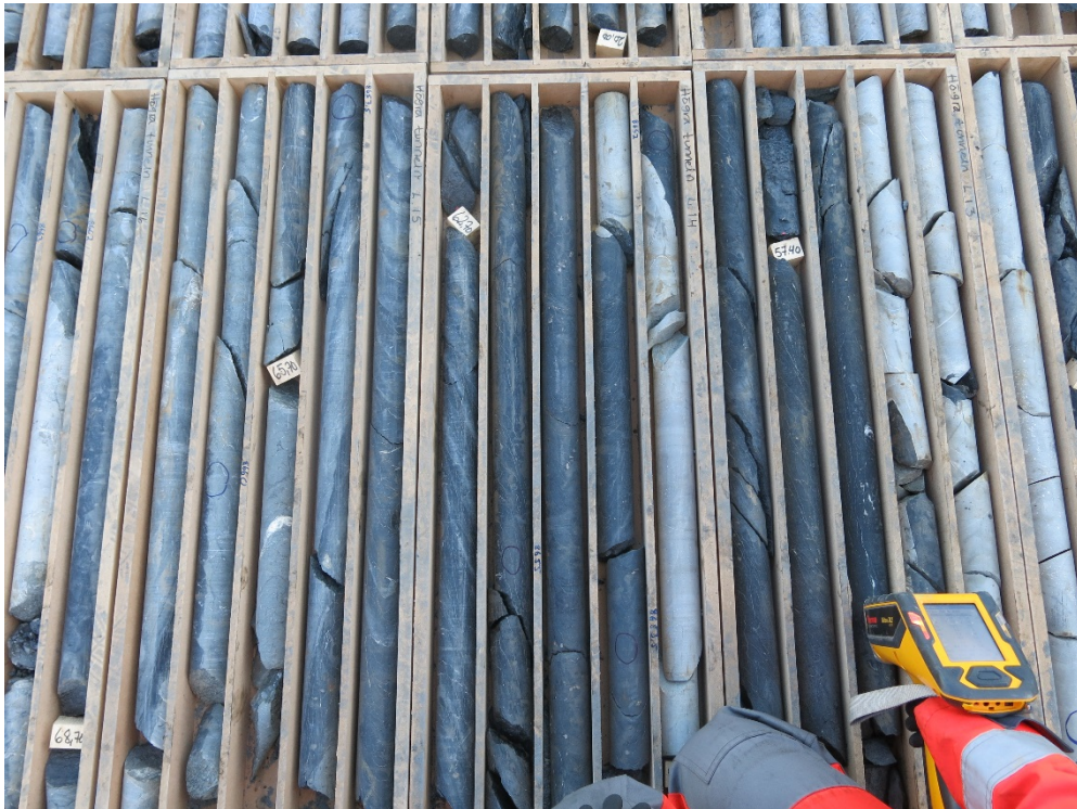
Figur 7. Måling med handheldt XRF på borkjerner. Kvart analyseområde blei teikna inn med tusj (sjå sirkel på kjerne til venstre i kassa) og dokumentert. Foto: Stian Ellingsen.
