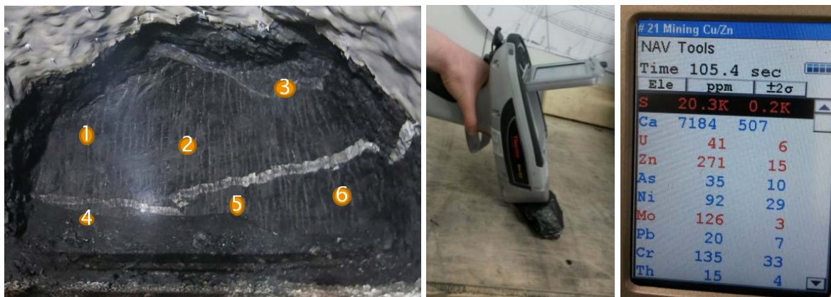
Figur 8: Framgangsmåte for prøvetaking av steinar frå tunnelstuffen. Foto: Halldis Fjermestad.
