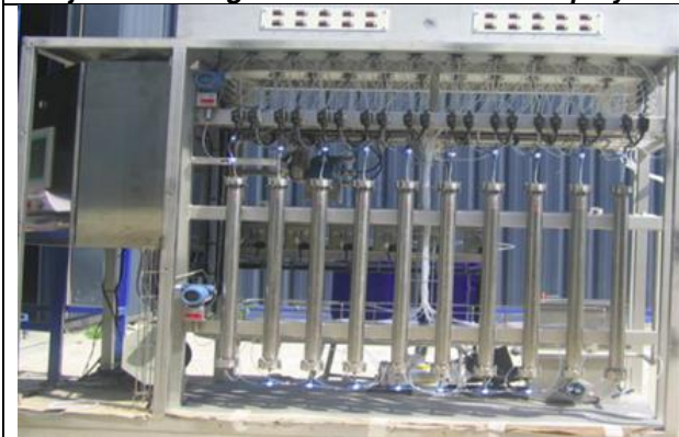
c. Ionebytte prosessen (IX= Ion eXchange); under rensing (produksjon) for fjerning av f.eks. tungmetaller
