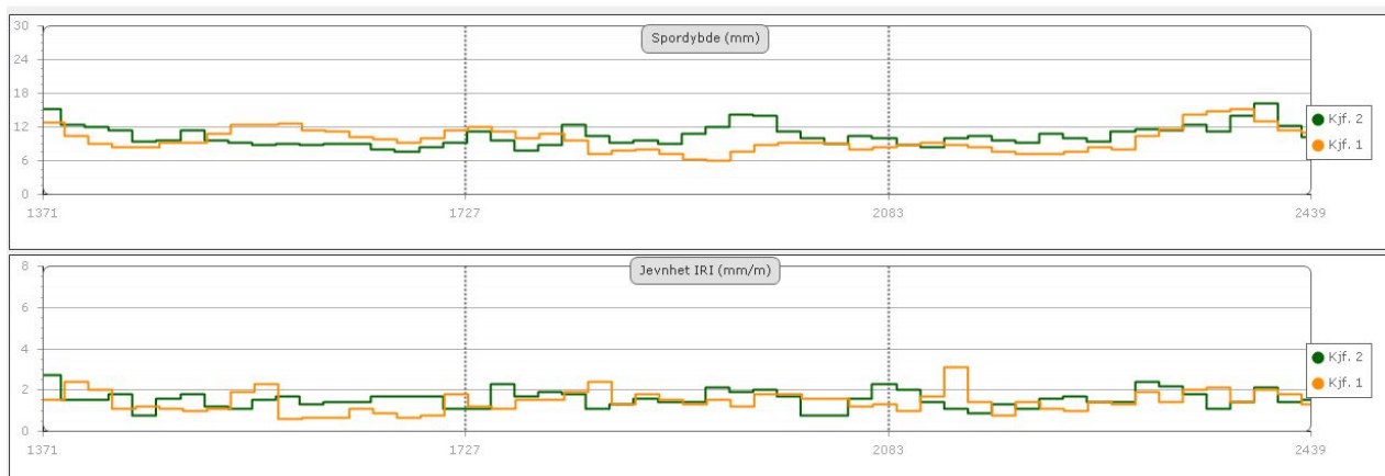
Figur 8. Spor- og jevnhetsmåling august 2016, felt 2 (grønn) er LTA.
