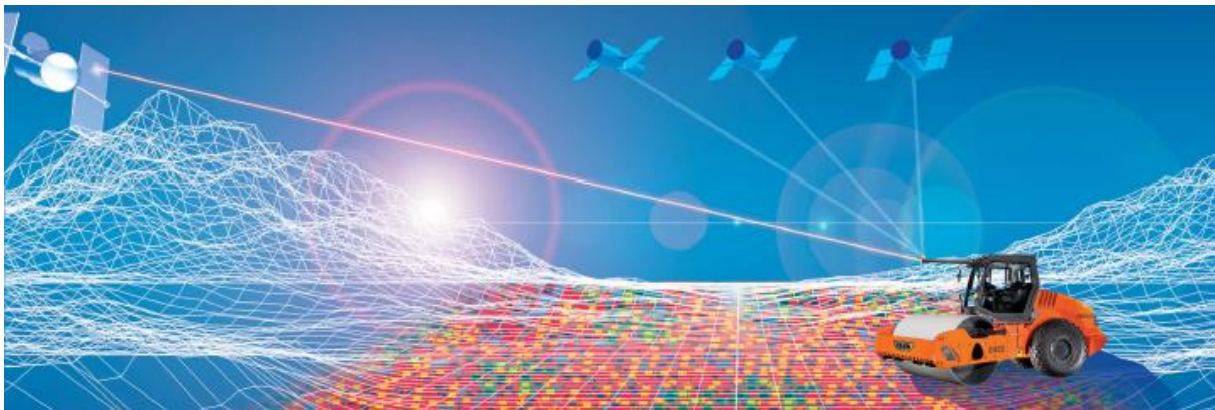
Figur 9 GPS-styring av komprimeringsarbeid
