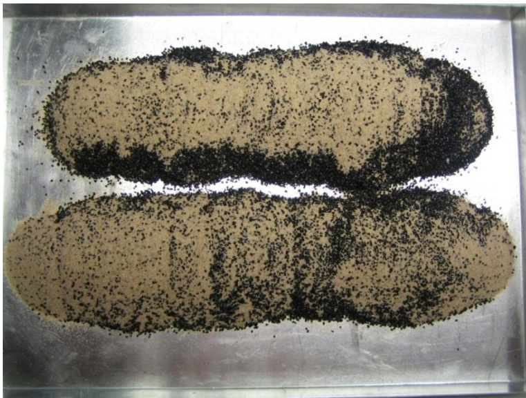
Figur 4 Laboratorieforsøk med lasting av bil. Grovt tilslag er sort. Øvre haug er «normal lasting» og nedre haug er lasting først foran og bak deretter på midten 3)
