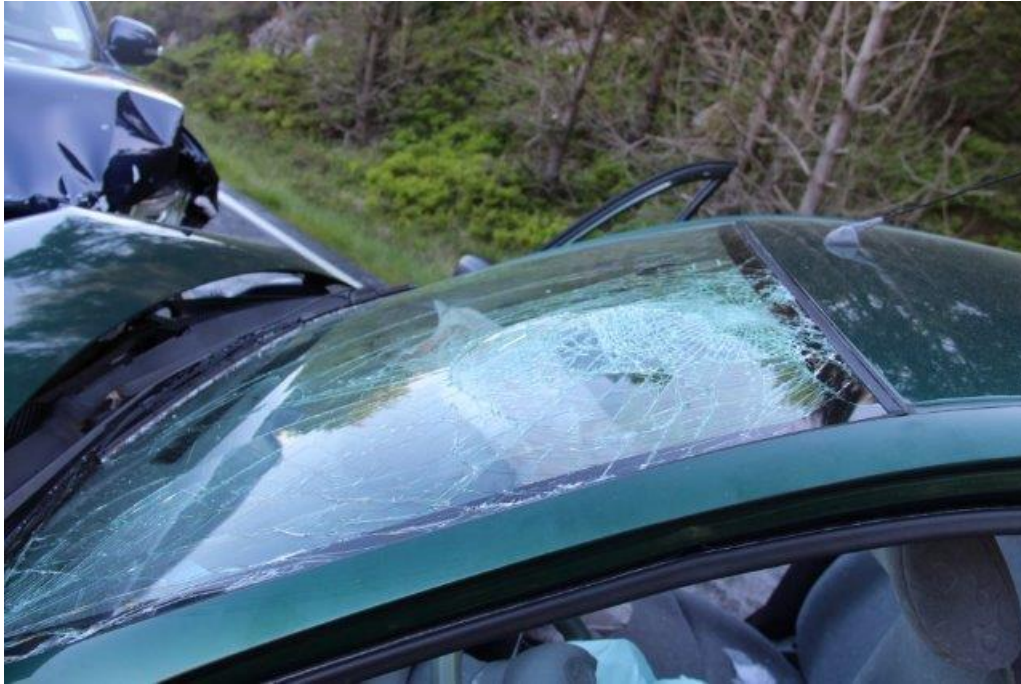
Figur 19 Hodet treffer frontrute og gir dødelige skader. Belte var ikke benyttet i denne ulykken.
