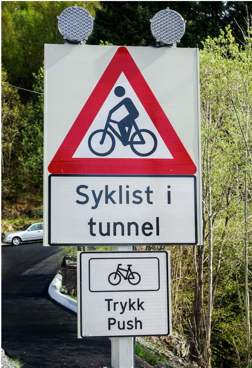
Figur 33 I tiltak mot sykkelulykker i tunnel er det prøving av sykkelknapp som vil varsle annen trafikk om at det er sykklister i tunnelen. Kilde Statens vegvesen
