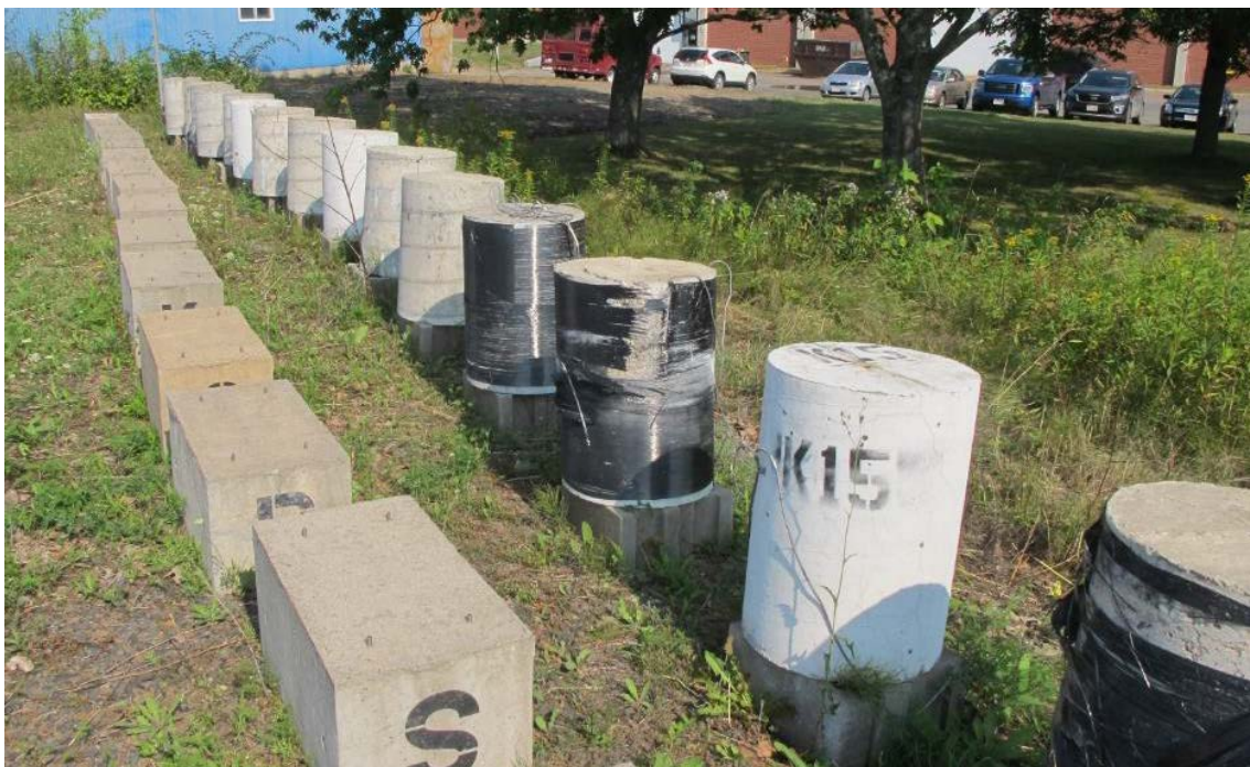
Figur 59 UNBs feltstasjon – kuber og sylindre. (Foto: Eva Rodum)
