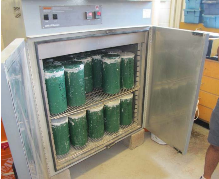
Figur 60 Akselerert ekspansjon i henhold til "UNB-CCT-metoden" i varmeskap med temperatur 60 °C. (Foto: Eva Rodum)
