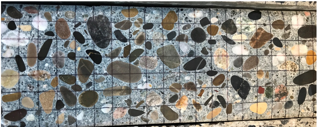
Figur 25 Planslip med påtegnet 1 cm 2 rutenett. (Foto: Jan Lindgård)
