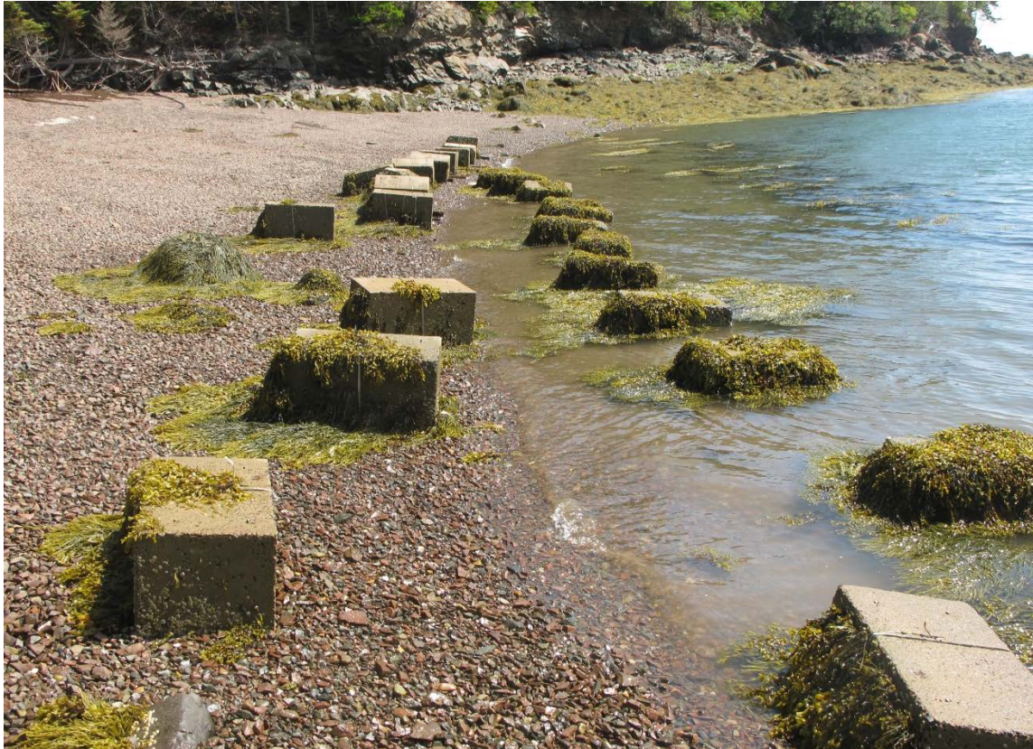
Figur 55 Treat Island. Tidevannet ebber og prøvestykkene kommer til syne. Merk varierende grad av begroing. (Foto: Eva Rodum)
