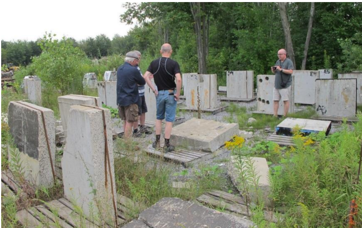
Figur 19 Oversikt feltstasjon med elementer tilsaget fra ulike deler av utskiftede grunnmurer. (Foto: Eva Rodum)
