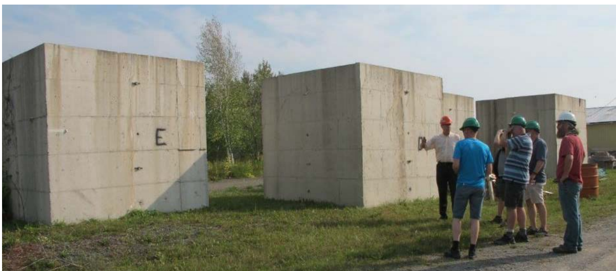
Figur 65 Makrokuber ( 3 \times 3 \times 3 \text{ m}^3 ) utstøpt i 2008, med Springhill-tilslag og ulike flygeaskeinnhold (0, 30, 40 og 50 %). (Foto: Eva Rodum)
