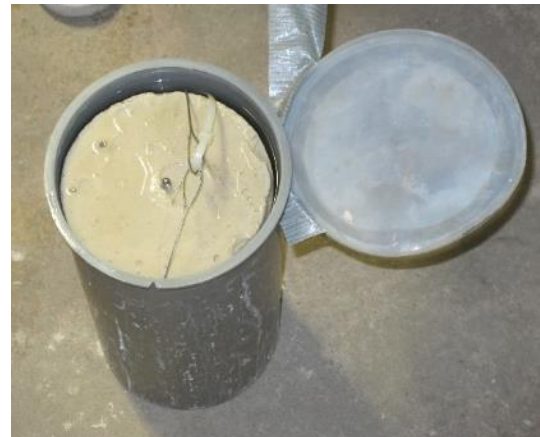
Figur 60 Akselerert ekspansjon i henhold til "UNB-CCT-metoden" i varmeskap med temperatur 60 °C. (Foto: Eva Rodum)
