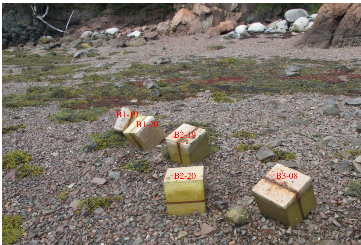
Figur 57 LNEC-kubene, plassert i tidevannssonen. Kubenes merking er påført fotoet. (Foto: Eva Rodum)
