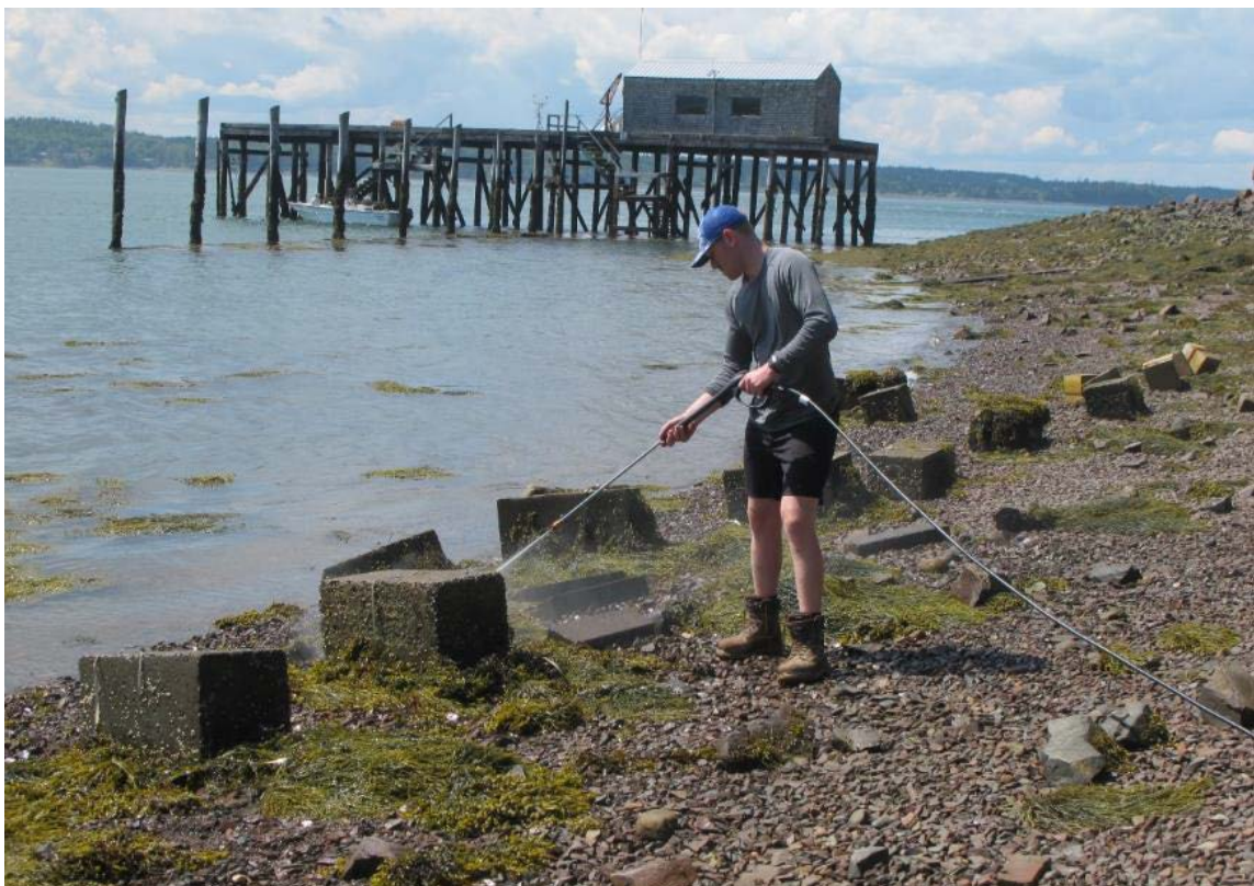
Figur 56 Prøvestykkene er frilagt og begroing fjernes ved høytrykksspyling (Ted Moffatt) før måling av ekspansjon. Det er en kort tidsåpning før tidevannet snur og kommer opp igjen. (Foto: Eva Rodum)
