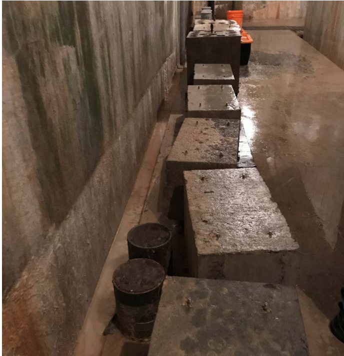
Figur 64 Instrumenterte kuber og prøvestykker lagret i et fuktig galleri inne i dammen. (Foto: Jan Lindgård)
