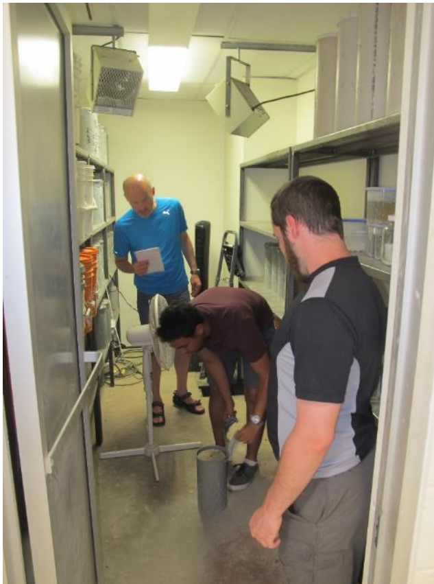
Figur 61 Akselerert ekspansjon i henhold til "UNB-CCT-metoden" i rom med temperatur 38 °C. Nærbilde av prøvestykke i spann med alkalisk væske til høyre. (Foto: Eva Rodum)
