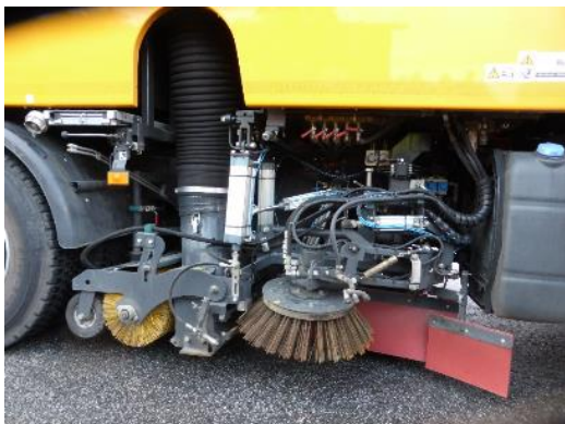
Figur 7: Feiesystem midt på bilen (foto: Brynhild Snilsberg)
