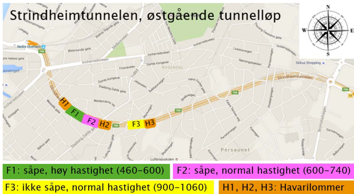
Figur 2: Oversikt over plassering av feltene som ble rengjort i Strindheimtunnelen, østgående tunnellop, høyre kjørefelt
