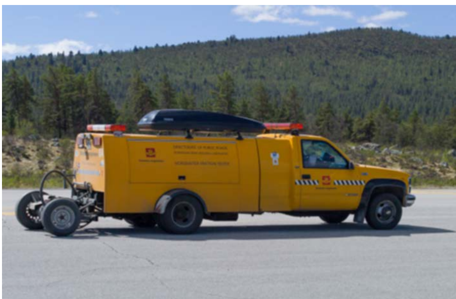
Figur 27: OSCAR målebil for friksjon (Foto: Statens vegvesen)
