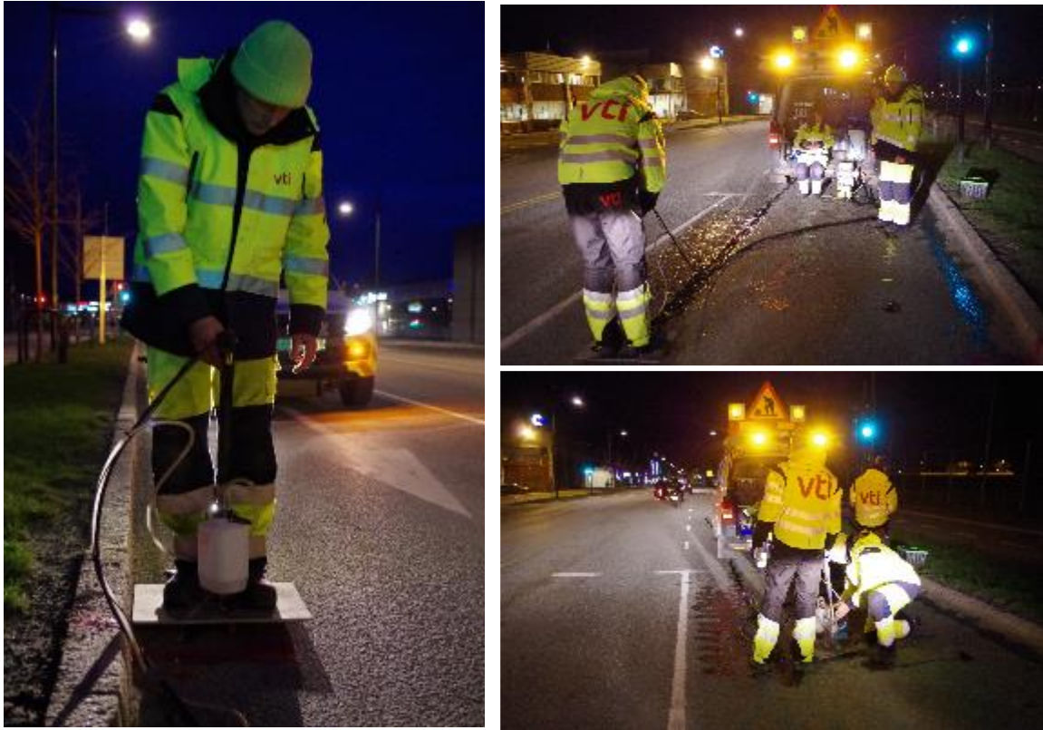
Figur 33: Prøvetaking med WDS i Haakon VII gate (foto: Brynhild Snilsberg)
