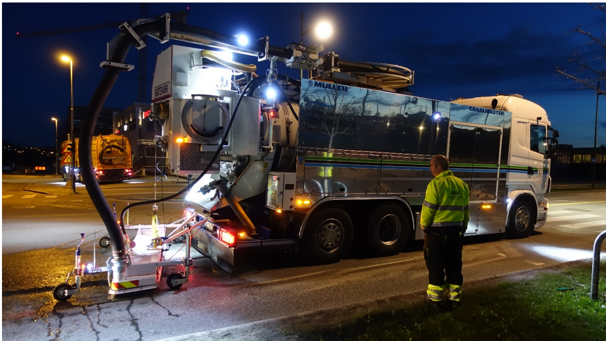
Figur 13: Høytrykkspyleenhet koblet på suge-/pumpebil (Foto: Dagfin Gryteselv)
