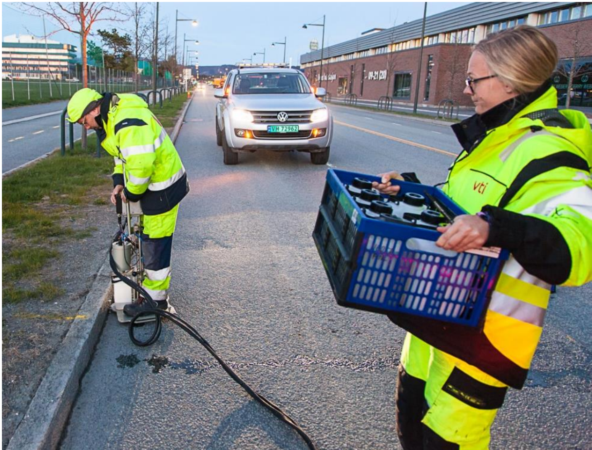
Figur 7. WDSII-provtagning på Haakon VII gate. Foto: Mats Gustafsson, VTI.
