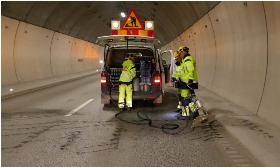
Figur 31: Prøvetaking av støv på bankett og vegbanen før rengjøring (foto: Brynhild Snilsberg)
