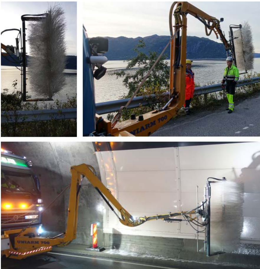
Figur 18: Vaskebørste (Ottem) med spylebom (Foto: Dagfin Gryteselv)
