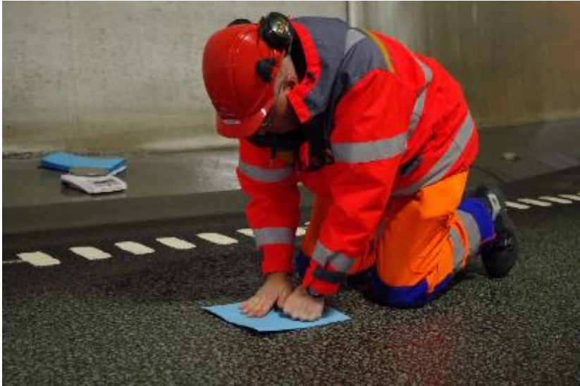
Figur 34: Måling av restfukt på vegbanen (foto: Brynhild Snilsberg)
