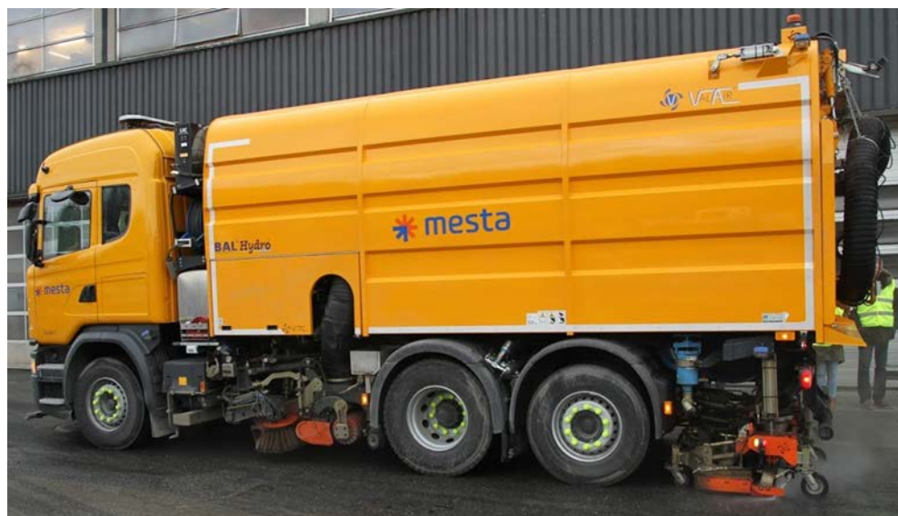
Figur 14: ValAir feiebil med rotorclean-system (Foto: Brynhild Snilsberg)
