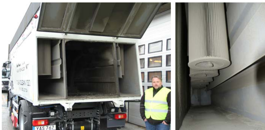
Figur 12: Disa-Clean med grovkammer i midten og filtersystem PM2,5 på begge sider (Foto: Brynhild Snilsberg)
