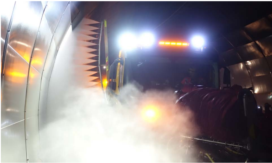
Figur 16: Høytrykksspuling med bom (Mesta) ble tatt i bruk når frontspylebom ikke fungerte pga slangebrudd. Bommen er regulerbar 2–4,5 m lang (Foto: Dagfin Gryteselv)
