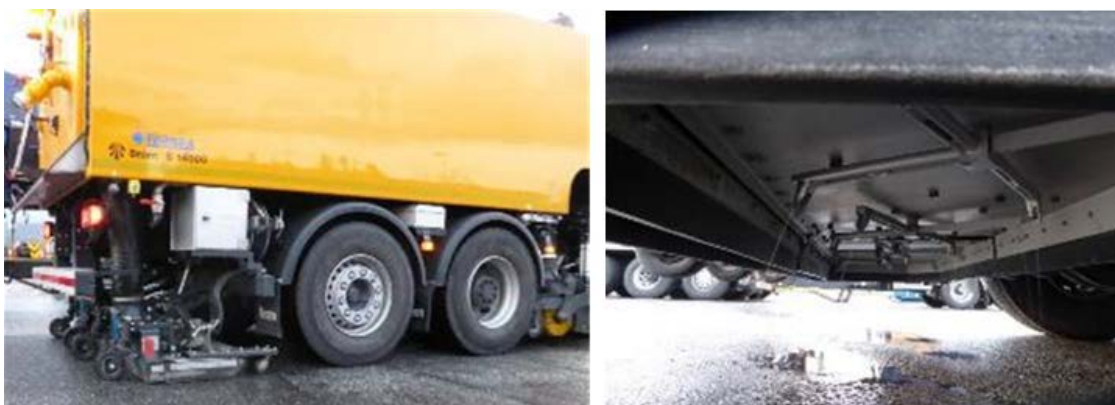
Figur 8: Rotorclean med baksug (foto: Brynhild Snilsberg)
