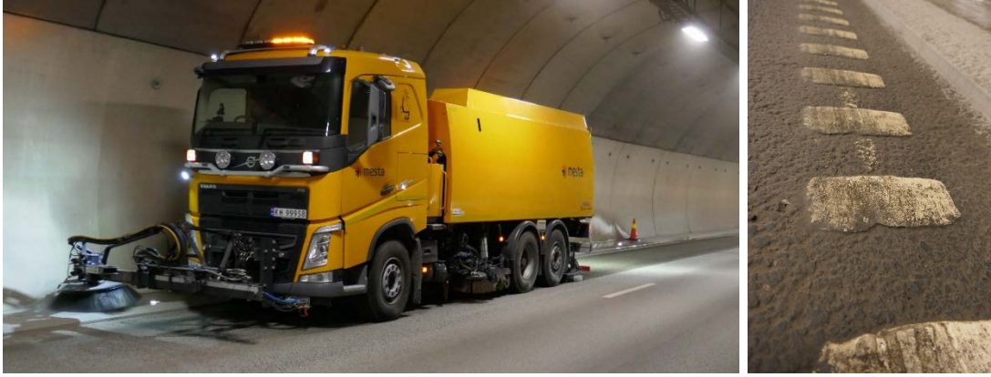
Figur 19: Drag 1 med frontbørste og rotorclean (Foto: Brynhild Snilsberg)
