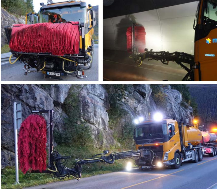
Figur 17: Polerbørste (Mesta) (Foto: Dagfin Gryteselv)
