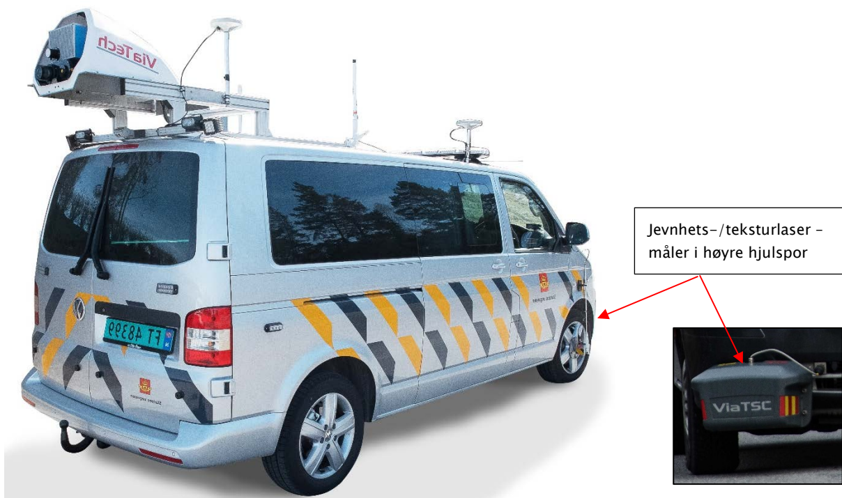
Figur 26: ViaPPS målebil for spor, jevnhet, tverrfall og vegbilder. Jevnhets-/teksturlaser innfelt (Foto: ViaTech AS/Sigurd Skjelmo)
