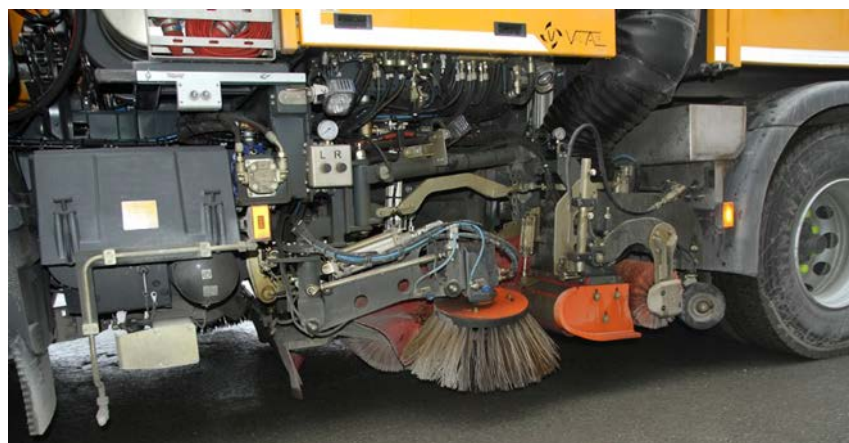
Figur 15: Feieaggregat midt på bilen ble ikke benyttet under forsøkene (Foto: Brynhild Snilsberg)
