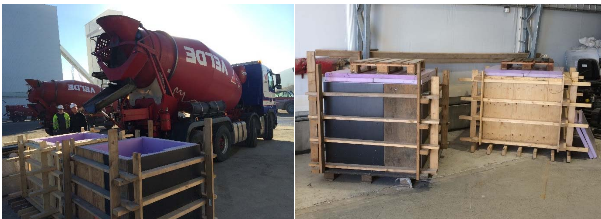
Figur 6 Herdekasseforsøk – Isolerte 1 m 3 kasser før støp og under måling
