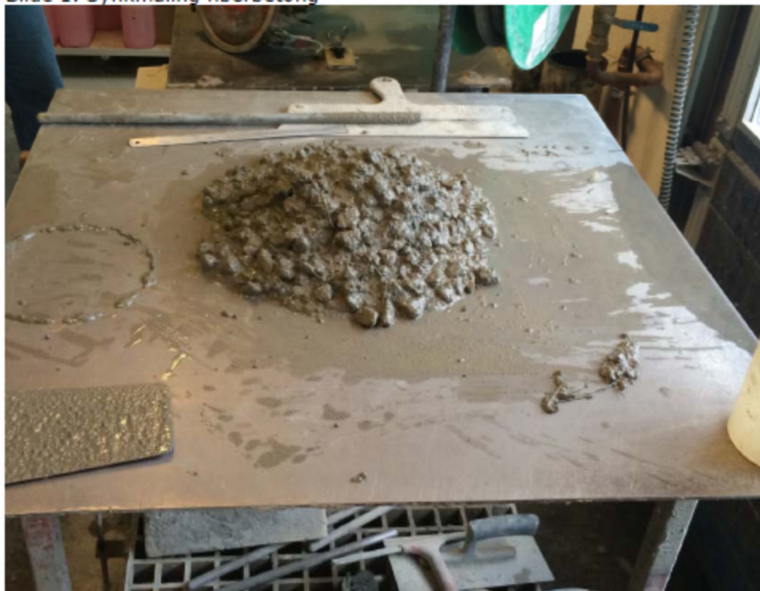
Bilde 1. Synkmåling fiberbetong
