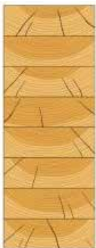
Figur 10-2: Orientering av sprekkenes i en limtrebjelke Figure 10-2: Orientation of cracks in a glulam beam
