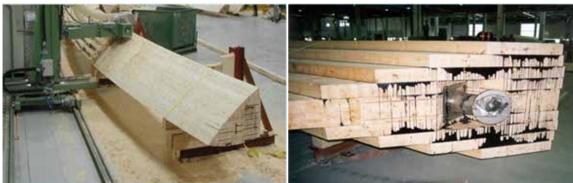
Figur 11-1: Limtrebuer blokklimt sammen til et massivt buetverrsnitt, og så høvlet til trekantet tverrsnitt med glatte, svakt buede flater ved hjelp av en computerstyrt høvel.
