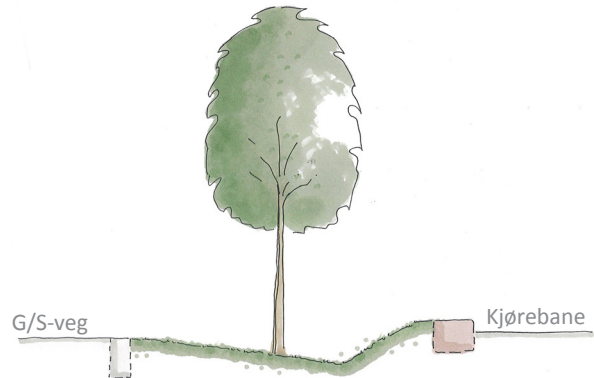
Tre midt i siderabatt. Bratt helling fra gata, slak helling fra gangveg
