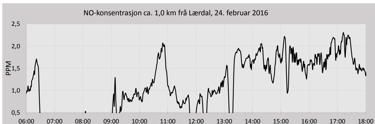
Figur 37: Eksempel på frisk luft over 1,0 km inn frå Lærdal (mot ventilasjonsretninga)
