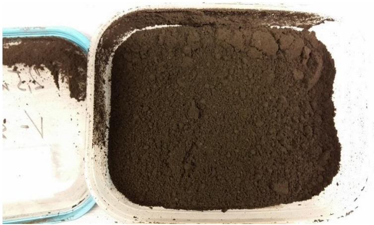
Figur 6. Bilde av prøve LFH2.5 ved uttak til SEM analyse. Prøve ble tatt ut på 5 steder med spatel.
