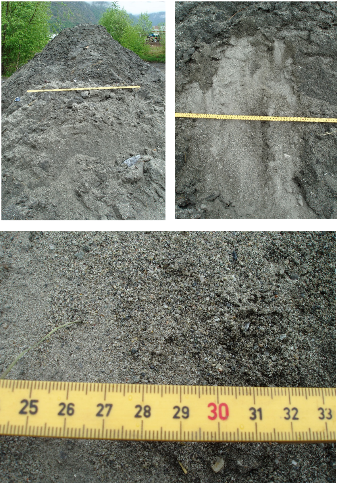
Figur 67: Eksempel på sand- og grov silt som vart fjerna tørt frå Lærdalstunnelen i mai 2016
