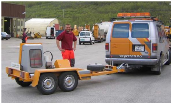
Figur A13 Falloddsmåler og prinsippsskisse for måling av nedbøyningsbasseng
