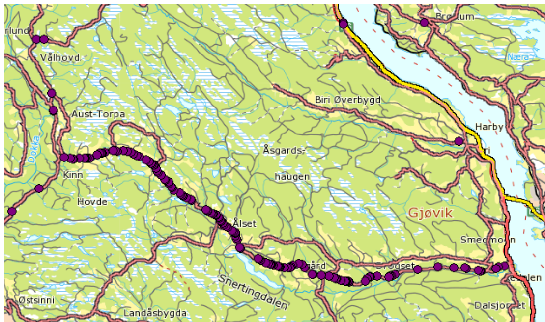
Figur A10 Punkter med registrert ujevnt telehiv, Fv 249 i Oppland
