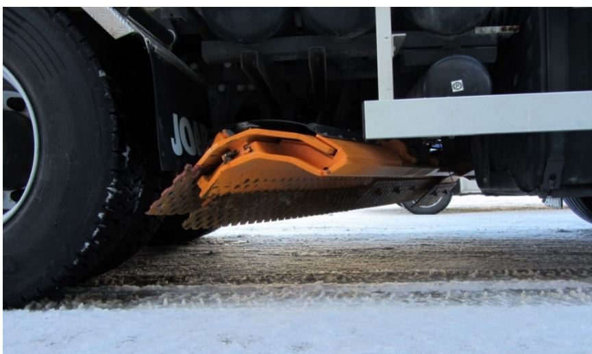
Figur 4-35 Underliggende skjær (Foto:Dagfin Gryteselv)
