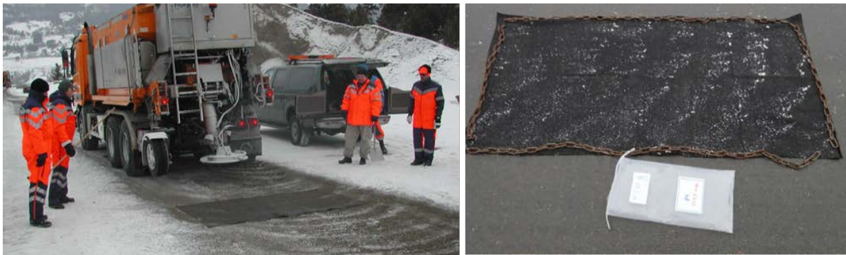
Figur 6-20 Kontroll av utstrødd mengde strømateriale med utlagte duker. (Foto: Torgeir Vaa og Stein Hoeseth).
