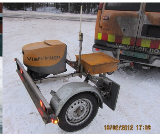
Figur 5-18 ViaFriction-friksjonsmåler, hengerversjon. (Foto: Dagfin Gryteselv)
