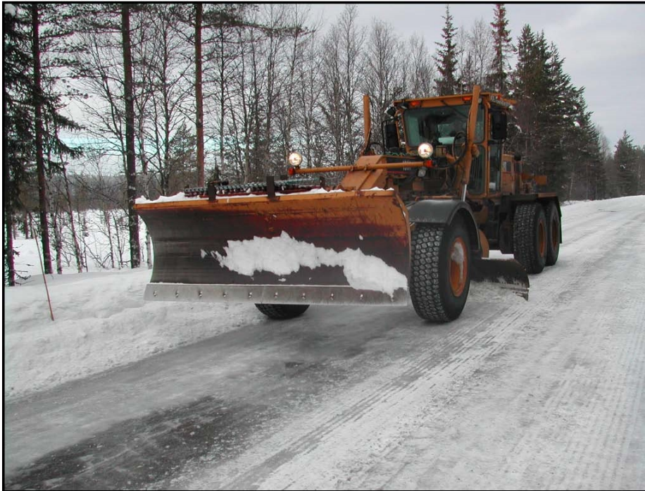
Figur 4-72 Veghøvel i arbeid
