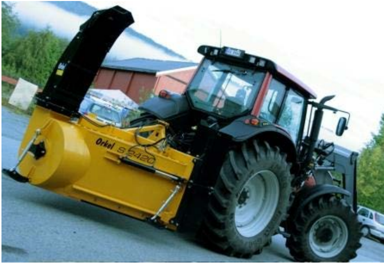
Figur 4-81 Bakmontert snøfres på traktor (Foto:Orkel AS)
