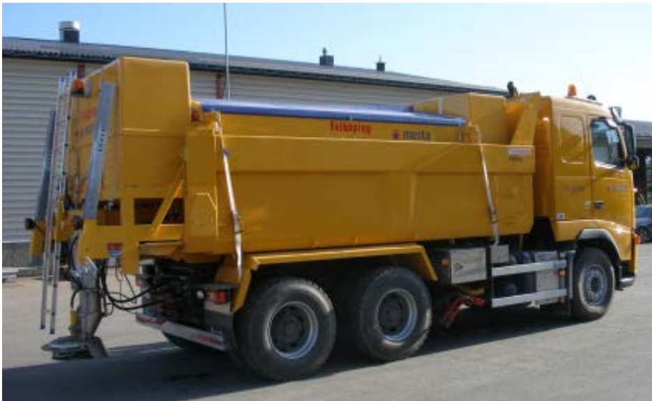
Figur 6-17 Eksempel på bærekjøretøy for sanding og salting.
