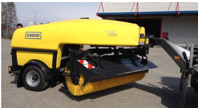
Figur 6-12 Roterende kost og løsningsspreader for gang- og sykkelveger. Trekkes av en traktor. (Foto: Dagfin Gryteselv, Statens vegvesen)
