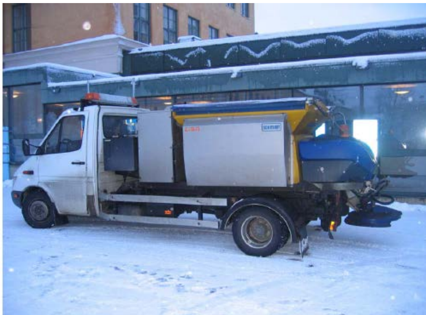
Figur 6-13 Kjøretøy for fastsandspredning på gang- og sykkelveger som er benyttet i Umeå kommune (prototype). (Foto: Anna Niska, VTI Sverige)
