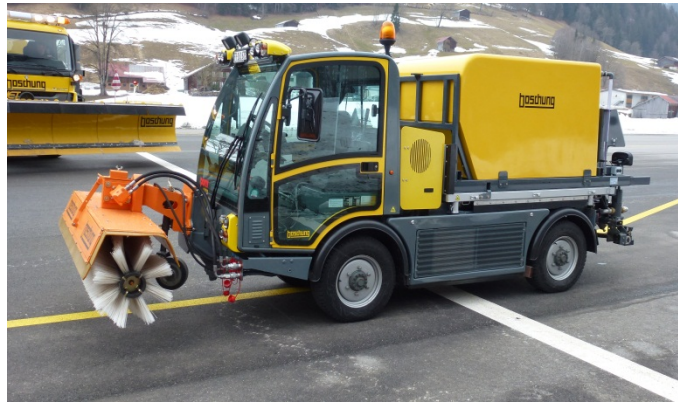
Figur 6-9 Eksempel på utstyr for gang- og sykkelveger med frontmontert kost og dysespreder. (Foto: Dagfin Gryteselv, Statens vegvesen)
