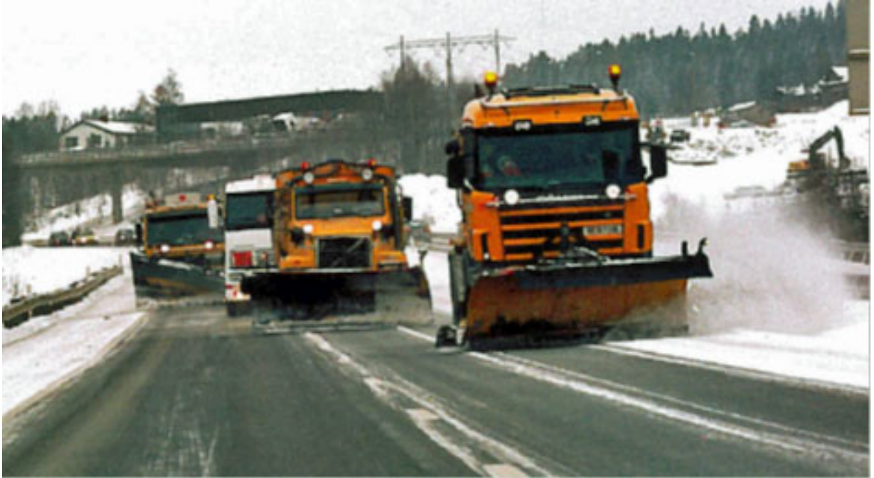
Figur 2-33 Tandembrøyting. Her ser vi også en utålmodig vogntogsjåfør (plogene på bildet er ikke merket i hht. dagens krav) (Foto: Statens vegvesen).
