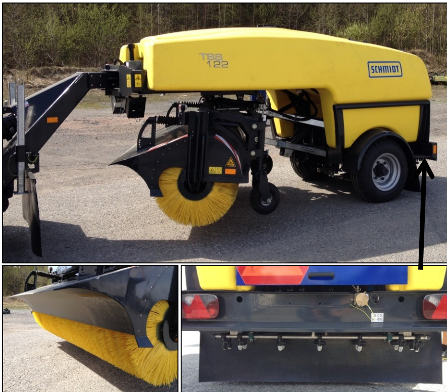
Figur 4-50 Eksempel på traktormontert etterhengende sweeper med saltløsningspreder (Foto: Dagfin Gryteselv, Statens vegvesen)
