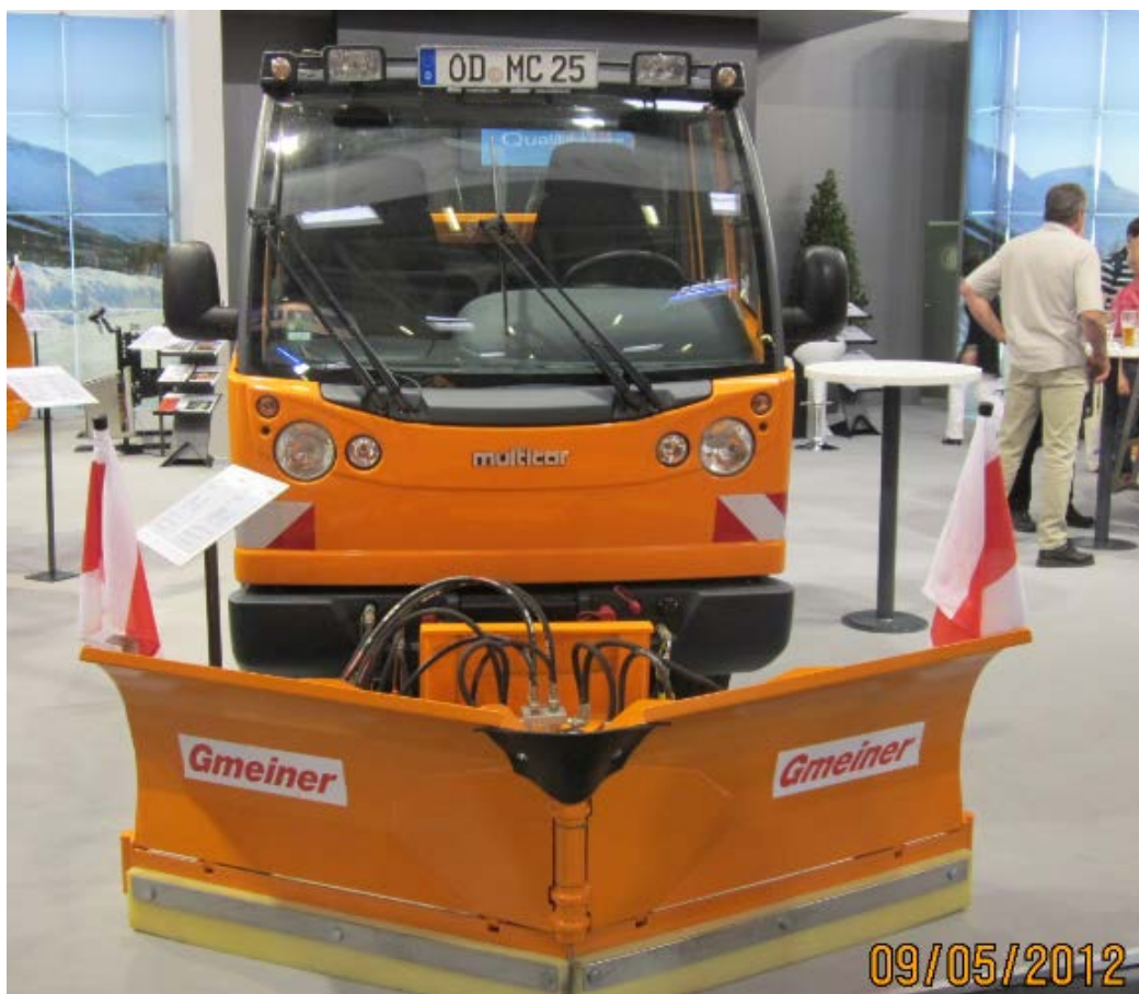
Figur 4-68 Utstyr egnet for fortau (Foto: Peder Tangen, Statens vegvesen)
