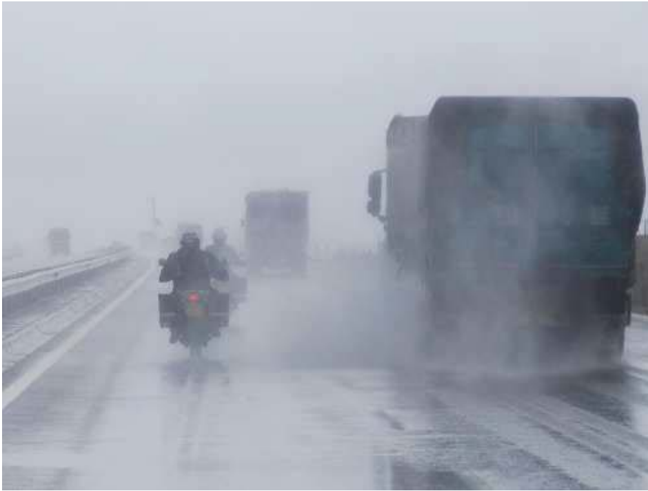
Figur 6-23 Oppvirvling fra vegoverflate.
