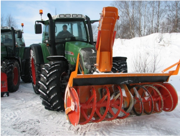
Figur 4-47 Frontmontert snøfres (Foto:Tellefsdal)
