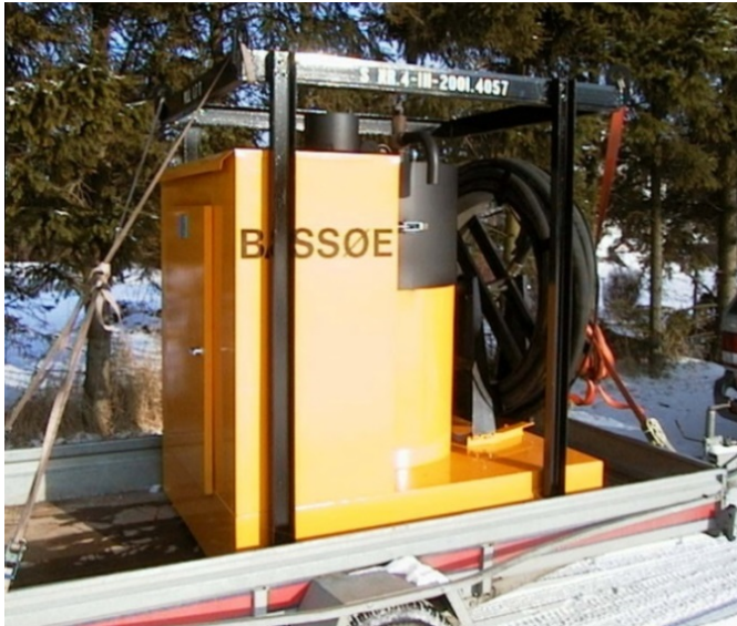
Figur 9-16 Bassøe tineutstyr montert på tilhenger (Foto: Glomsrød Mek. Verksted)
