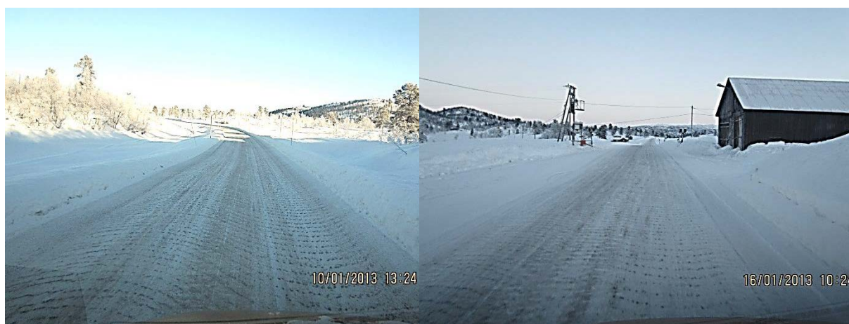
Figur 7-6 Varighet av fastsandmetoden på lavtrafikkert veg og stabile værforhold. (Foto: Stein Åsheim, Statens vegvesen.) (t.v.: etter utlegging, friksjon 0,49 i gjennomsnitt, t.h.: etter 6 døgn, friksjon 0,35 i gjennomsnitt. ÅDT ca. 500.)
