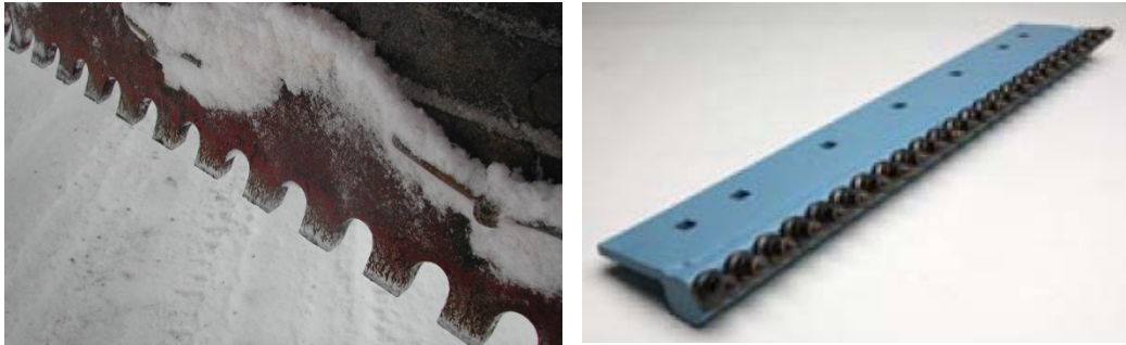
Figur 4-39 a) Isriverstål, tannet b) Hardmetallstift skjær (System 2000)
