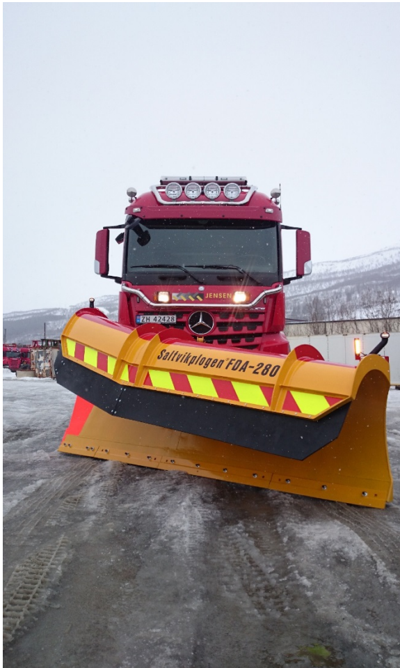
Figur 4-8 Merking av ploger (Foto: Ole Saltvik).
