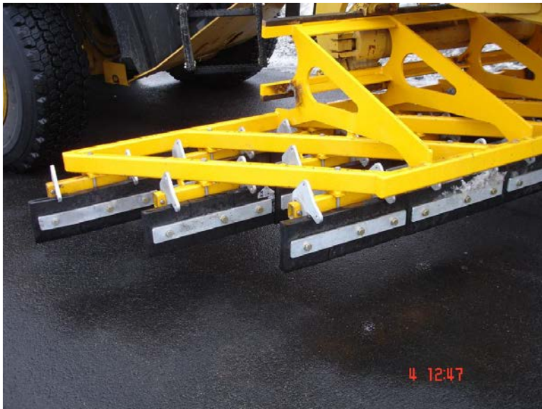
Figur 4-45 Slapsegrind montert på høvel (Foto: Torgeir Vaa)
