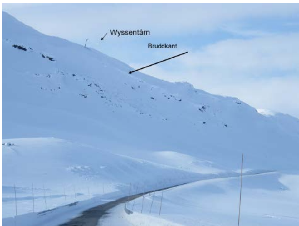
Figur 4-94 Wyssestårn brukt til nedsprenghing av snøskred på fv. 53 Årdal-Tyin. Tårnet har flere sprengladninger som kan avfyres trådløst etter behov. Foto Njål Farestveit, Statens vegvesen
