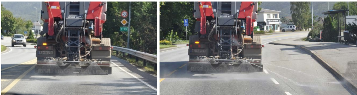
Figur 6-30 Varierende spredebredde styrt av GPS-posisjon (Foto: Dagfin Gryteselv, Statens vegvesen)
