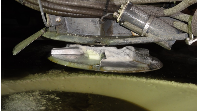
Figur 6-33 Strøtallerken må også sjekkes og rengjøres
