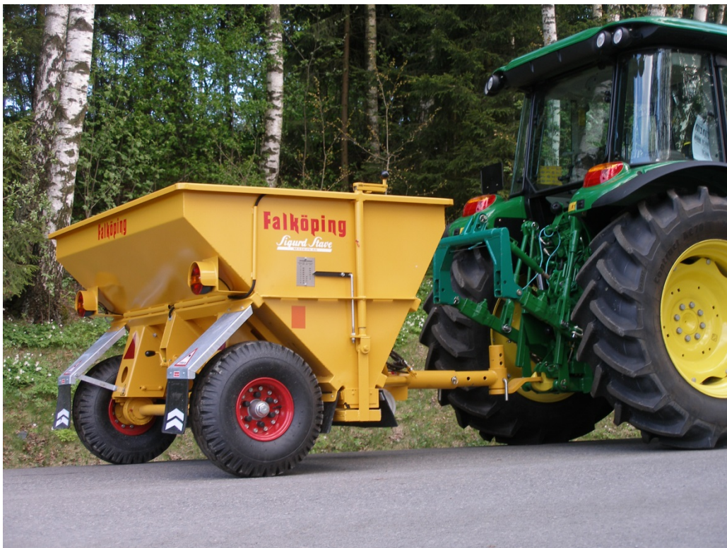
Figur 6-15 Etterhengende strøapparat for traktor. (Foto: Per Ingar Haug)
