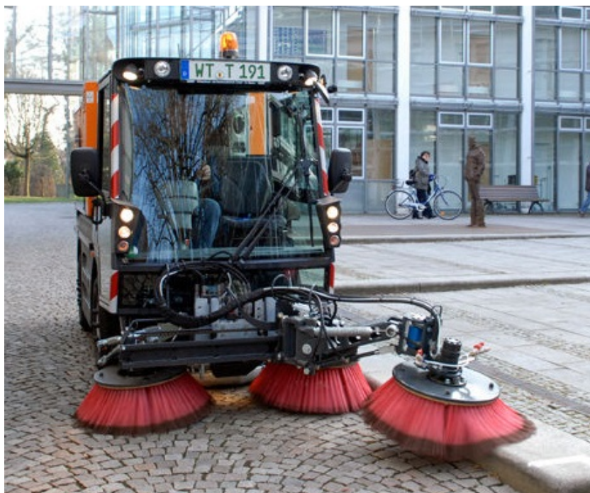
Figur 9-35 Utstyr for renhold av fortau, gang-/sykkelveger og plasser. PM10-sertifisert (Kilde: www.Aebi-Schmidt.no )
