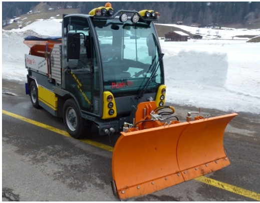
Figur 6-8 Eksempel på utstyr for gang- og sykkelveier med tallerkenspreder (sand/salt) og frontplog. (Foto: Dagfin Gryteselv, Statens vegvesen)
