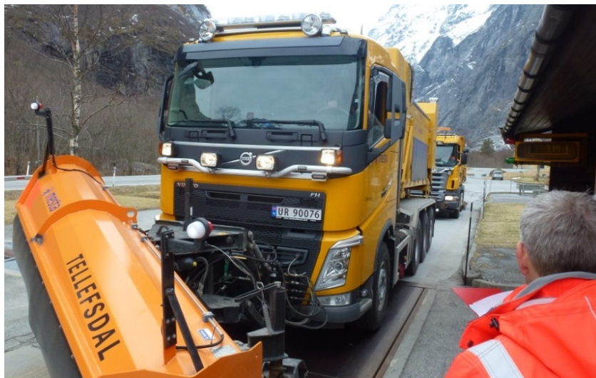
Figur 6-21 Veiling av kjøretøy før og etter strøing (Foto: Dagfin Gryteselv, Statens vegvesen)
