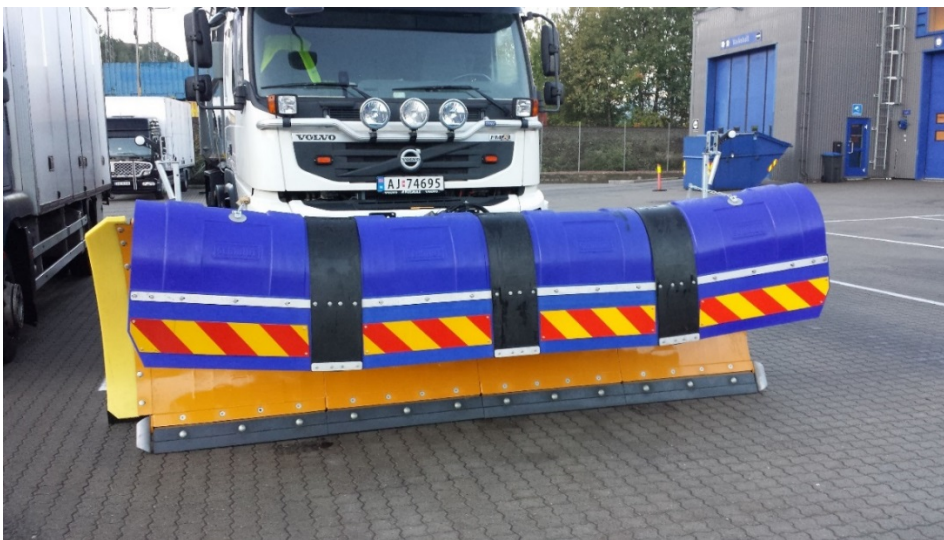
Figur 4-30 Seksjonsoppdelt plog (Foto: Schmidt Norge AS)
