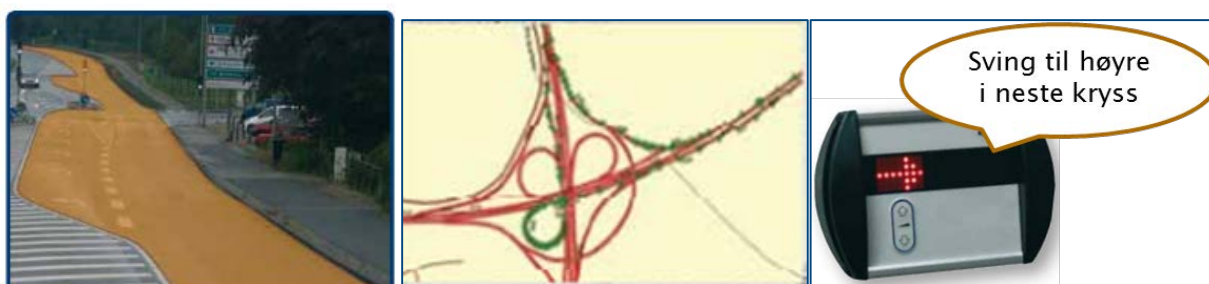
Figur 6-31 Varierende spredeareal (t.v.) og førerstøtte i kompliserte vegsystem (Illustrasjoner: Epoke)
