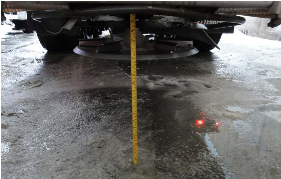
Figur 7-7 Måling av høyde på spredertallerken (Foto: Dagfin Gryteselv, Statens vegvesen)
