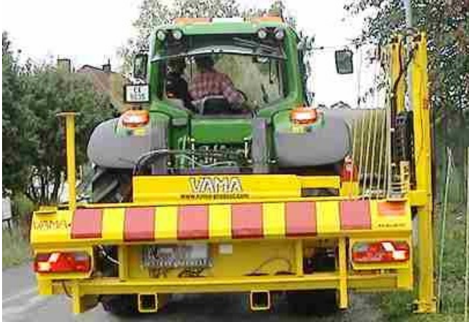
Figur 9-31 Utstyr for oppsetting av brøytestikk montert på traktor (Foto: Torp Maskin AS)
