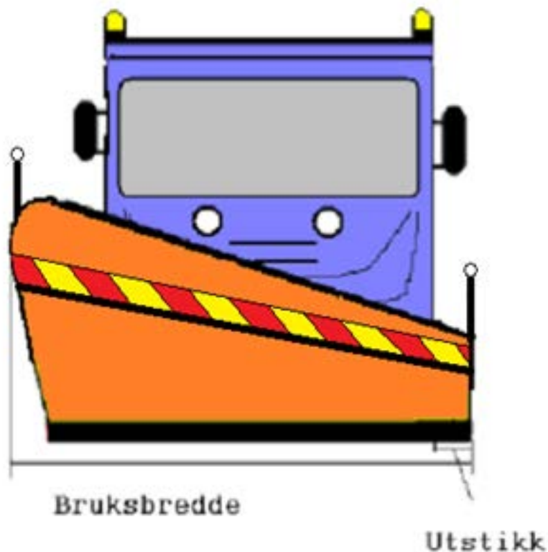
Figur 4-7 Merking av plog. Bruksbredde, utstikk og lys.
