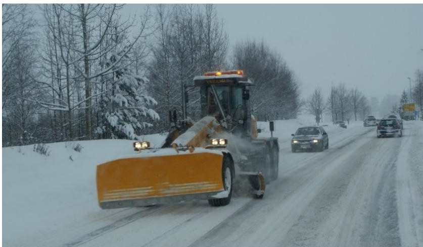
Figur 2-6 Det kan stilles egne krav til bruk av spesielt utstyr som for eksempel veghøvel (se også kapittel 2.1)
