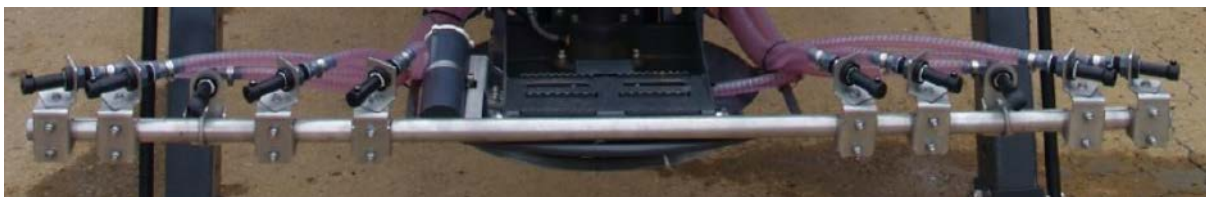
Figur 8-7 Spredning av saltløsning med tallerken eller dyser
