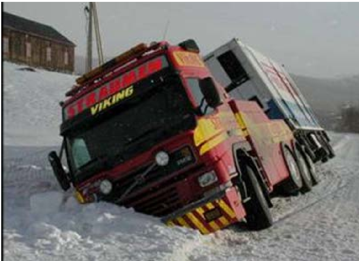
Figur 9-5 Feilplasserte eller manglende brøytestikk, kan føre til ulykker (Foto: Statens vegvesen)
