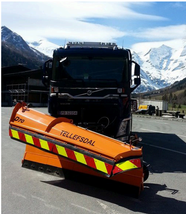
Figur 4-25 Diagonalplog (Foto: Tellefsdal AS)
