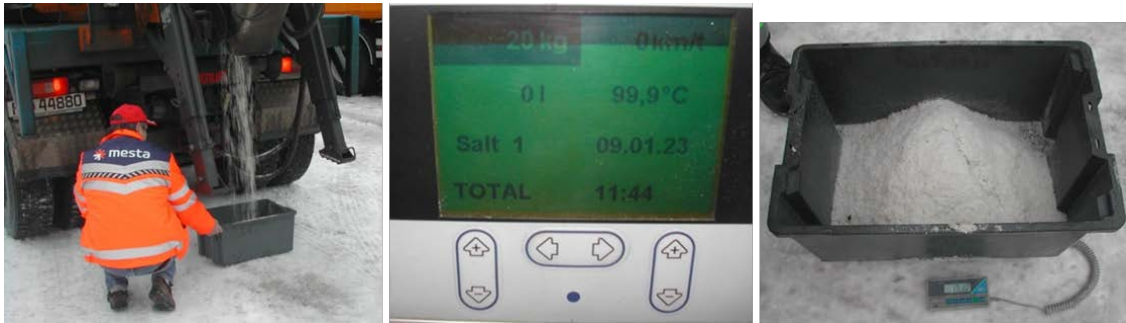
Figur 6-22 Kontroll/kalibrering av spredder med oppsamling og veiing
