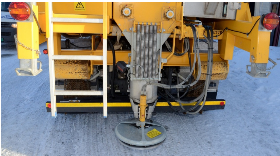
Figur 6-2 Tallerkenspreder. (Foto: Tor-Arvid Austråt Gundersen, Statens vegvesen)
