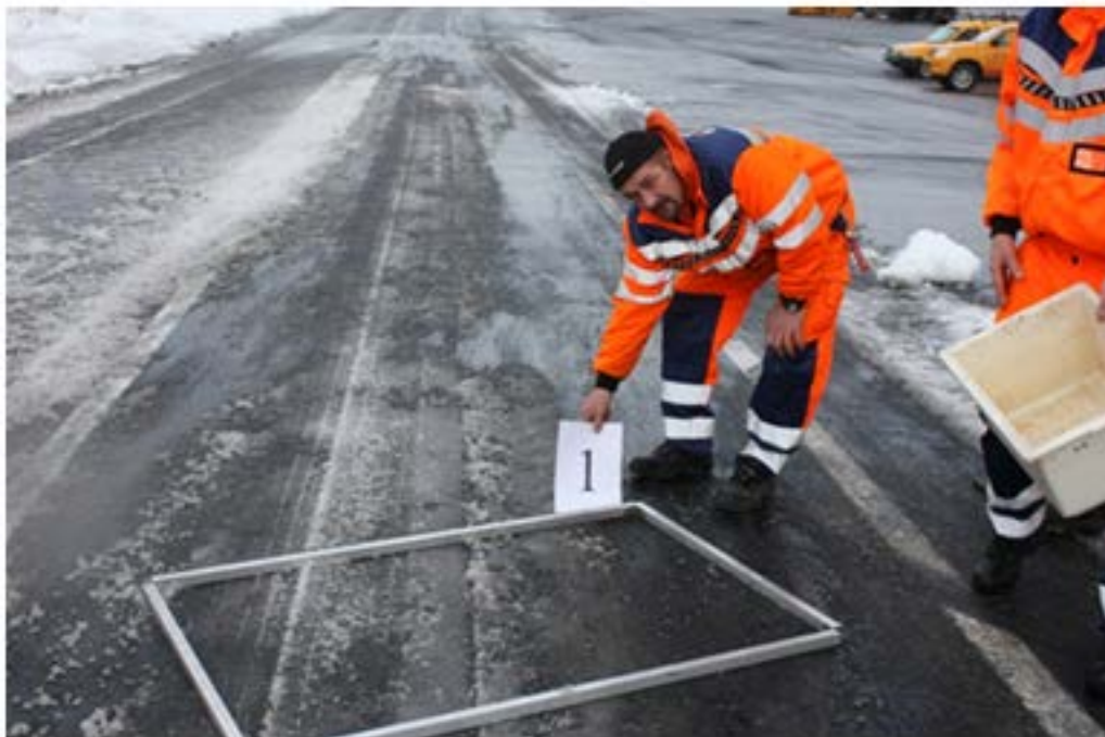
Figur 4-58 Mengde snø før og etter tiltak ved brøyting i 60 km/t. Mye snø/slaps er ikke fjernet. (Foto: Statens vegvesen)
