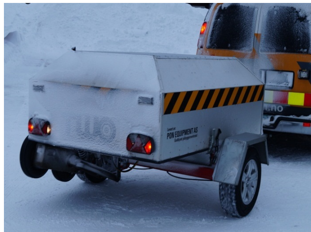
Figur 5-16 TWO-friksjonsmåler, hengerversjon. (Foto: Bård Nonstad, Statens vegvesen)
