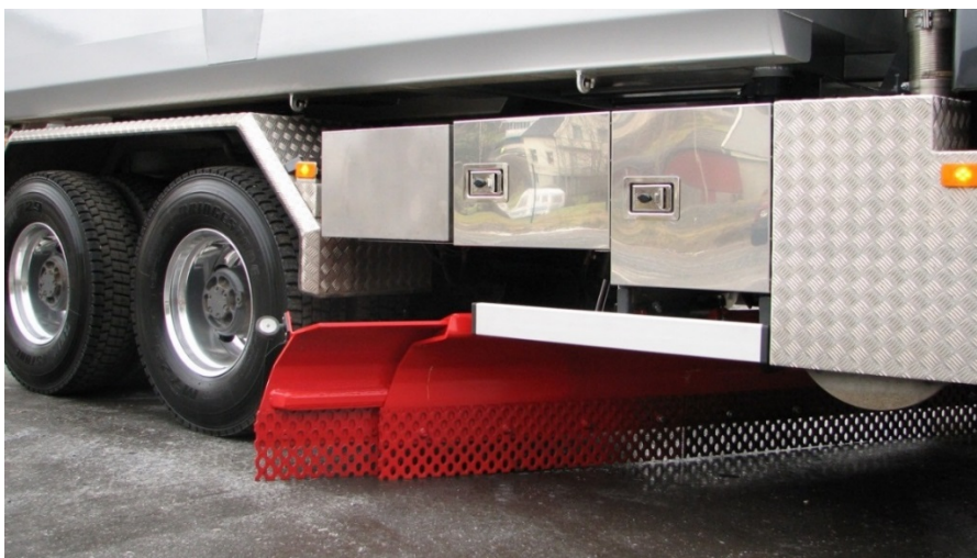
Figur 4-34 Underliggende skjær (Foto:Tellefsdal AS)
