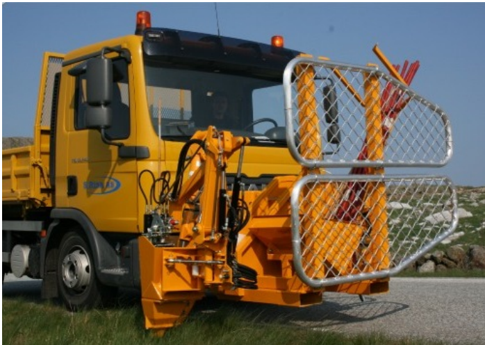
Figur 9-32 Utstyr for oppsetting av brøytestikk montert på lastebil (Foto: S. Risa AS)
