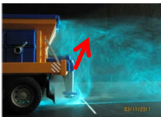
Figur 6-26 Vertikale luftstrømmer bak en lastebil i fart.
