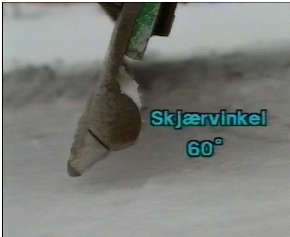
Figur 4-77 Riktig skjærvinkel med hardmetallstift (System 2000)
