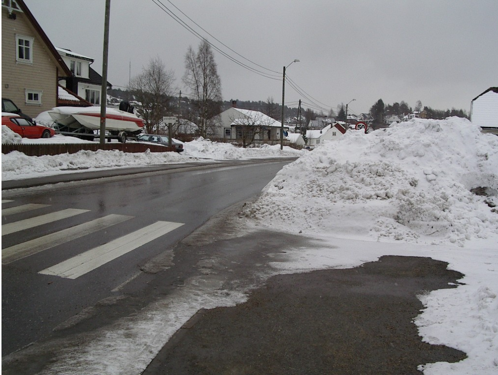
Figur 2-47 Plassering av snø i siktsonen etter at fortauet er brøytet (Foto: Arild Nærum)
