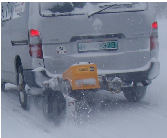
Figur 5-15 TWO-friksjonsmåler, rammemonteret. (Foto: Bård Nonstad, Statens vegvesen)
