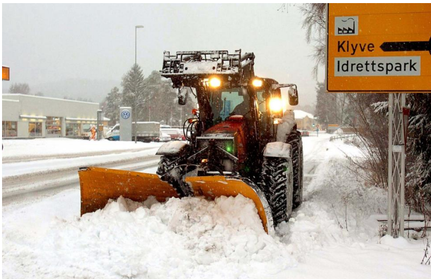
Figur 2-74 Eksempel på høyt monterte arbeidslys (Foto: Tore Svarverud, Varden.no).
