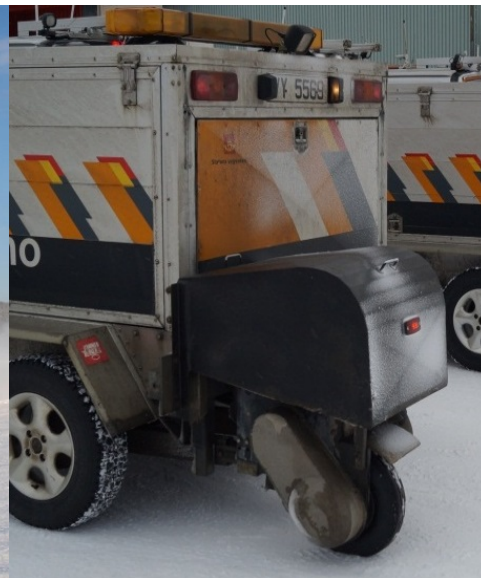
Figur 5-14 Friksjonsenhet på RoAR5 med standardisert måledekk. (Foto: Bård Nonstad, Statens vegvesen).
