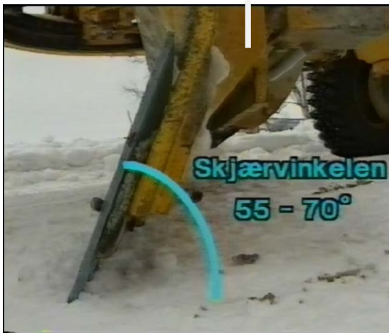
Figur 4-76 Riktig skjærvinkel mellom høvelskjær og underlag
