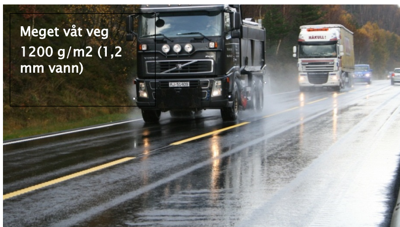
Figur 8-10 Ulike vannmengder på vegen. (Foto: Statens vegvesen)
