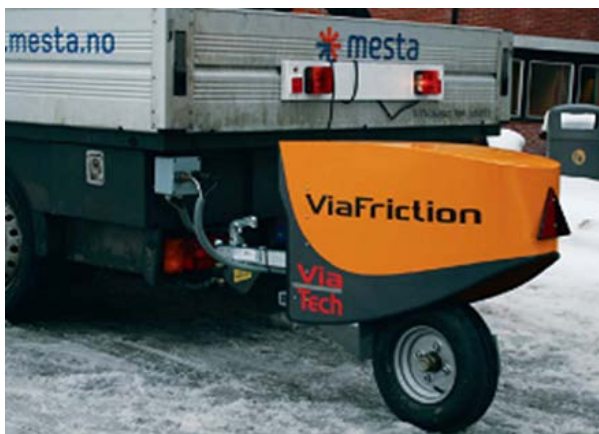
Figur 5-17 ViaFriction-friksjonsmåler, rammemonteret. (Foto: ViaTech)
