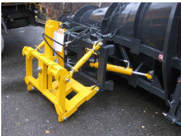
Figur 4-26 Diagonalplog med hydraulisk skråstilling (Foto: GMI)
