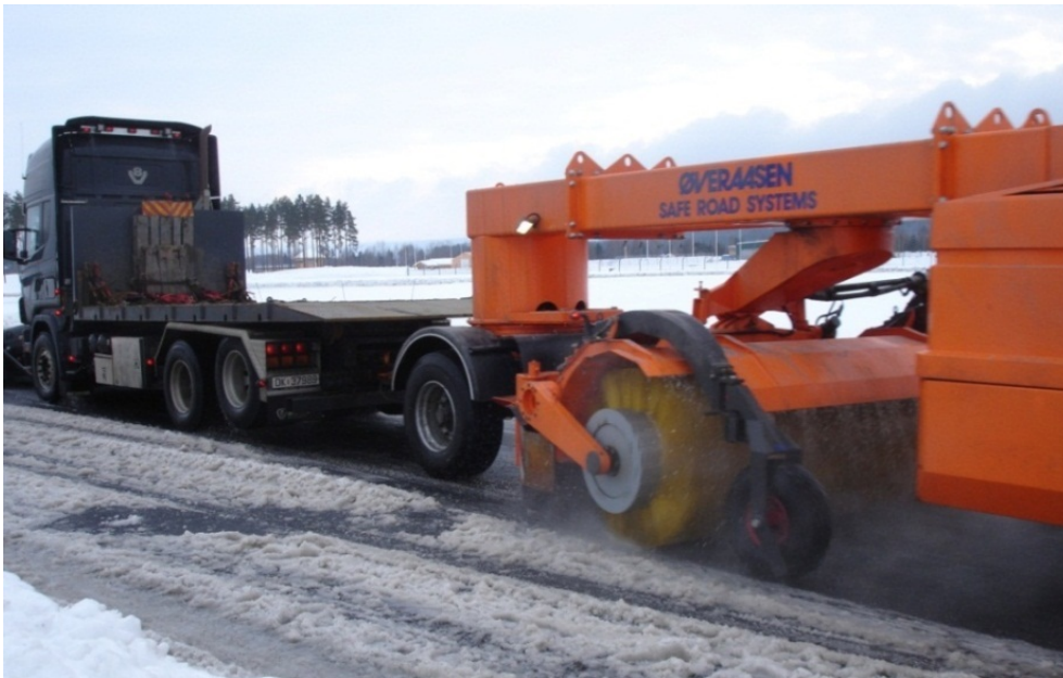
Figur 4-43 Etterhengende vegsweeper (motordrevet kost) (Kilde: Øveraasen)
