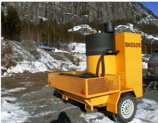
Figur 9-17 Bassøe tineutstyr med tilhengerunderstell (Foto: Glomsrød Mek. Verksted)
