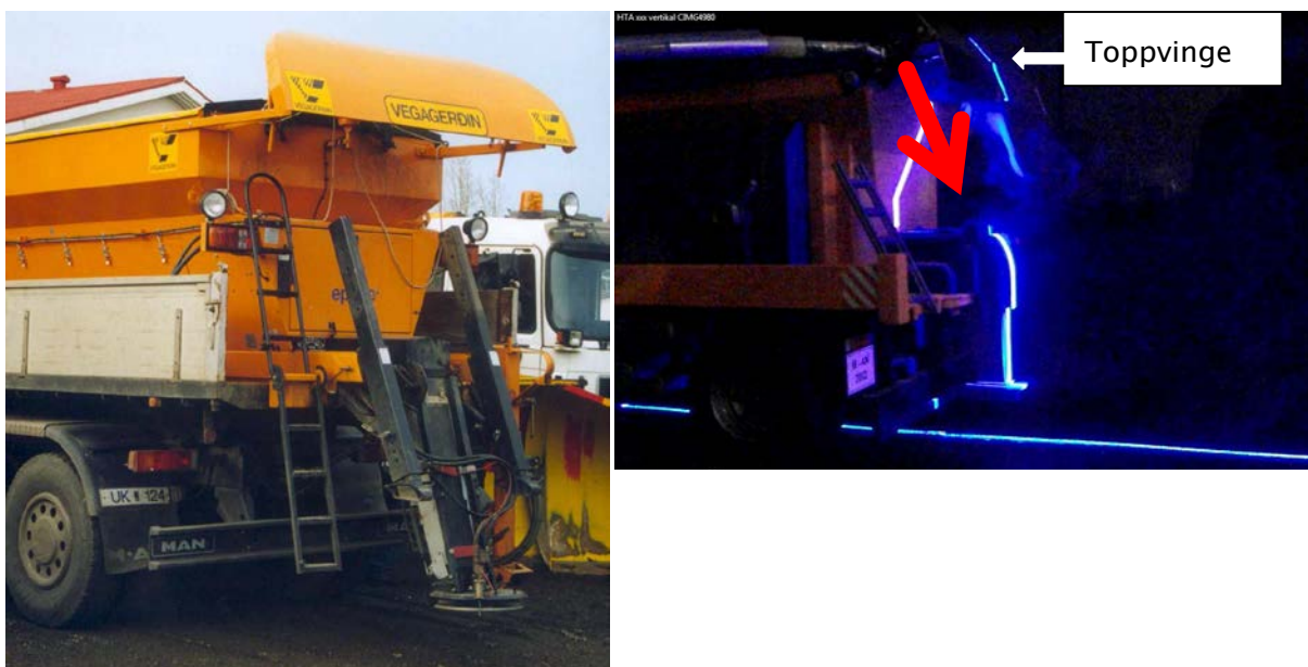
Figur 6-27 En toppvinge (spoiler) vil kunne redusere luftstrømmen opp bak bilen.
