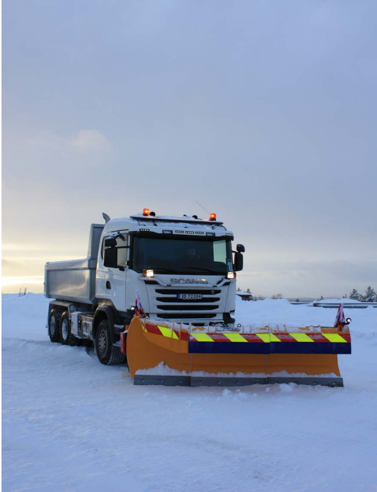
Figur 4-27 Kombinasjonsplog (Foto: Øveraasen )
