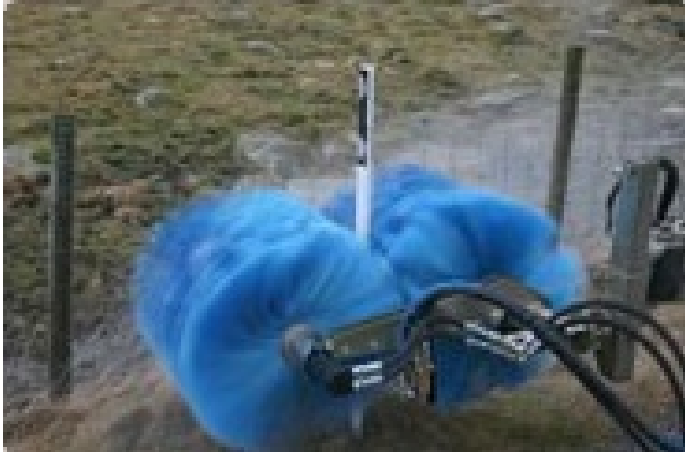
Figur 9-29 Utstyr for vasking av kantstolper (Foto: S. Risa AS)
