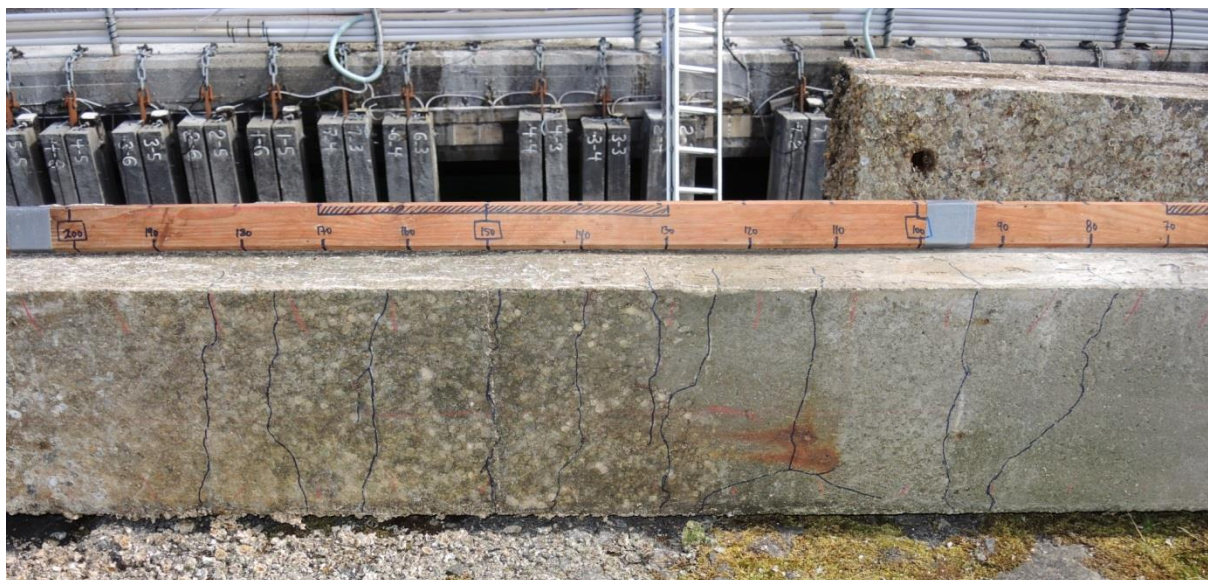
Armerte bjelkeelement med riss eksponert i tidevannssonen i 16 år, foto: Claus K. Larsen
