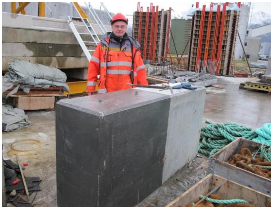
Martin Gedra fra Region midt ved det store prøveelementet, etter avforming og påføring av hydrofobere impregnering (halve elementet). Foto: Eva Rodum
