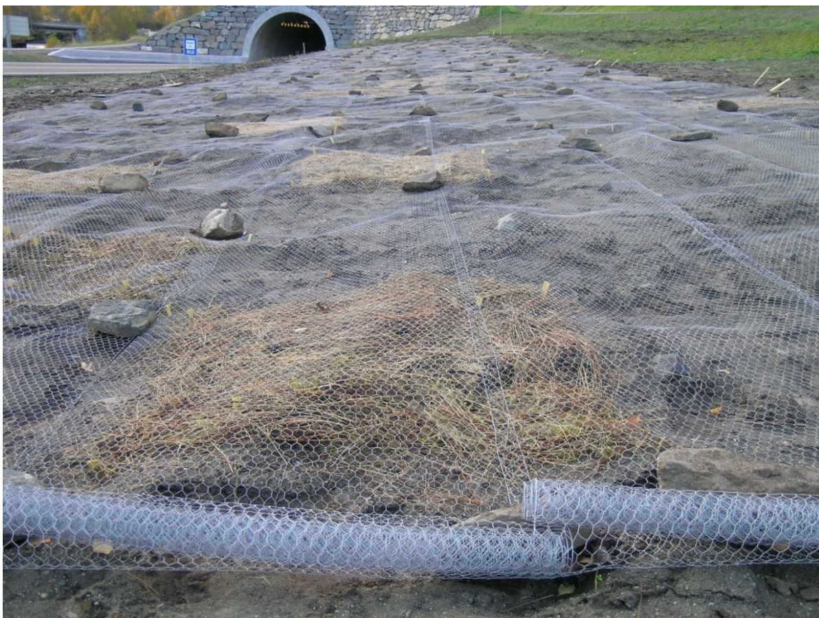
Figur 5. Forsøksfeltet ved etablering 24. september 2004. De fire ulike behandlingene (Hard Høy, Lett Høy, Såing og Naturlig) ble påført ruter i alle de fem blokkene. Totalt ble 80 ruter merka opp og dekkta med hønsenetting for å hindre at høyet og frøene skulle blåse vekk (KR).
