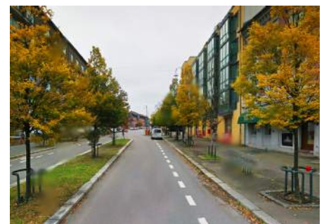
Selvforklarende gateanlegg: gaten forandrer karakter i overgang mellom Ring 2 og St.Halvardsgate, ved Galgeberg i Oslo. (Foto: google)
