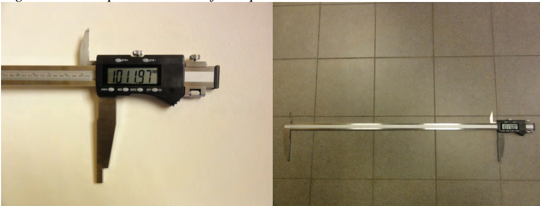
Figur A4: Det trengs ett skyvelære som kan måle opptil 1 meter.
