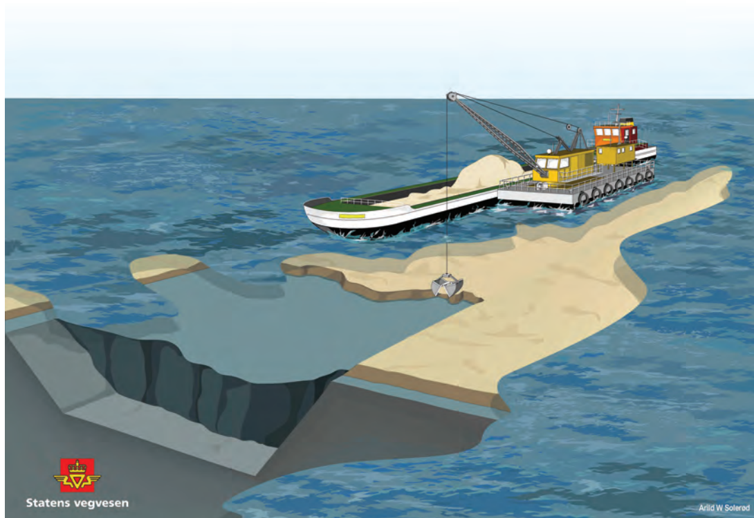
Figur 4.2.2 Prinsipp hvor lag med forurensede masser fjernes før mudring av rene leirmasser.
