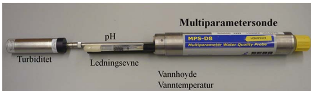
Bilde 5: Multiparametersonde (MPS-D8) som er benyttet på stasjonene for kontinuerlige automatiske målinger.
