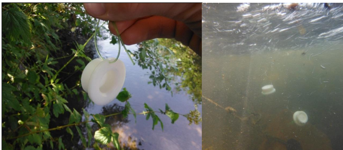
Figur 5. DGT'er ble brukt for analyse av As og utvalgte metaller i elva Vigga, 2014.
