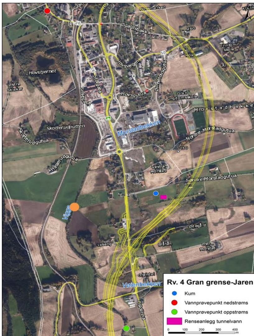
Figur 1: Plassering av målestasjonene oppstrøms (VO) og nedstrøms (VN) i Vigga, samt plassering av renseanlegg og utslippspunktet i Vigga. Gule linjer viser parsellen Rv4 Gran grense – Jaren, samt planlagte miljøgate gjennom Gran sentrum. Sørvendt påslag til Grantunnelen ligger høyre for markøren (rosa) som viser renseanlegget. Den oransje markøren viser utslippspunktet for rensset tunnelvann til Vigga (kart: Statens Vegvesen).
