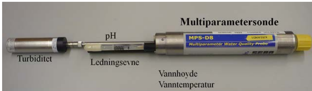
Bilde 3: Multiparametersonde (MPS-D8) som er benyttet på stasjonene for kontinuerlige automatiske målinger.
