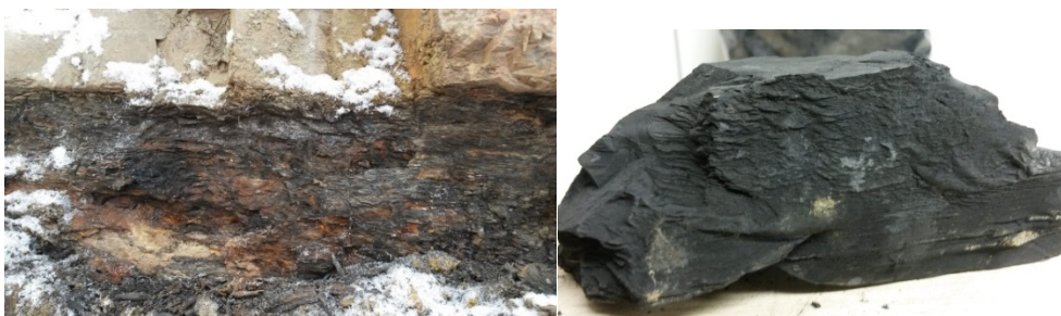
Figur 35. Venstre bilete: Eit skiferlag innimellom syenitten i skjeringa. Denne skiferen bar preg av forvitring. Ein del av denne skiferen blei sendt til våtkjemisk analyse, og viste svovelinnhald på 1200 mg/kg, noko som er relativt lite (0,12 % S). Det same pulveret blei også analysert med XRF, sjå «skifer 2» i tabell 14. Høgre bilete: Ein meir kompakt skifer som også var tilstades i skjeringa. XRF-målingar direkte på steinen viste svovelverdiar frå 7000 – 22 000 mg/kg.
