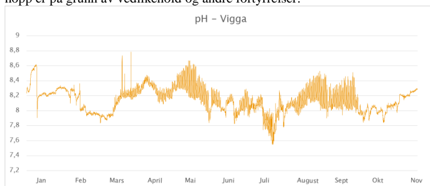
Figur 7. Registret pH i Vigga nedstrøms utslippspunktet under prøvetakningsperioden (januar- november 2014).
