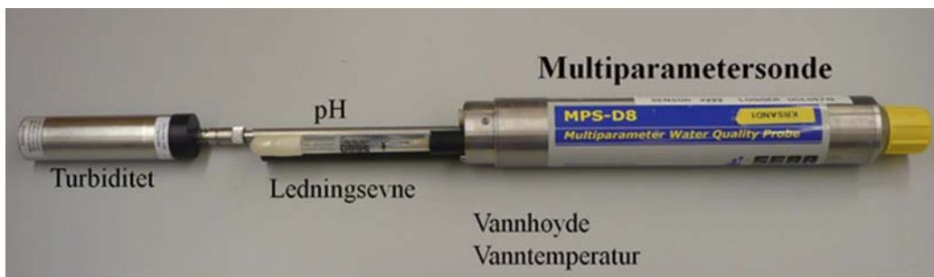
Figur 2: Multiparametersonde (MPS-D8) som er benyttet på stasjonene for kontinuerlige automatiske målinger.
