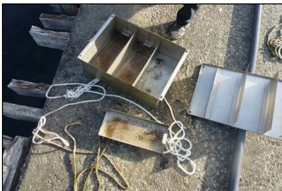
Figur 4. Sedimentfelle for rennende vann for prøvetakning av suspendert partikulært materiale.
