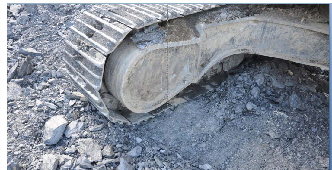
Figur 42: Skiferen har lav styrke. Den tåler ikke friksjonskrefter. Når den er fragmentert (sprengstein) vil den forvitte til finstoff i kontakt med fuktighet. Ved mekanisk påkjenning som vist i bildet knuses skiferen ned til en leiraktig suppe. Dette kan bl.a registreres ved at det er som å gå på en "gummimatte" på utsprengte masser.
