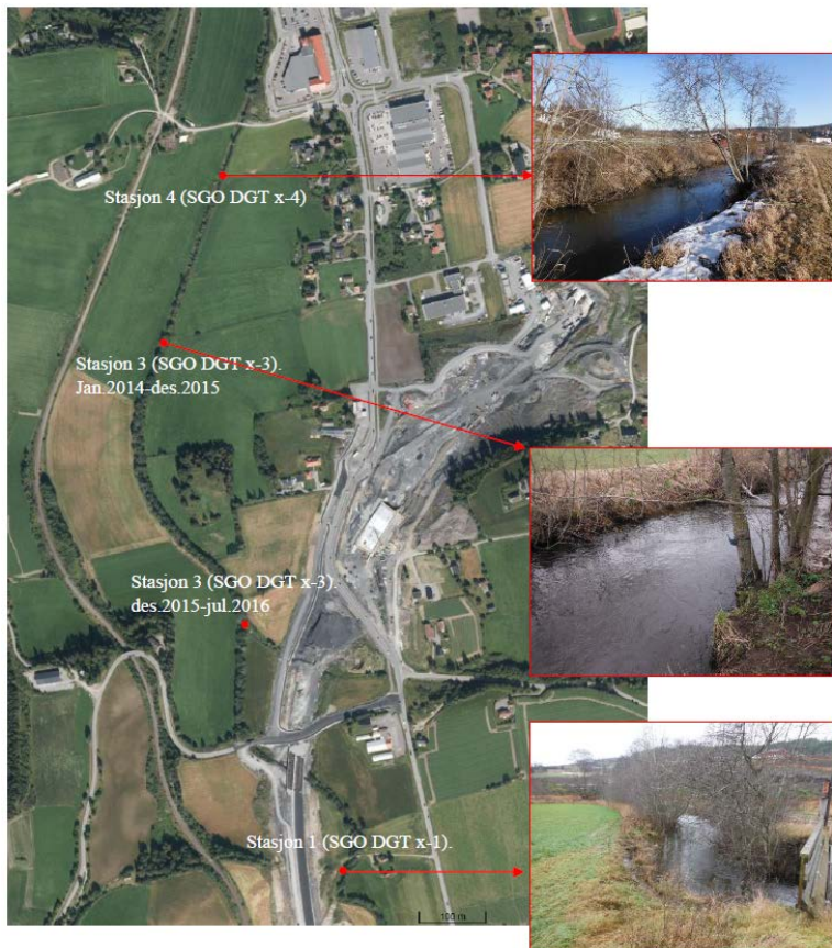
Figur 136. Oversikt over DGT-lokalitetar i Vigga gjennom anleggsperioden (COWI, 2016). Stasjon 3 blei flytta lenger opp i elva frå desember 2015, fordi det var nærmare utløpet frå tunnel og drensvatn til Vøienbekken.
