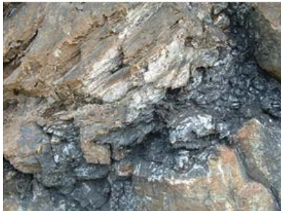
Figur 3. Alunskifer i felt. Øvre rad viser sterkt forvittra alunskifer ved det planlagde tunnelpåhogget nord for Gran nærme Horgenmoen. Nedre rad viser alunskifer og kalkstein (venstre) og eit borepunkt med opptak av kaks frå Nordtangenområdet (høgre): merk svart alunskifer og store mengder sterk mænaitt.
