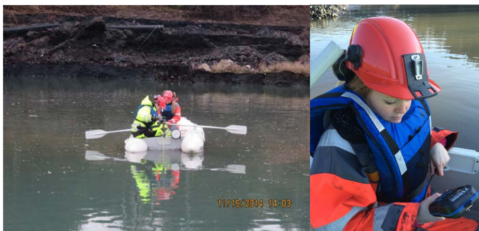
Figur 49. Måling av djupn til venstre og av vasskjemi (ORP, temperatur, pH og oksygenivå ved ulike djup), til høgre. Den handhalde målarer hadde ei rekkevidde på 10 meter.
