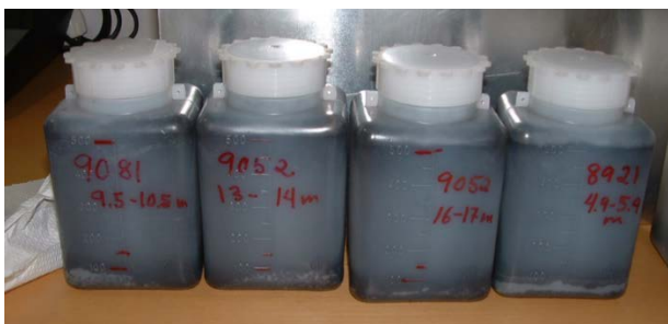
Figur 7. Statisk utlekkingsstest med 100 ml kaks (mestdelen 0 til 0,5 mm) fylt til 500 ml med springvatn. Flaskene på bildet var alle alunskifer.
