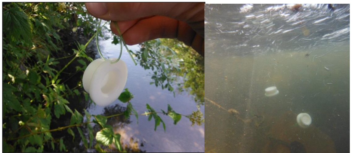
Figur 5. DGT'er ble brukt for analyse av arsen og utvalgte metaller i elva Vigga, 2014.
