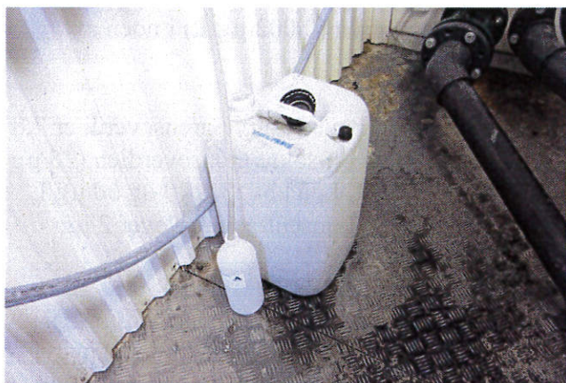
Figur 5. Viser dunk som samler opp uttak fra rensert vann som pumpes ut gjennom en hel uke. Frekvensen til uttaket er styrt av mengde vann som pumpes ut. På dette bildet tas en stikkprøve av vannet, og derfor går slangen med rensert vann ned til et prøveflasker ved siden av.
