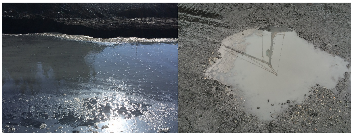
Figur 98. Biletet til venstre er frå masselageret og biletet til høgre viser ein pytt utanfor tunnelpåhugget i nord. Belegg på vassoverflata var eit tydeleg teikn på at vatnet var i kontakt med massar med ein kjemi tilsvarande alunskifer.
