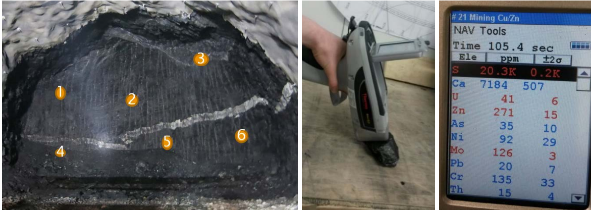
Figur 29. Framgangsmåte for prøvetaking av steinar frå tunnelstuppen. Grunnstoffa med tilhøyrande konsentrasjonar kom opp på XRF-skjermen etter kvart som dei blei analyserte. Ved å legge inn grenseverdiar for visse grunnstoff, kom konsentrasjonane opp med raud farge på skjermen ved overskriding.
