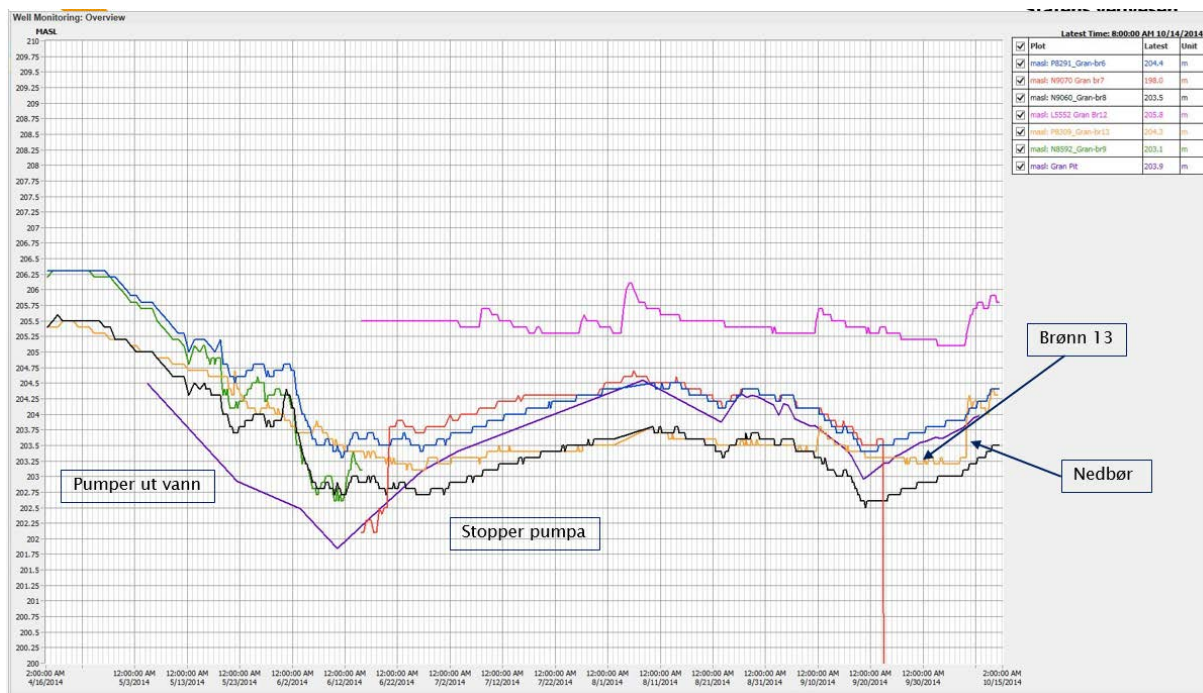
Figur 45. Overvakinga av grunnvatn i brønner og vasstand i byggegrop under anlegg. Målingane viser at vasstanden i byggegropa og i brønnane rundt raskt blei reetablert etter at pumpa blei slått av. Hoppet i brønn 13 er skulda nedbør. Plasseringa av brønnane er vist i figur 15.
