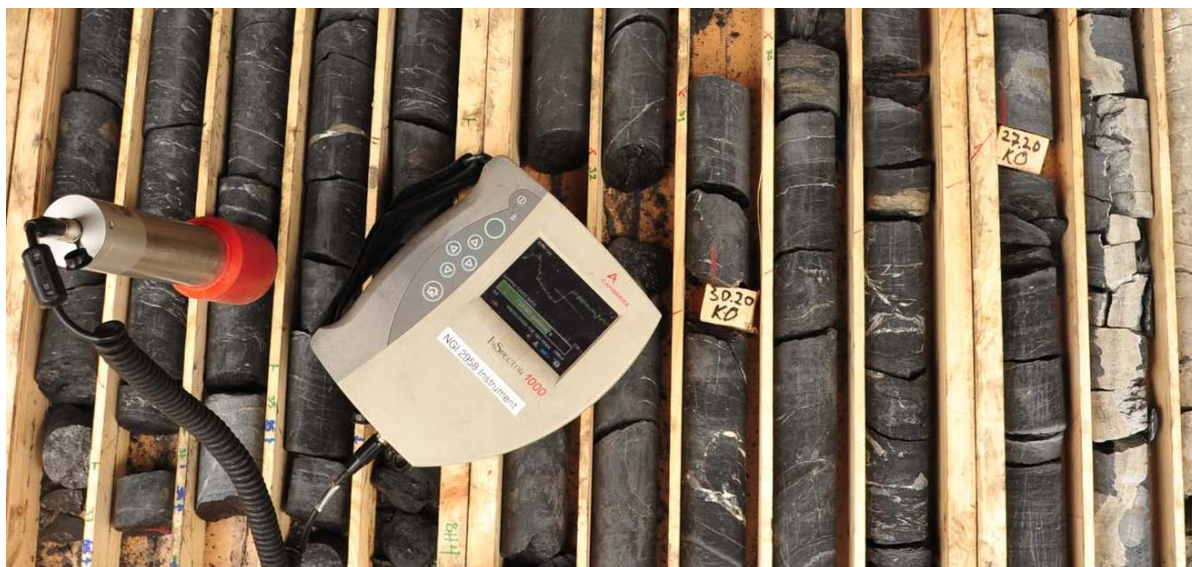
Figur 42. Gammamålingar på kjernemateriale frå forundersøkingane (Foto: Erik Endre).
