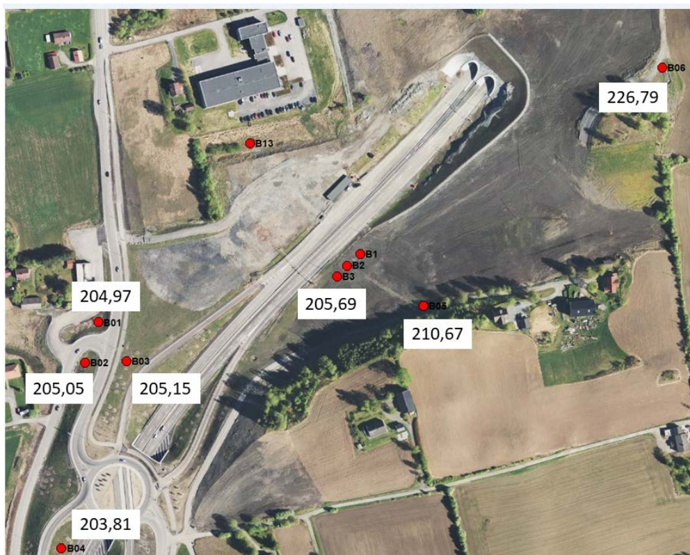
Figur 120. Registrering av grunnvasstand i overvaksingsbrønnar i (B3) og tilgrensa områder til masselageret.
