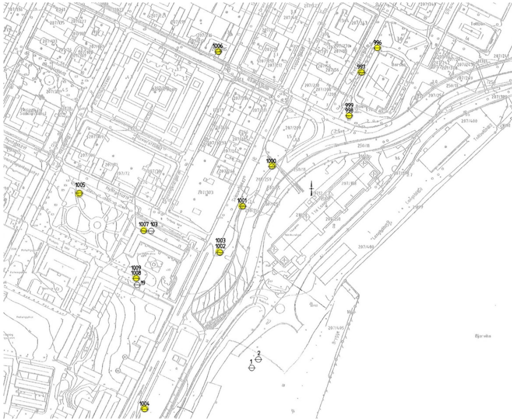
Figur 37: Plassering av poretrykksmålere
