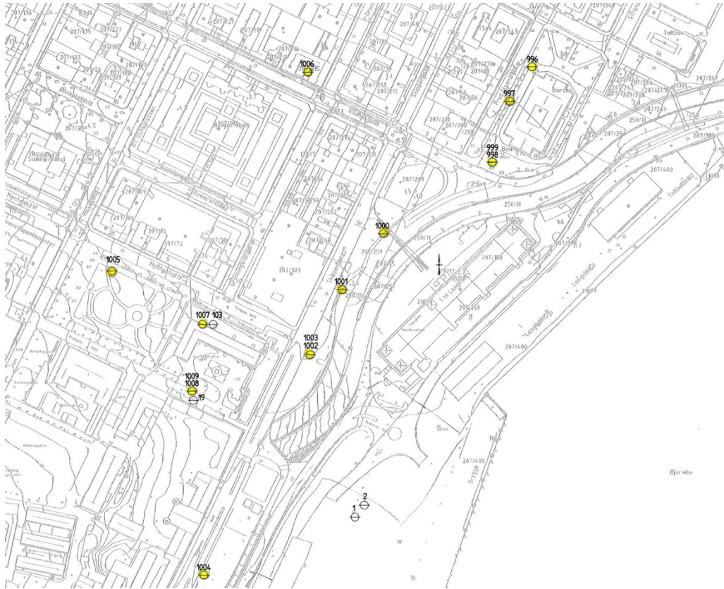
Figur 83: Plassering av poretrykksmålere
