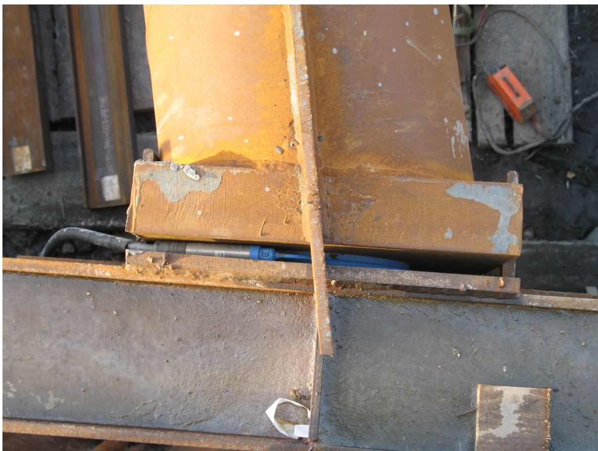
Figur 72: Montering av lastceller
