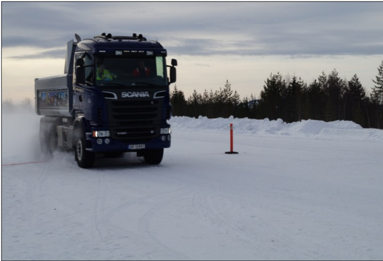
Figur 12. Kjøretøy passerer de røde kjeglene, sjåfør trækker bremsen helt i bunn.
