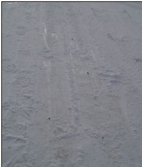
Figur 7. Snø- og isdekke som har blitt polert etter bremsing.
