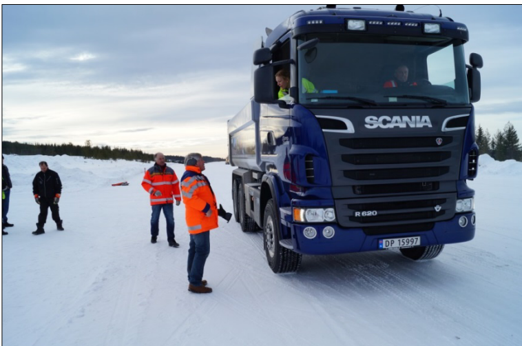
Figur 13. Når lastebilen stanser måles bremselengde. Manuell avlesning med målebånd brukes som supplement til GPS-målingene.
