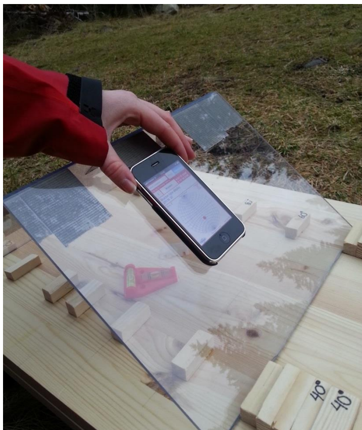
Figur 3: Samtidig måling av strøk og fall med smarttelefon.
