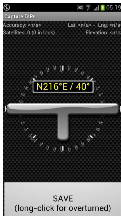
Figur 6: Skjermdump fra eGEO på Samsung GS3. Kompass-sirkelen hjelper brukeren å orientere enheten korrekt i forhold til strøket.
