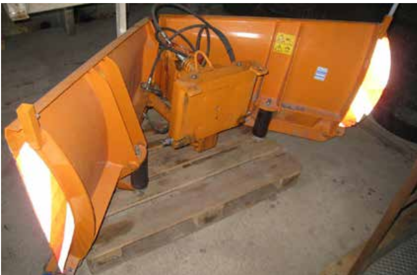
Figur 4-51 Eksempel på plog egnet for arbeid på gang- og sykkelveger
