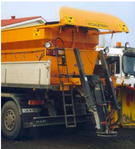
Figur 6-27 En toppvinge (spoiler) vil kunne redusere luftstrømmen opp bak bilen.
