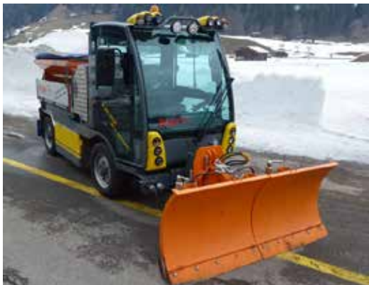
Figur 6-8 Eksempel på utstyr for gang- og sykkelveier med tallerkenspreader (sand/salt) og frontplog. (Foto: Dagfin Gryteselv, Statens vegvesen)
