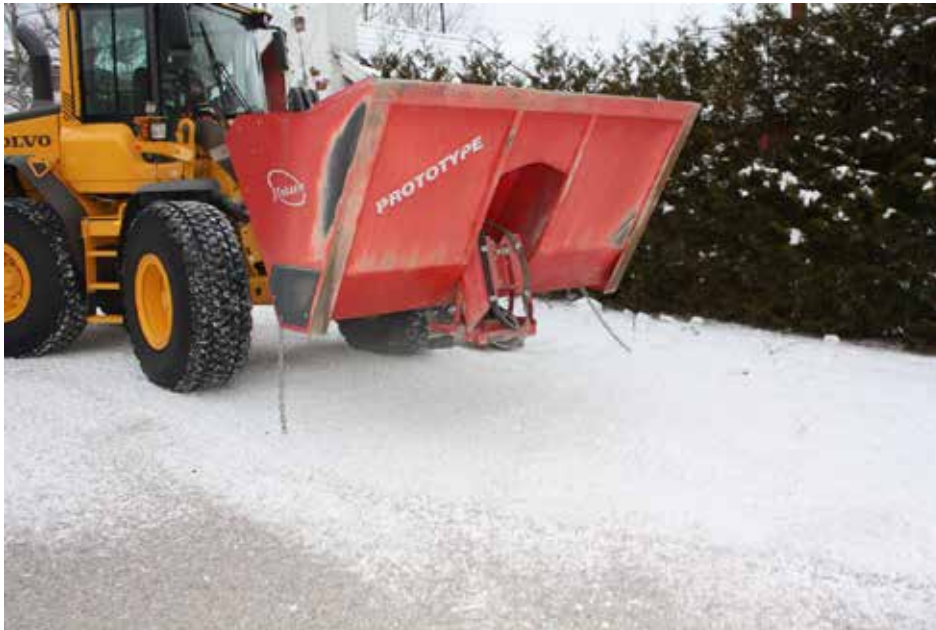
Figur 6-16 Eksempel på bærekjøretøy for sanding.
