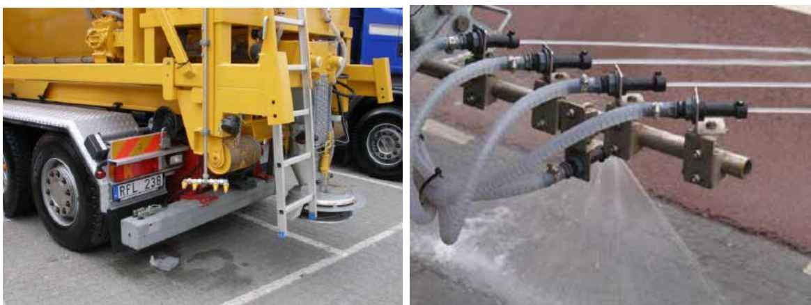
Figur 6-5 Strøpparat for høyhastighetsspredning (Foto: Falköping til venstre og Epoke til høyre).
