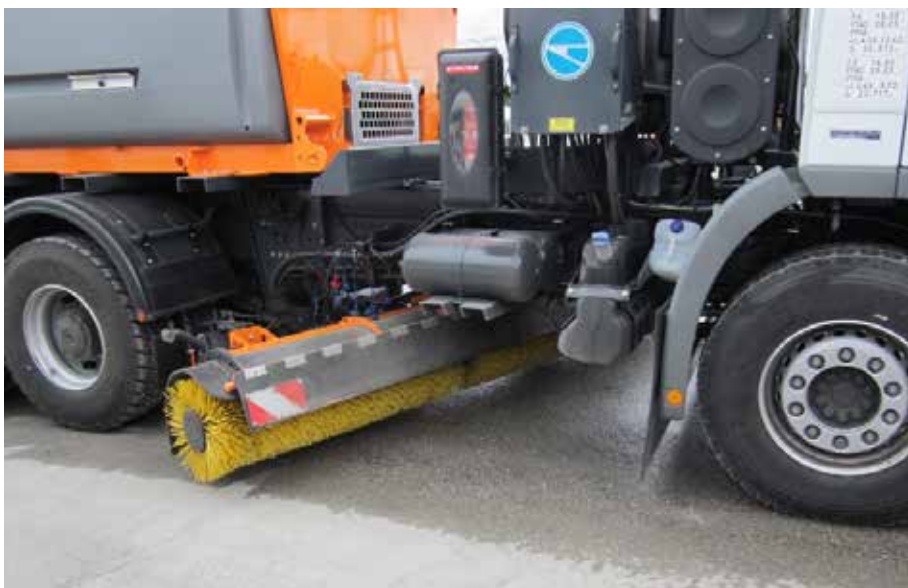
Figur 4-44 Underliggende kost (Gilletta) (Foto: Peder Tangen, Statens vegvesen)
