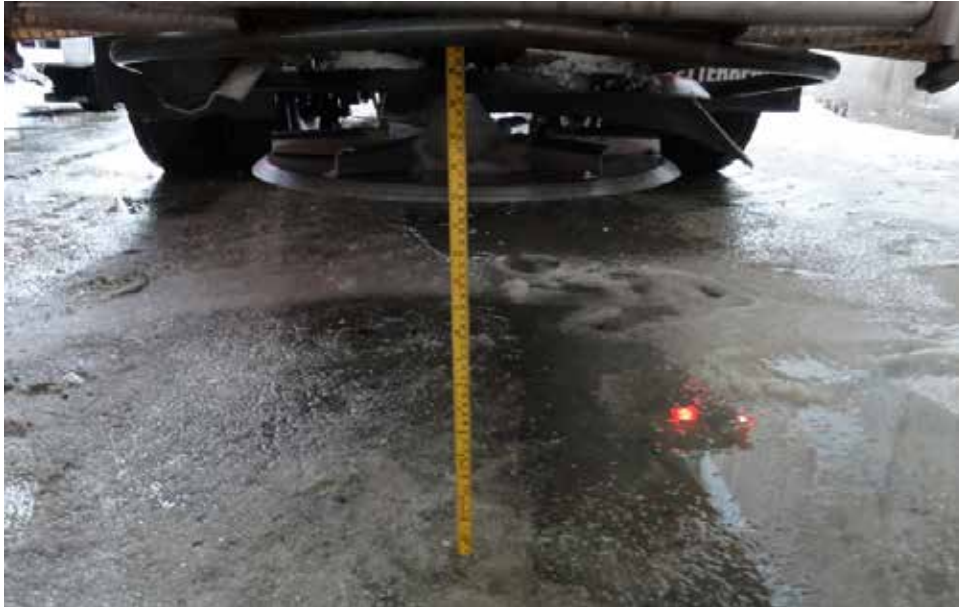
Figur 7-6 Måling av høyde på spredertallerken (Foto: Dagfin Gryteselv, Statens vegvesen)
