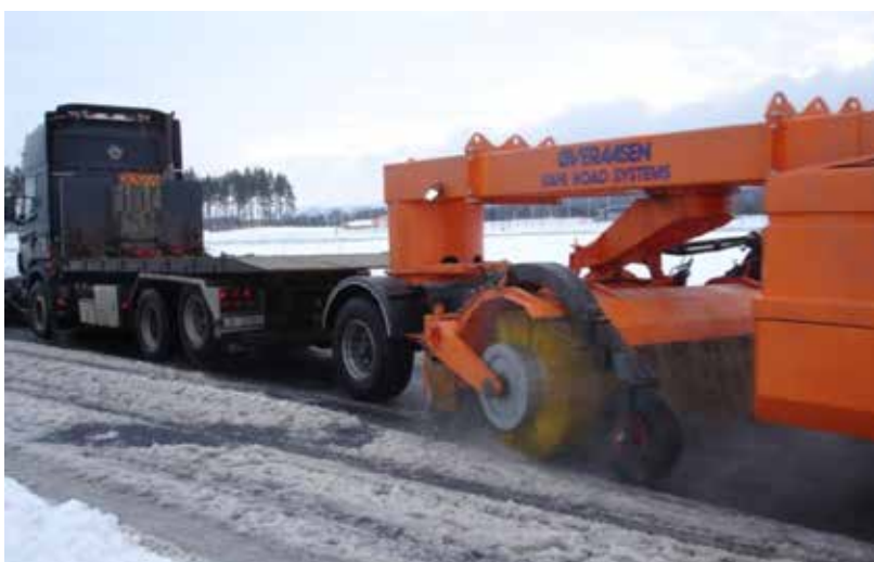
Figur 4-43 Etterhengende vegsweeper (motordrevet kost) (Kilde: Øveraasen)
