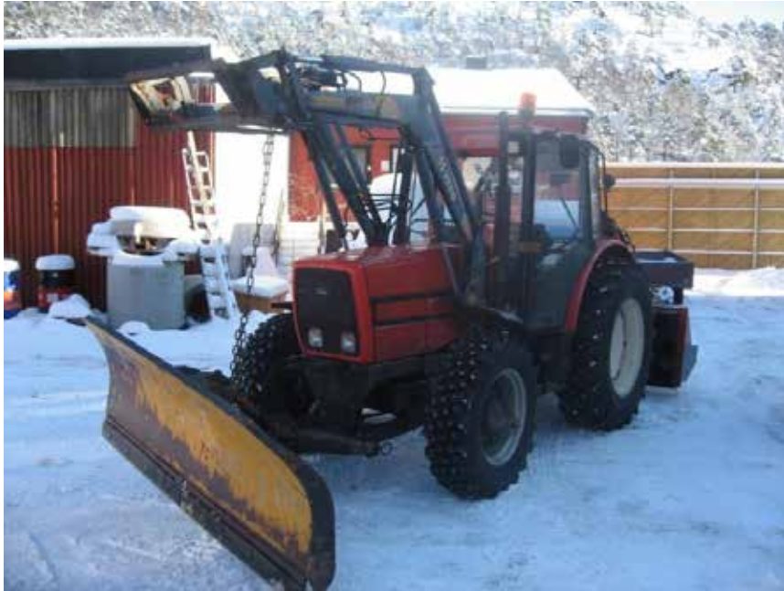
Figur 2-63 Lesseapparatet brukes til å heve og senke brøyteskjæret. Dette skaper ekstra blindsoner. (Foto: Jahn Ivar Systad)
