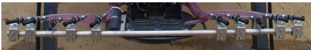
Figur 8-7 Spredning av saltløsning med tallerken eller dyser
