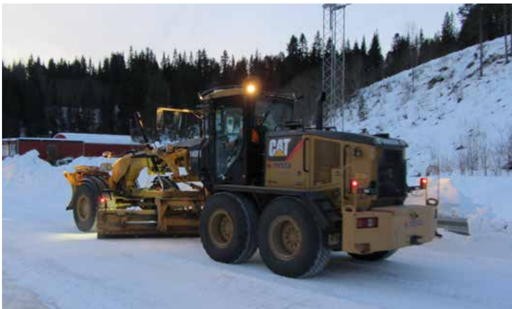
Figur 4-21 Veghøvel med isriverskjær og frontblad (Foto: Statens vegvesen)
