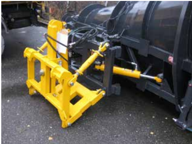
Figur 4-26 Diagonalplog med hydraulisk skråstilling (Foto: GMI)
