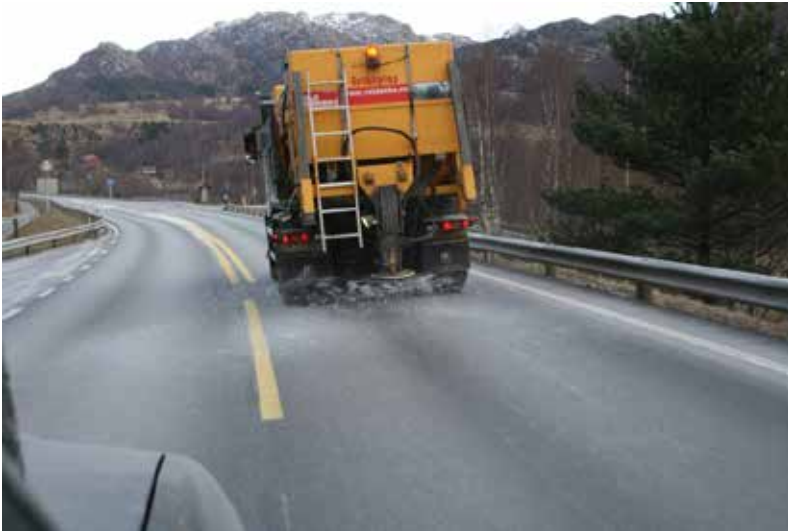
Figur 8-1 Salting på bar vegbane for å unngå rimfrost.
