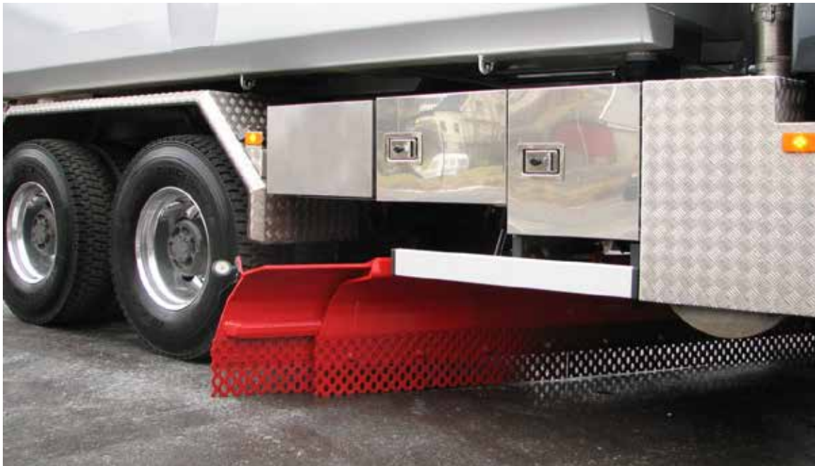
Figur 4-34 Underliggende skjær (Foto:Tellefsdal AS)
