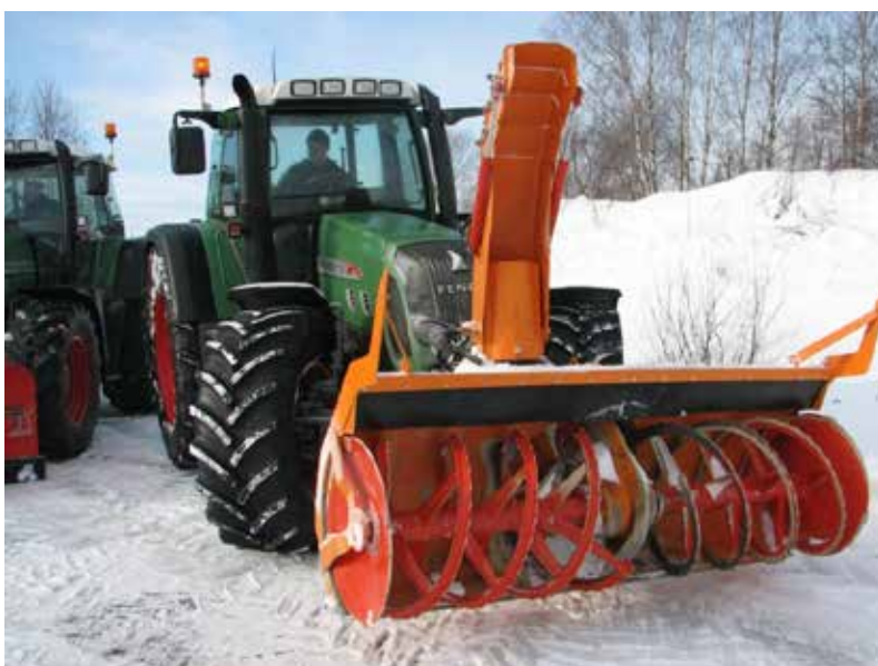
Figur 4-80 Frontmontert snøfres på traktor (Foto: Tellefsdal)
