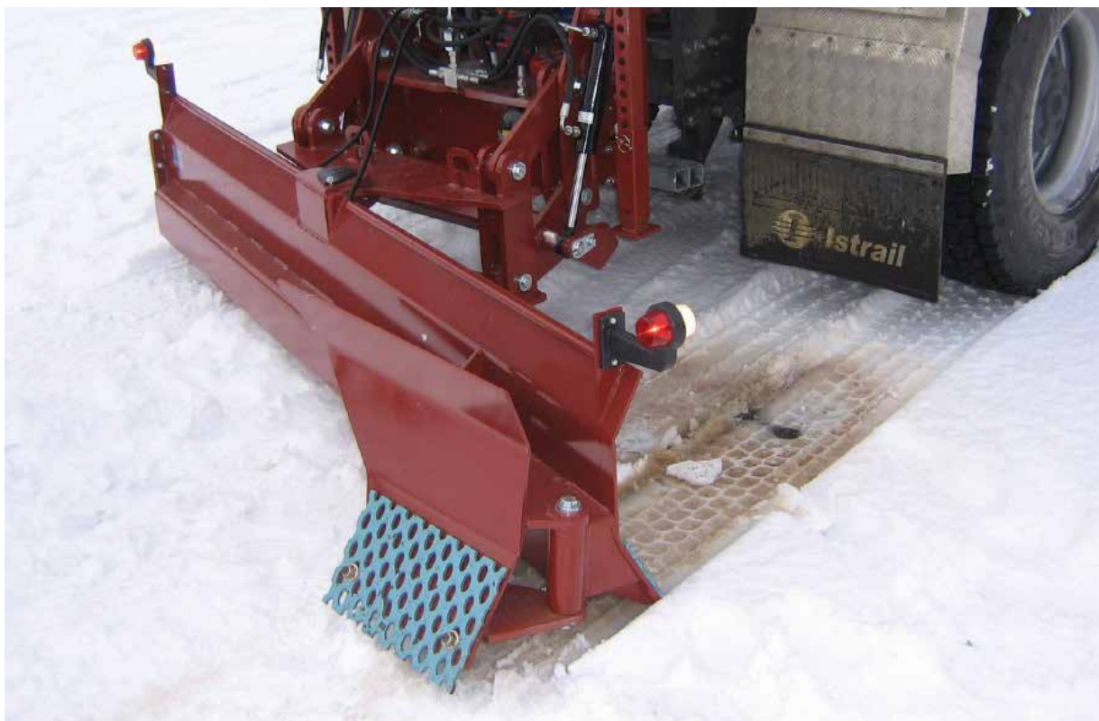
Figur 4-36 Bakmontert skjær på lastebil
