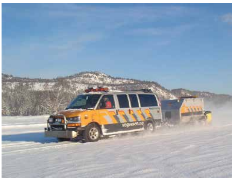
Figur 5-13 Friksjonsmåling på vinterføre med RoAR5. (Foto: Bård Nonstad, Statens vegvesen)
