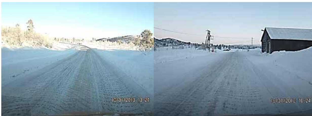
Figur 7-5 Varighet av fastsandmetoden på lavtrafikkert veg og stabile værforhold. (Foto: Stein Åsheim, Statens vegvesen.) (t.v.: etter utlegging, friksjon 0,49 i gjennomsnitt, t.h.: etter 6 døgn, friksjon 0,35 i gjennomsnitt. ÅDT ca. 500.)
