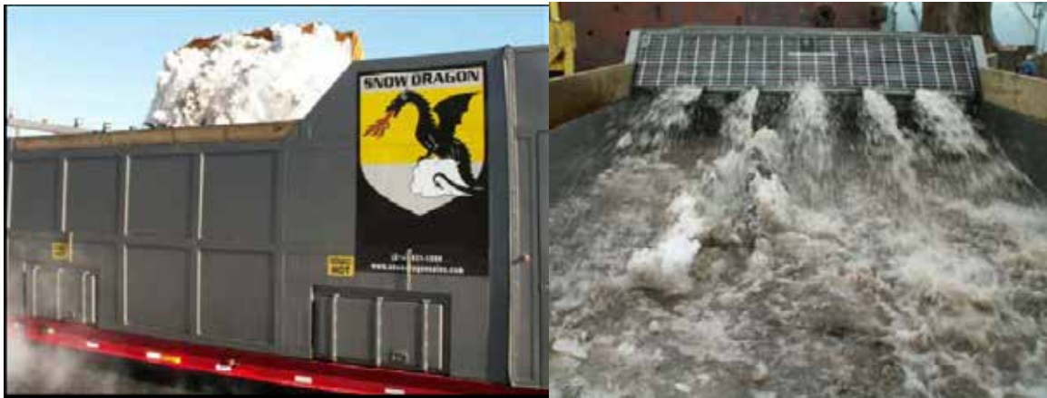
Figur 9-20 Snøsmelter (Foto: Veimas)
