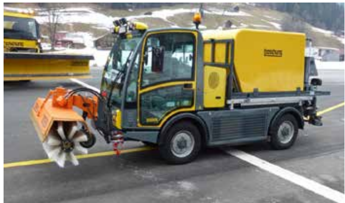
Figur 6-9 Eksempel på utstyr for gang- og sykkelveger med frontmontert kost og dysespreader. (Foto: Dagfin Gryteselv, Statens vegvesen)
