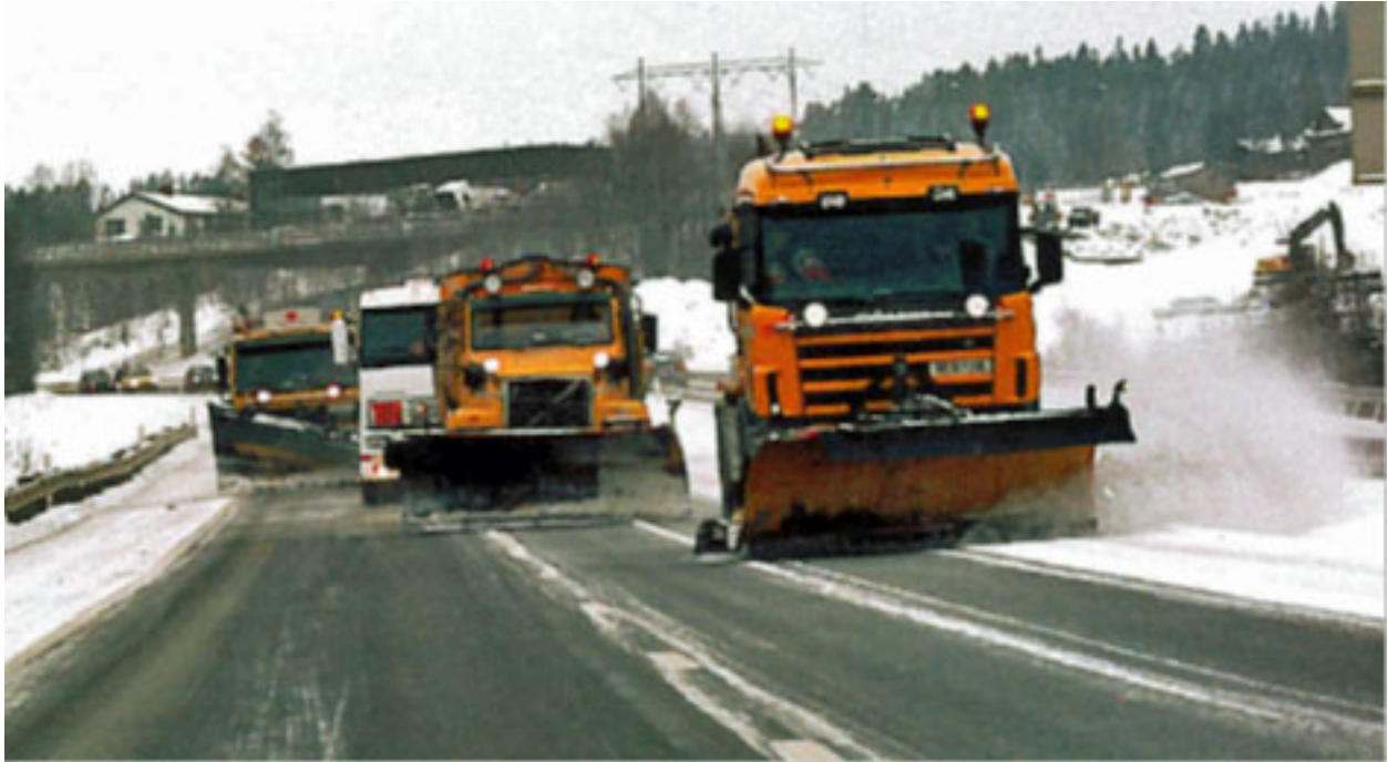
Figur 2-35 Tandembrøyting. Her ser vi også en utålmodig vogntogsjåfør (plogene på bildet er ikke merket i hht. dagens krav) (Foto: Statens vegvesen).
