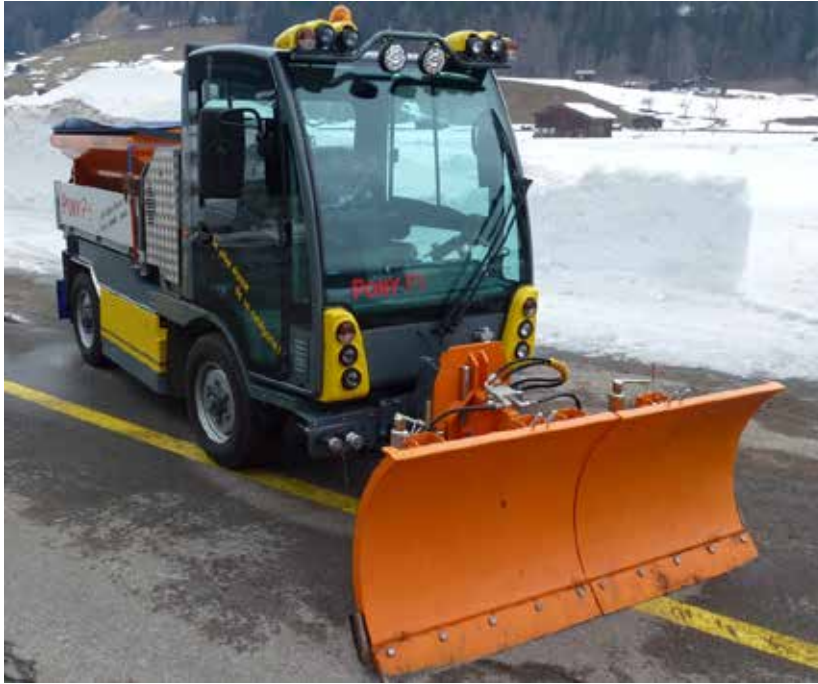
Figur 4-52 Eksempel på plog egnet for arbeid på fortau og gang- og sykkelveger (Foto: Dagfin Gryteselv, Statens vegvesen)
