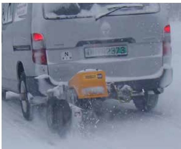
Figur 5-16 TWO-friksjonsmåler, rammemonteret. (Foto: Bård Nonstad, Statens vegvesen)
