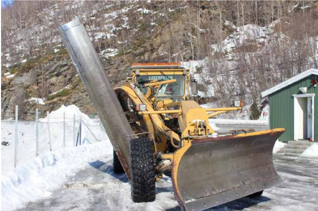
Figur 4-74 Høvel for nedtaking av snøkanter (Foto: Odd Dalmo, Statens vegvesen)
