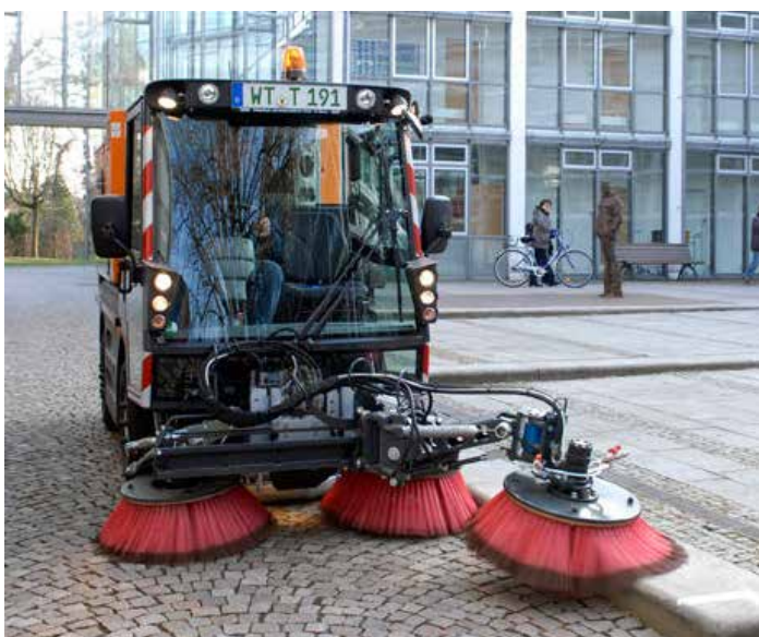
Figur 9-19 Utstyr for renhold av fortau, gang-/sykkelveger og plasser. PM10-sertifisert (Kilde: www.Aebi-Schmidt.no )
