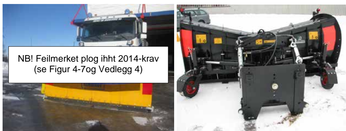
Figur 4-8 Merking av ploger (foran og bak), i samsvar med instruks
