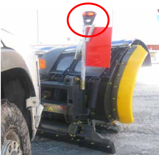
Figur 4-10 Markeringslys og merking bak på plog
