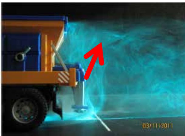
Figur 6-26 Vertikale luftstrømmer bak en lastebil i fart.
