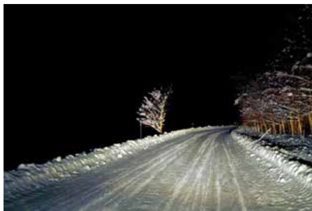
Figur 5-4 Friksjon på snøføre/tørr is, \mu \approx 0,15-0,30 . (Foto: Knut Opeide, Statens vegvesen)
