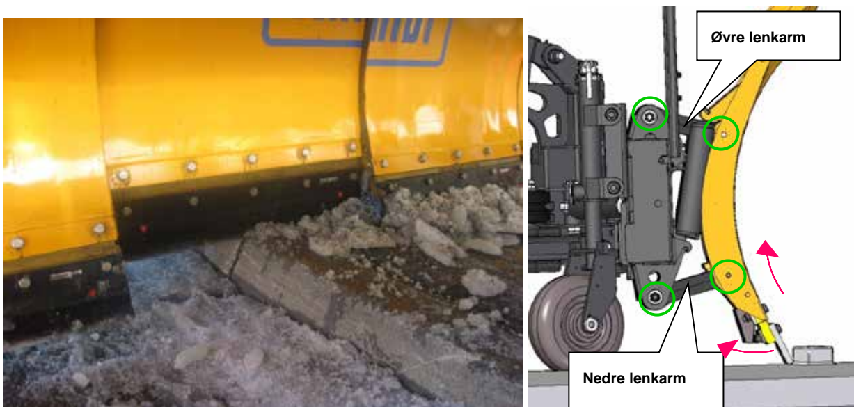
Figur 4-31 Bevegelige plogseksjoner på fortauskant (Kilde: Schmidt Norge AS)
