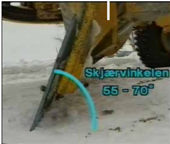
Figur 4-76 Riktig skjærvinkel mellom høvelskjær og underlag
