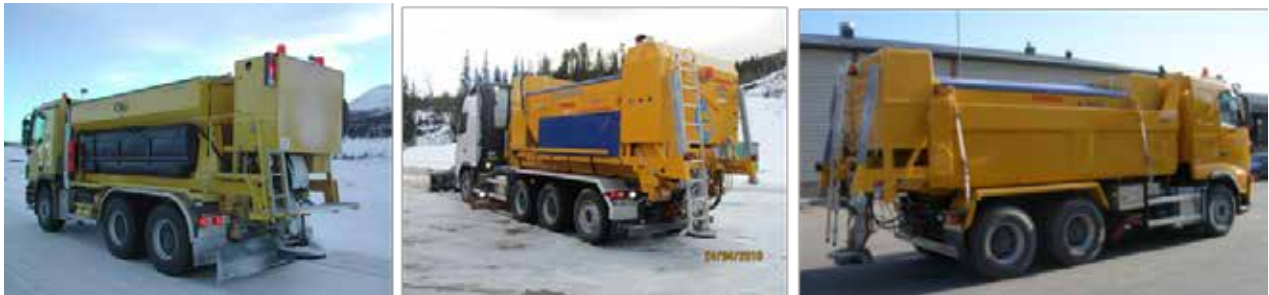
Figur 6-1 Rammemontert, krokløftmontert og planfastspent strøapparat. (Foto fra venstre: Torgeir Vaa, Anders Svanekil og Falköping).
