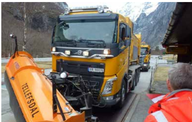
Figur 6-21 Veiging av kjøretøy før og etter strøing (Foto: Dagfin Gryteselv, Statens vegvesen)
