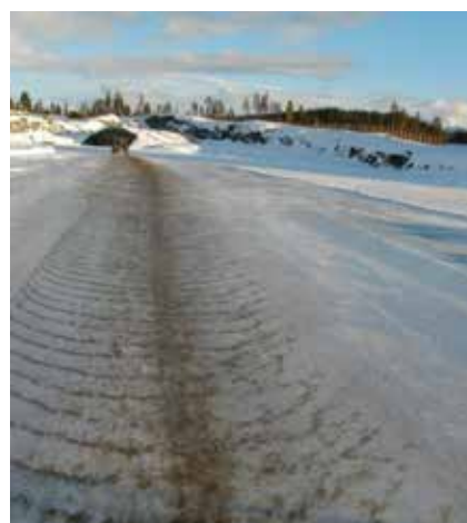
Figur 5-6: Fastsand på isdekke, \mu \approx 0,30-0,50 . (Foto: Giselle Jensen, Statens vegvesen.)
