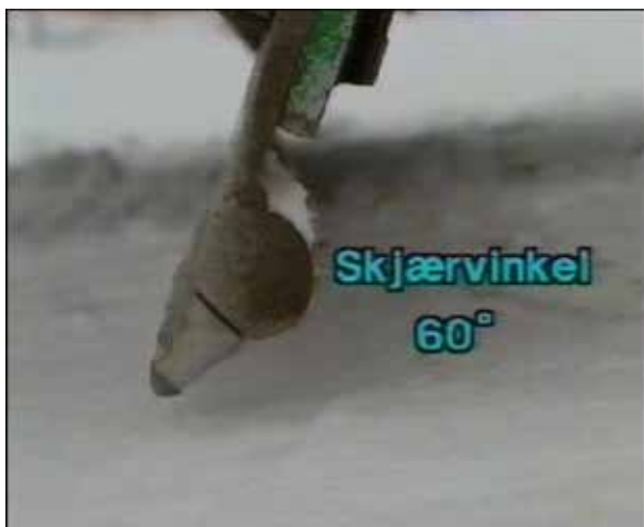
Figur 4-77 Riktig skjærvinkel med hardmetallstift (System 2000)
