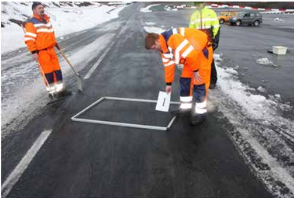
Figur 4-59 Mengde snø før og etter tiltak ved brøyting i 40 km/t. Det meste av snø/slaps er fjernet. (Foto: Statens vegvesen)
