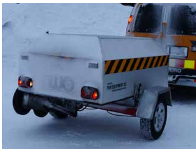
Figur 5-17 TWO-friksjonsmåler, hengerversjon. (Foto: Bård Nonstad, Statens vegvesen)
