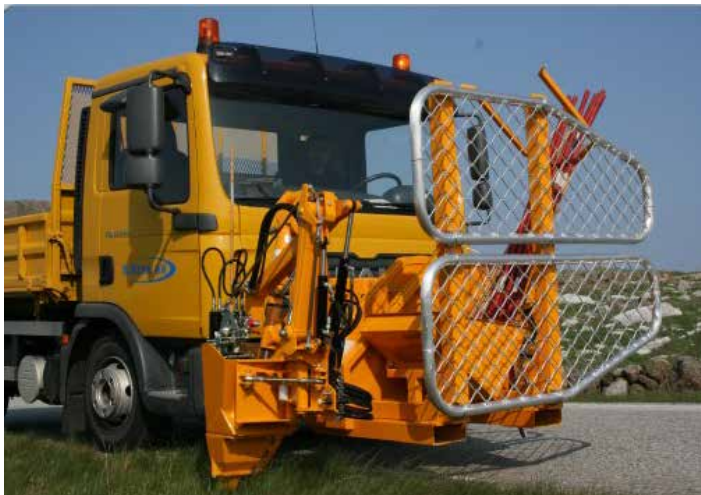
Figur 9-16 Utstyr for oppsetting av brøytestikk montert på lastebil (Foto: S. Risa AS)
