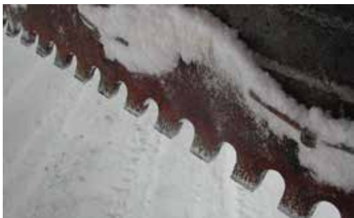
Figur 4-39 a) Isriverstål, tannet b) Hardmetallstift skjær (System 2000)
