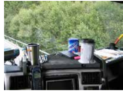
Figur 2-66 Gjenstander på dashbordet skaper blindsoner (de «grå armene» i figuren til venstre).
