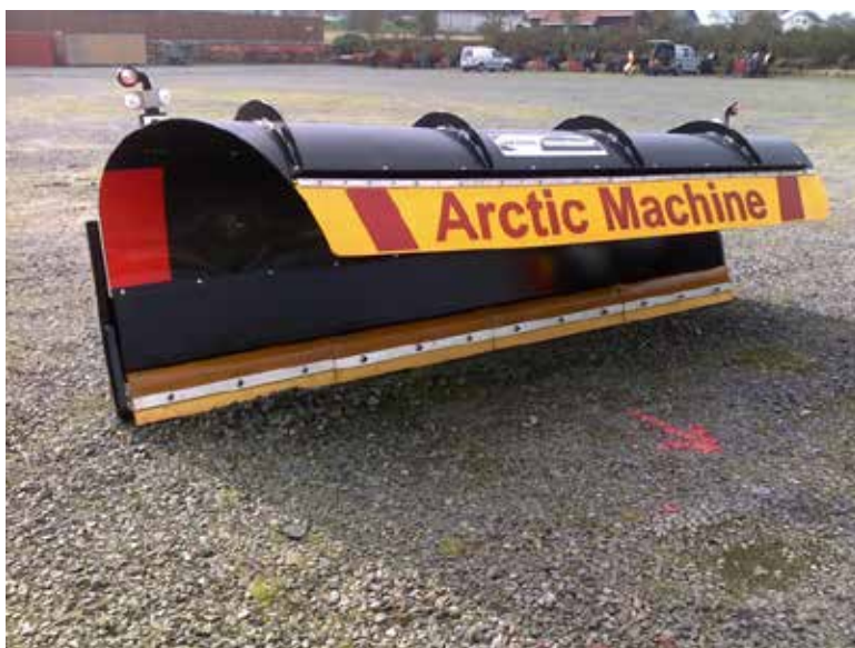
Figur 4-27 Kombinasjonsplog med plogblad av plastmateriale (ikke godkjent farge på framsiden) (Foto: Arctic Machine)
