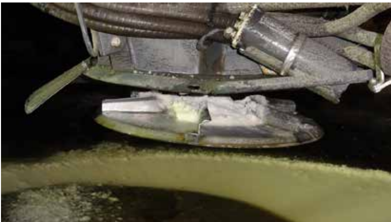
Figur 6-31 Strøttallerken må også sjekkes og rengjøres
