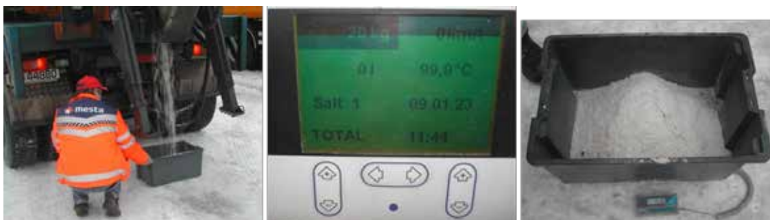
Figur 6-22 Kontroll/kalibrering av spredere med oppsamling og veiging
