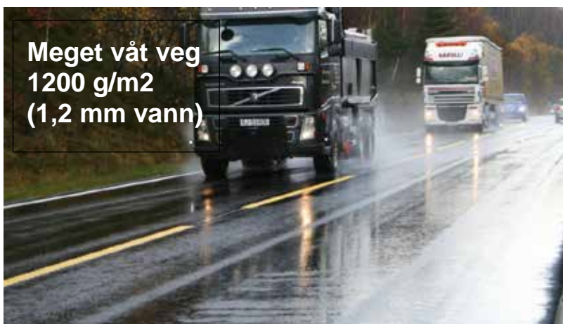
Figur 8-8 Ulike vannmengder på vegen
