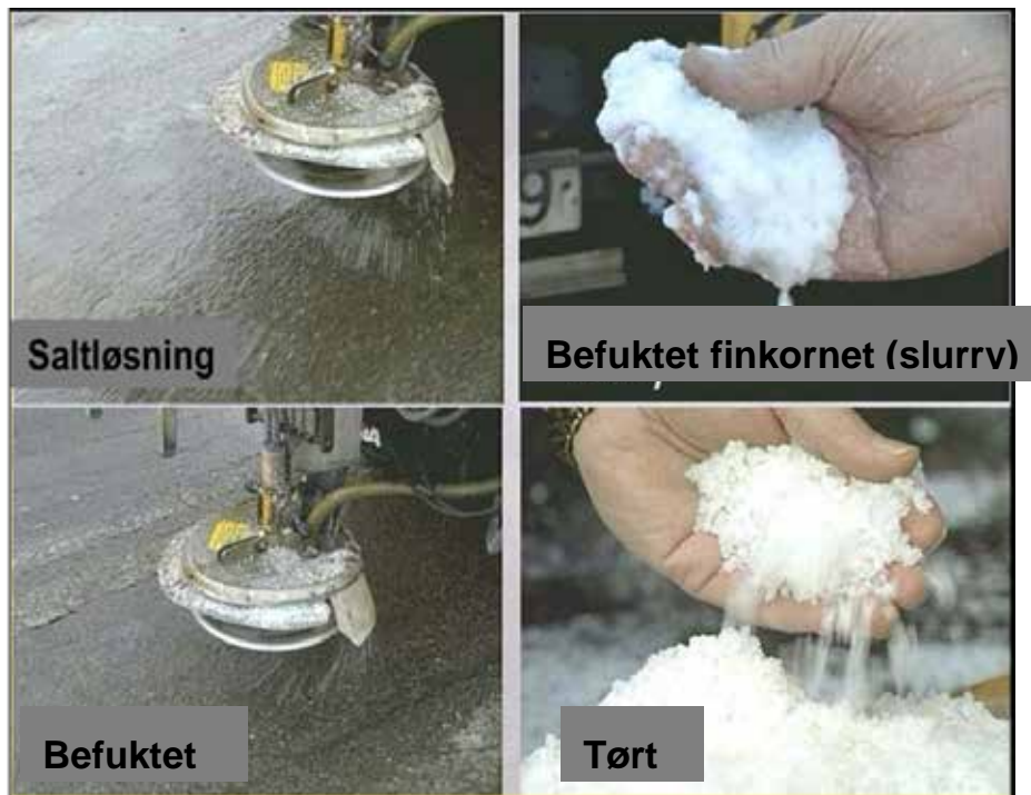
Figur 8-5 Spredemetoder for strøing med salt
