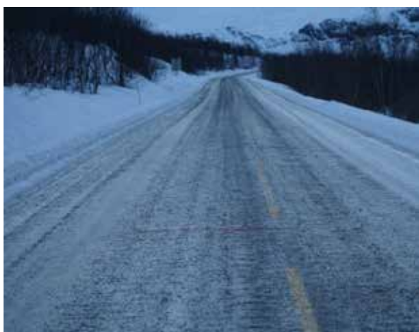
Figur 5-5 Friksjon på veg med isdekke strødd med sand, \mu \approx 0,25-0,35 . (Foto: Bård Nonstad)
