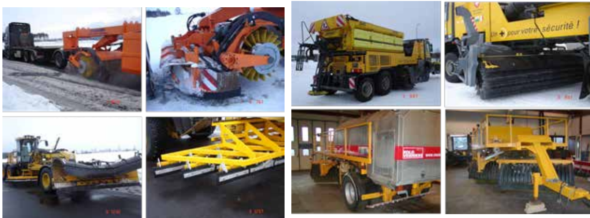
Figur 4-61 Spesialutstyr testet på Vålerbanen. RSS 200, Jet Broom, Slapsegrind montert på høvel og «Slapsekaren»
