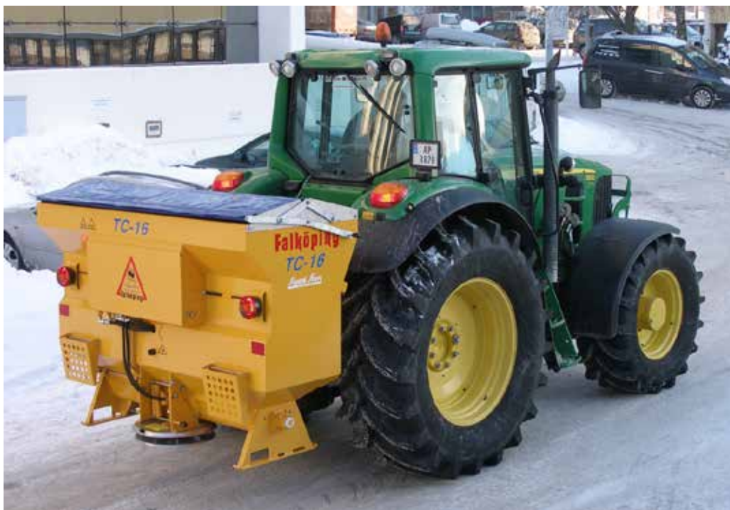
Figur 6-14 Bakmontert strøapparat for traktor. (Foto: Per Ingar Haug)
