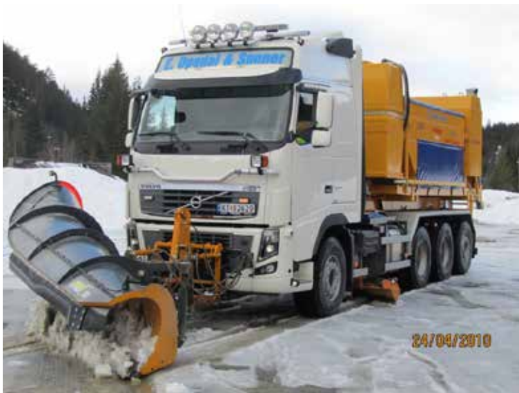
Figur 4-18 Fire-akslet lastebil utstyrt med diagonalplog, underliggende skjær og salt-/fastsandspreder (Foto: E. Opedal & Sønner)
