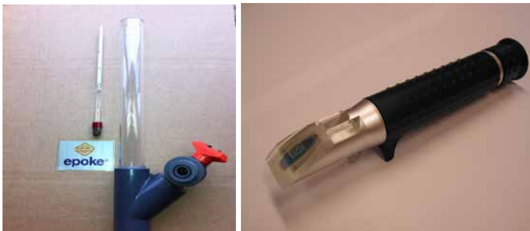
Figur 8-6 Eksempel på utstyr for måling av saltkonsentrasjon i løsnings.
