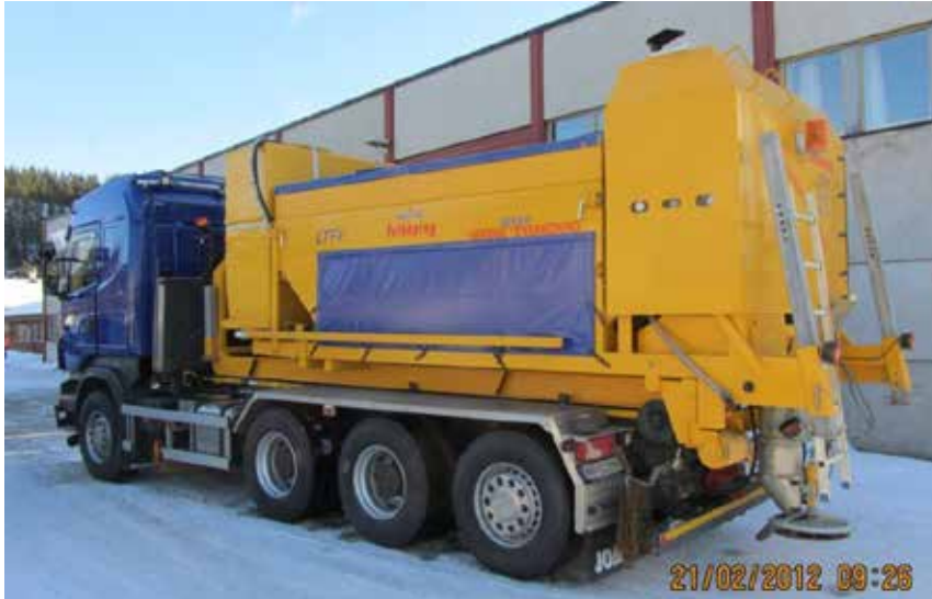
Figur 6-4 Fastsandspreder kan også brukes som saltspreder for befuktning med varmt eller kaldt vann. (Foto: Dagfin Gryteselv).
