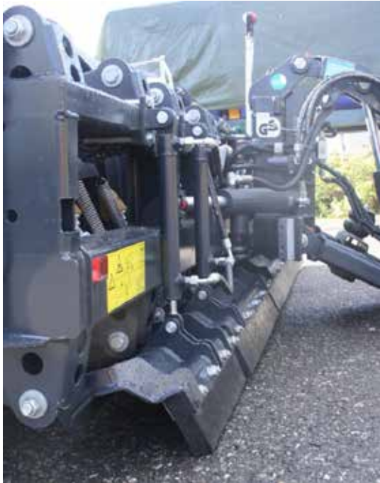
Figur 4-42 Gummiskjær/lameller montert bak på plog (Foto: Schmidt Norge AS)
