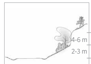
Ikke skjemmende ensidig fjellskjæring
