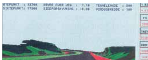
Perspektivtegning fra perspektivprogrammet Vips uten knekk i linjeføringen
