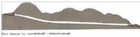
Forlengt tunnel uten lavbrekk mindre driftskostnad
