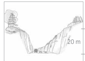
Skjemmende tosidig fjellskjæring
