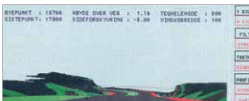
Perspektivtegning fra perspektivprogrammet Vips viser knekk i linjeføringen
