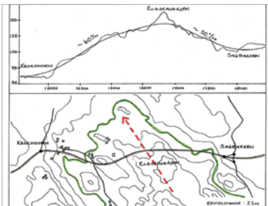
20m høy tosidig fjellskjæring, lette fyllmasser og 3 felt pga stigning
