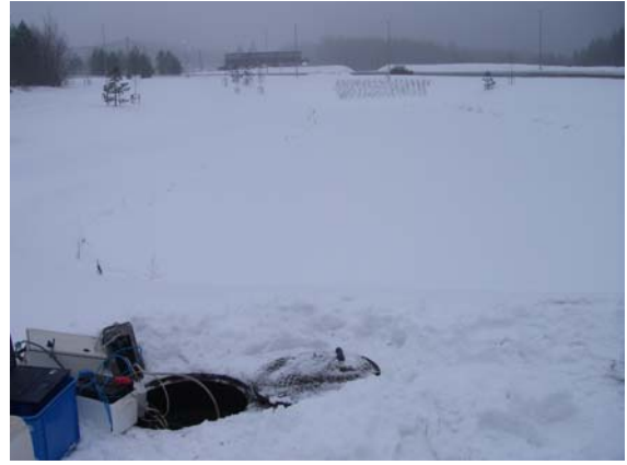
Figur 20. Rensedam ved Taraldrud langs E6 Oslo grense - Assurtjern med on-line måling ved innløp.
