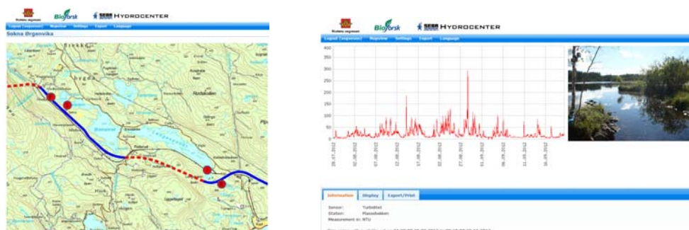
Figur 10. Passordbeskyttet nettside med klikkbare stasjoner og eksempel på presentasjon av data for turbiditet fra anleggsbelastet bekk ved rv. 7 Sokna - Ørgenvika.
