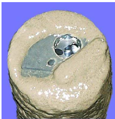
Figur 4. Turbiditetssensor full av slam der wiper likevel klarer å skape et grunnlag for måling (Foto: Terje Mile, Prosessteknikk AS). Viser også resultater før og etter renhold av skitten sensor.
