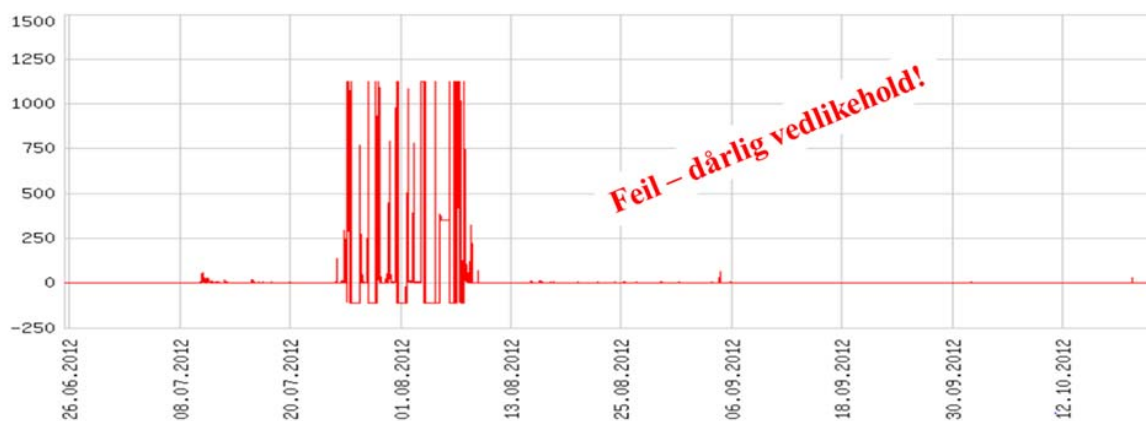
Figur 5. Feilmålinger for turbiditet fra miljøbøye i Krøderen som følge av manglende kontroll av resultater gjennom sommerferien 2012.
