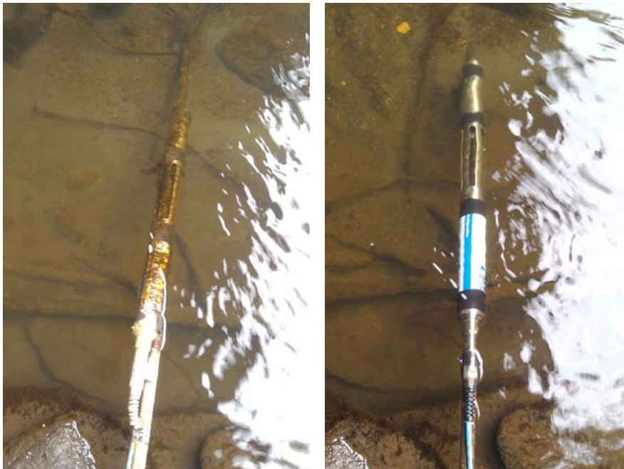
Figur 3. MPS fra Vigga før og etter vedlikehold 16.07.13
