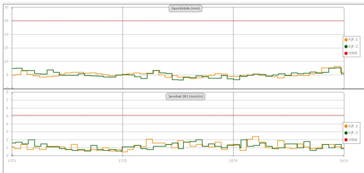
Figur 8. Spor- og jevnhetsmåling 2013, F2 (grønn) er LTA.
