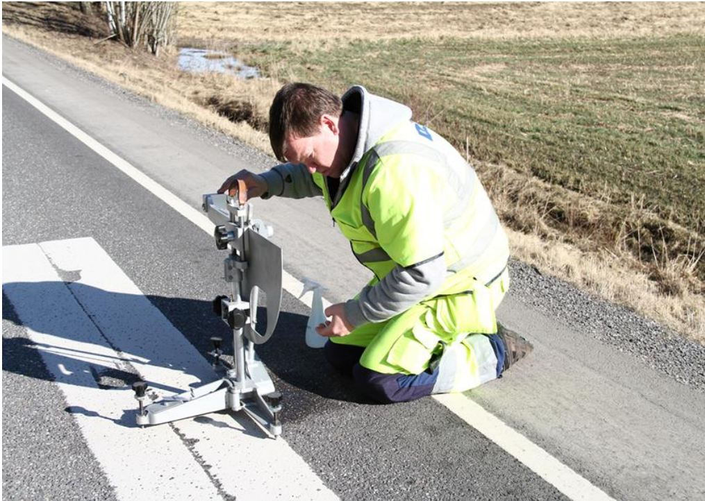
Friksjonsmåling på asfaltdekket.
