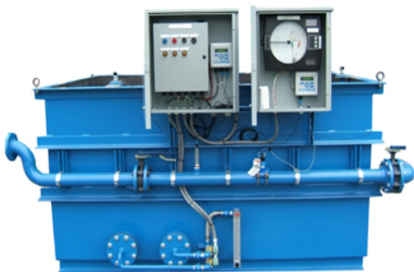
Figur 6: Eksempel på ferdig anlegg hvor pH til prosessvannet kan reguleres med CO 2 (Digital Analysis Corporation 2013).
